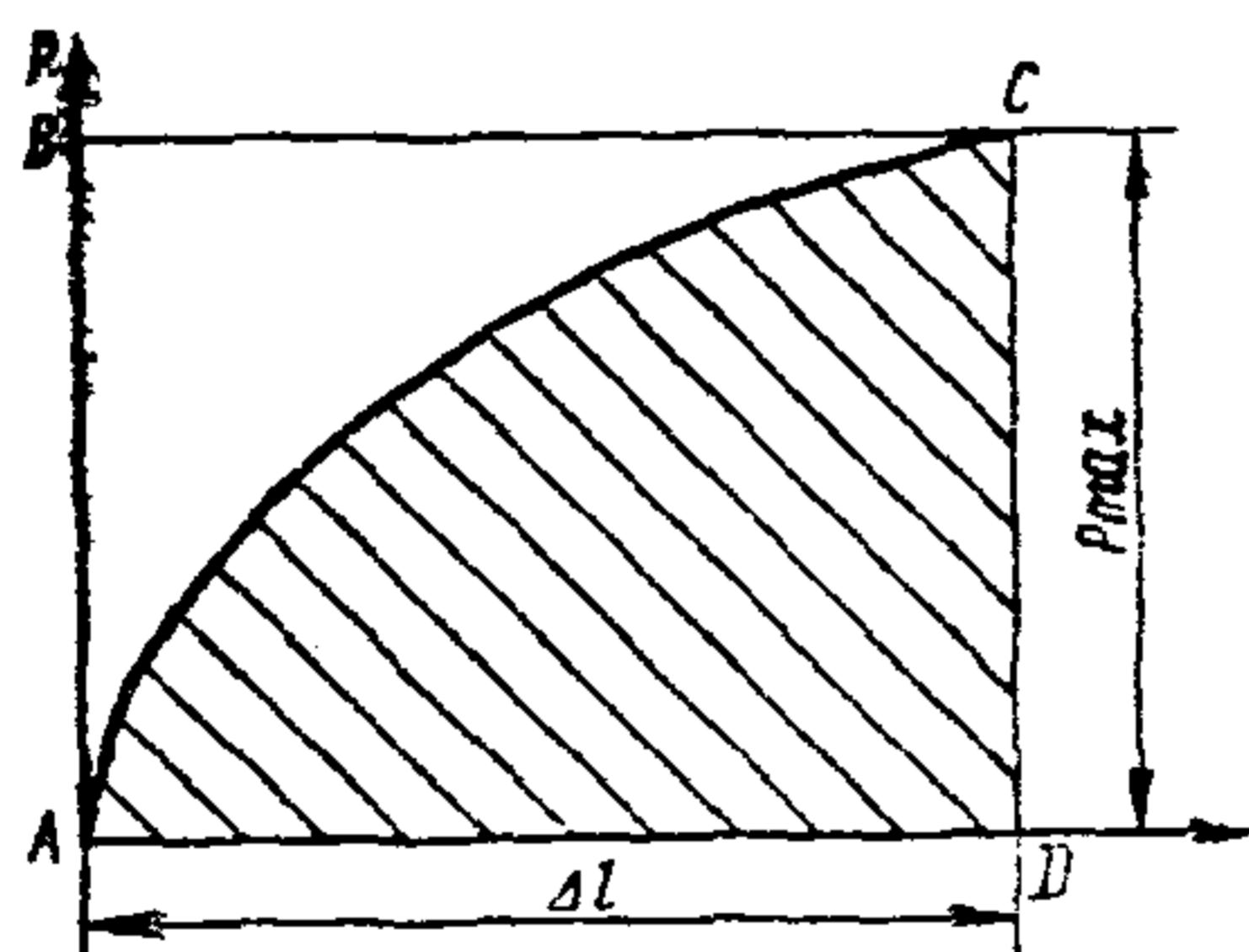
Площадь  $ACDA$  вычерчивается с помощью самонивелирующихся приборов и измеряется планиметром.
