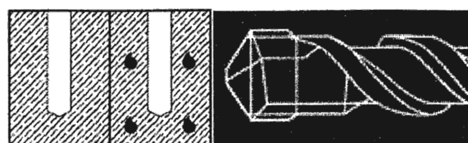
Ручную очистку отверстий допускается производить при диаметре отверстия  $\leq 20\text{мм}$  и глубине отверстия  $< 250\text{мм}$ .
