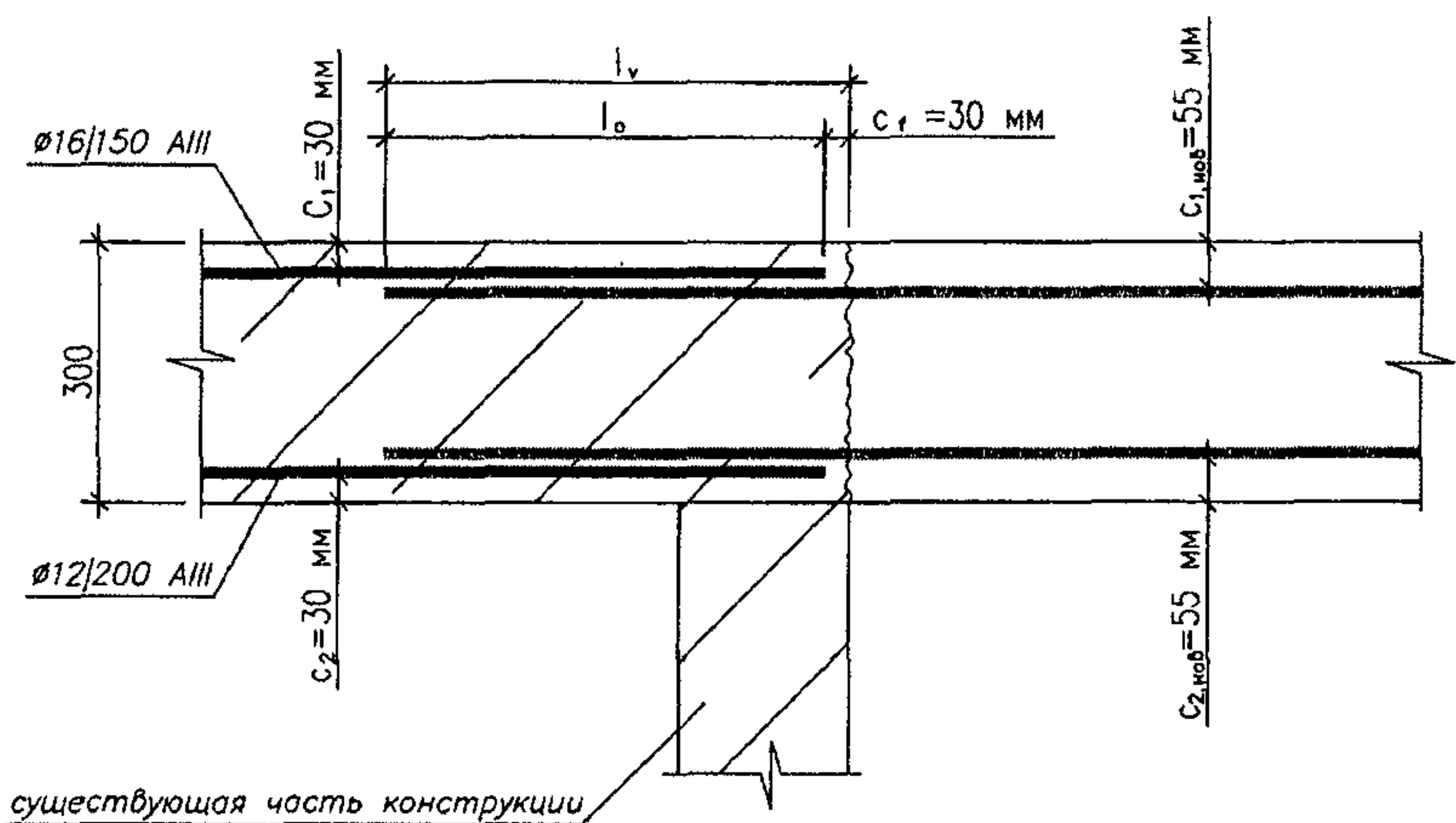
**Определение длины перехлеста для вклеиваемой арматуры:**
