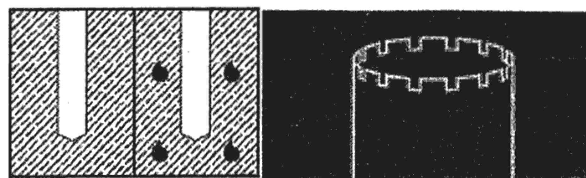
Ручную очистку отверстий допускается производить при диаметре отверстия  $\leq 20\text{мм}$  и глубине отверстия  $\leq 250\text{мм}$ .
