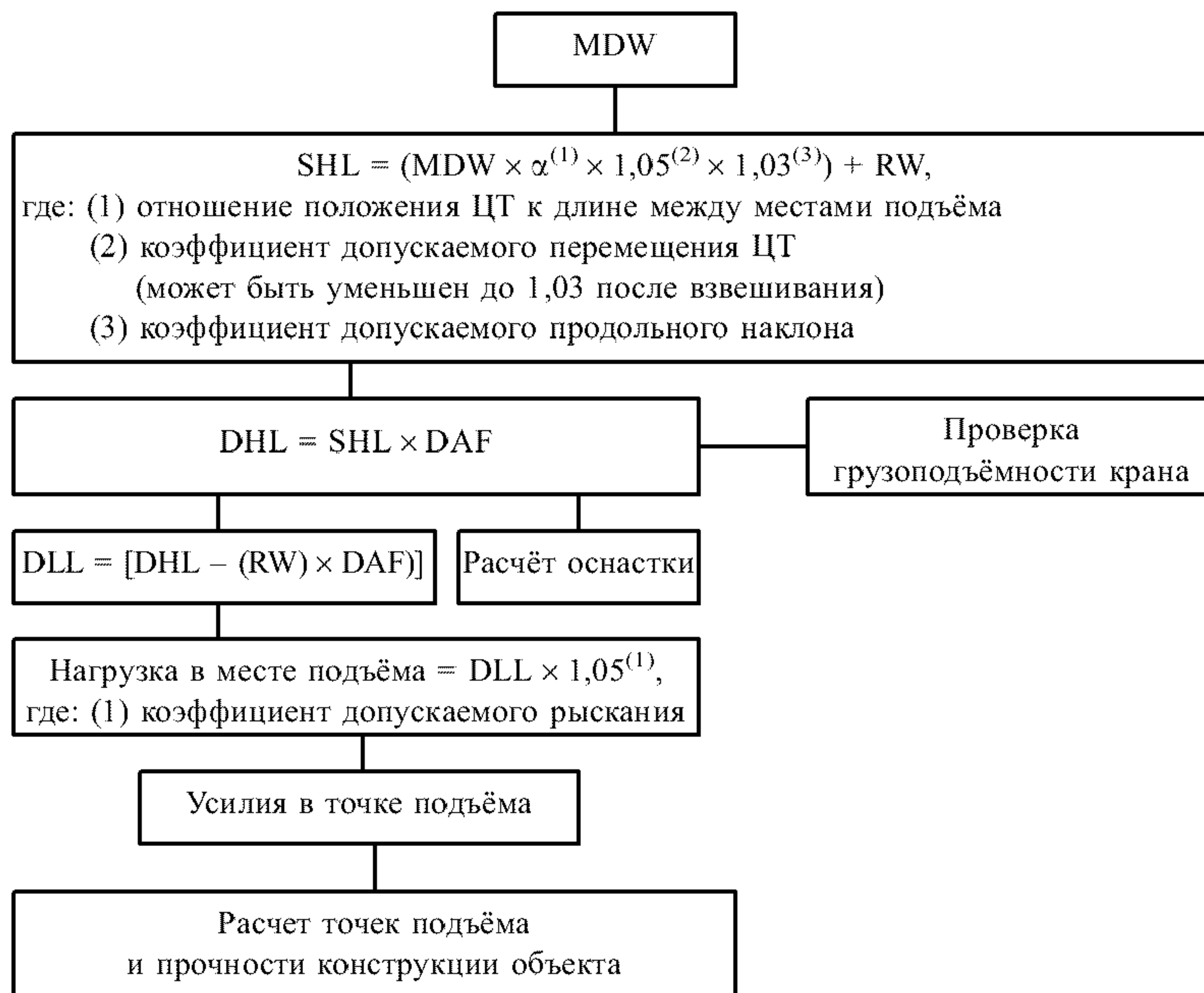
Рис. 3.2 Стадии расчета подъема объекта с использованием двух кранов
