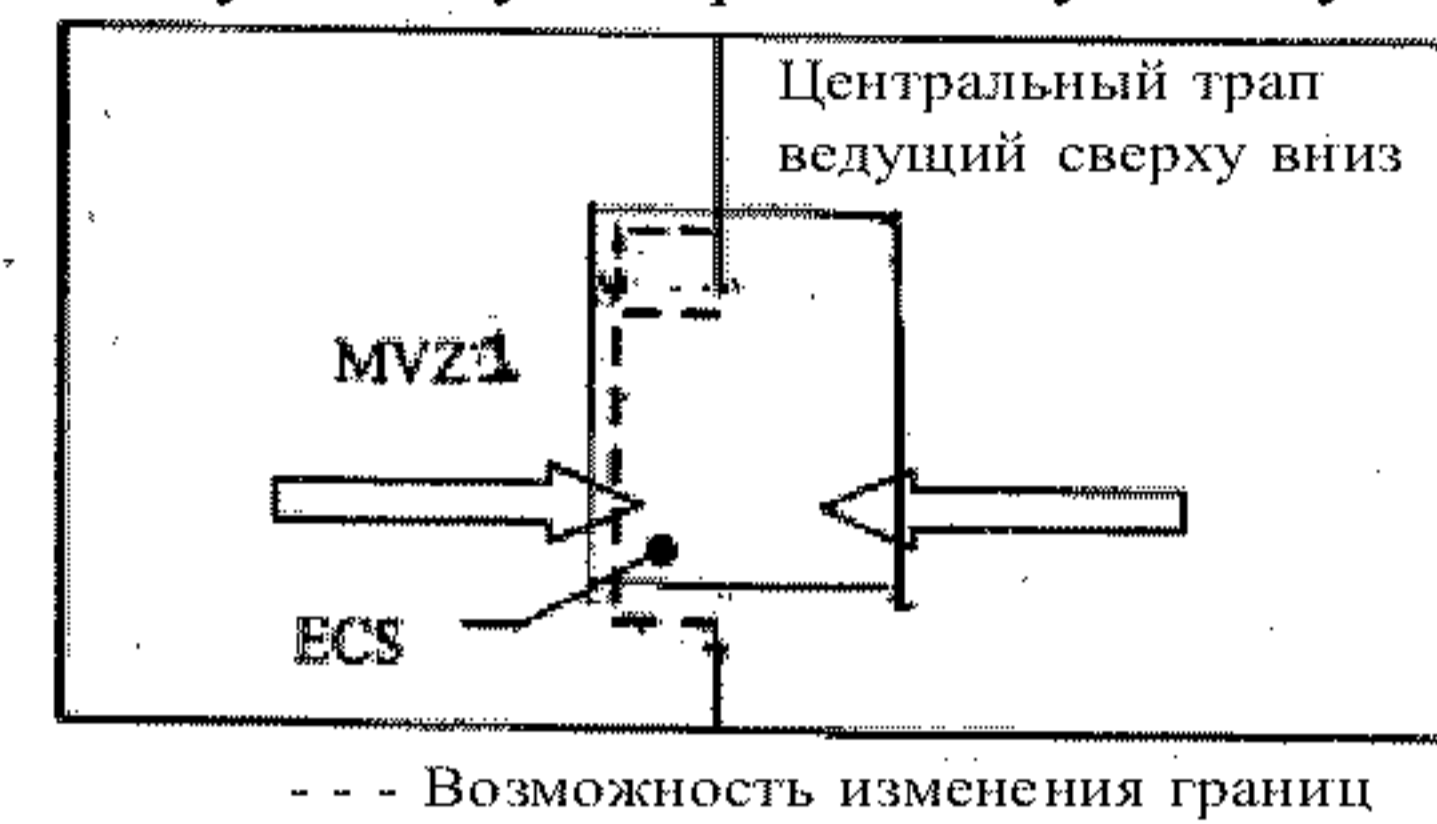
Вариант 1: Эвакуационный трап принадлежит главной вертикальной зоне 1
