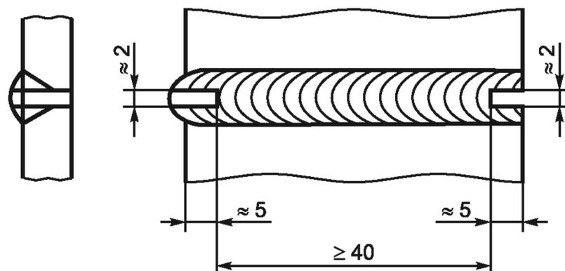
b) Зона контроля контрольного образца (дополнительно в центре шва со стороны растяжения можно выполнить продольный надрез, чтобы добиться излома в шве образца для испытаний)
