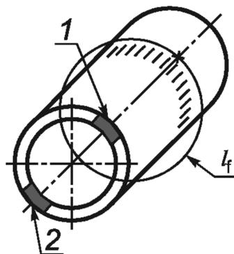
$l_f$  — длина зоны контроля; 1 — место вырезки образца для испытания на излом со стороны корня шва, или на изгиб с растяжением в корне шва, или на изгиб образца из поперечного сечения шва; 2 — место вырезки образца для испытания на излом лицевой стороны шва, или на изгиб с растяжением в лицевой части шва, или на изгиб образца из поперечного сечения шва
