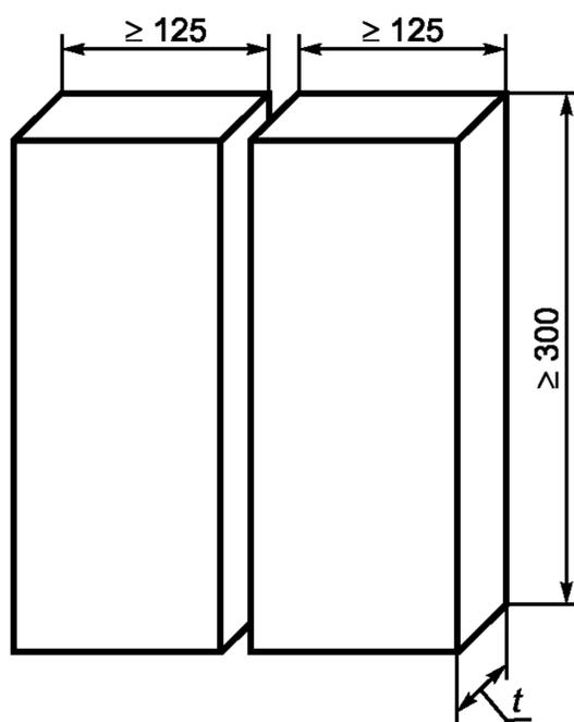
$t$  — толщина материала контрольного сварного соединения, мм
