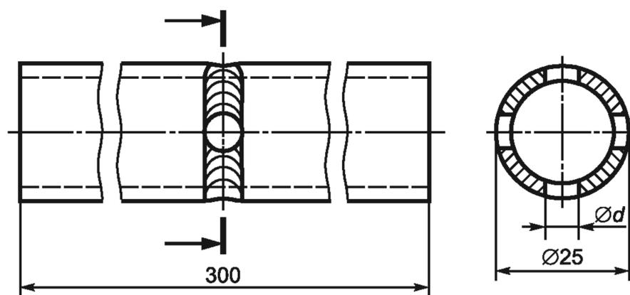
При  $t \geq 1,8$  мм  $d = 4,5$  мм; при  $t < 1,8$  мм  $d = 3,5$  мм
