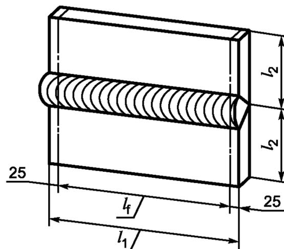
$l_1$  — длина контрольного сварного соединения, мм;  $l_2$  — полуширина контрольного сварного соединения, мм;
