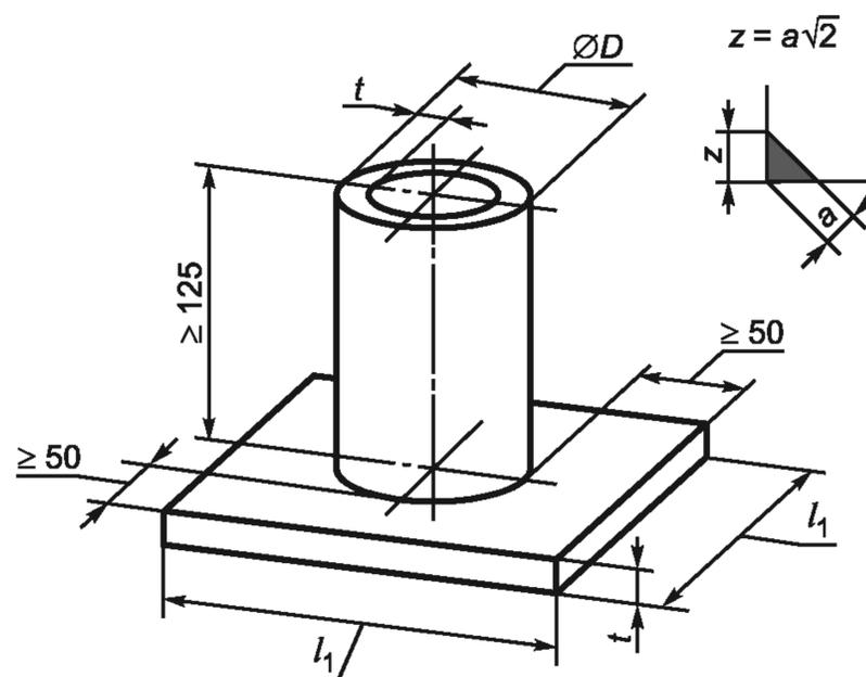
$a$  — номинальная толщина шва;  $D$  — наружный диаметр трубы;  $l_1$  — длина контрольного сварного соединения;  $t$  — толщина пластины или стенки трубы контрольного сварного соединения;  $z$  — величина катета углового шва
