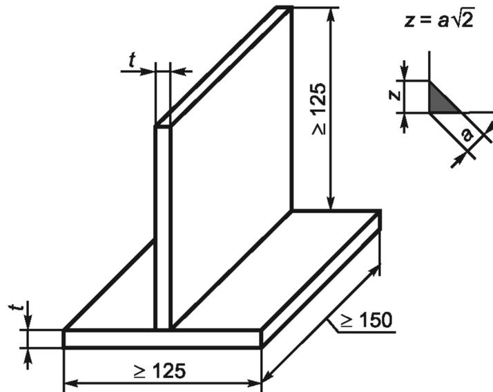
$a$  — номинальная толщина шва, мм;  $t$  — толщина материала контрольного сварного соединения, мм;
