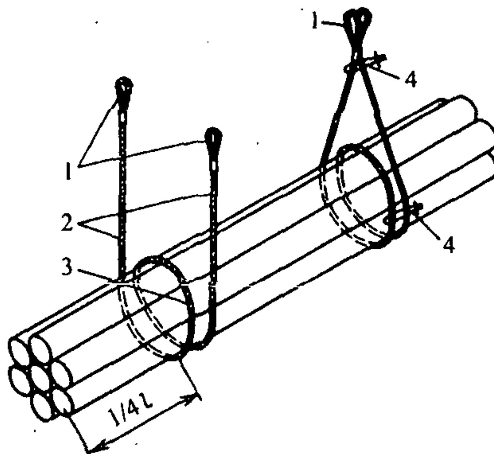
Рис. 2.1.2. Схема формирования УГМ труб малого диаметра в инвентарных стропах способом двойного охвата:
