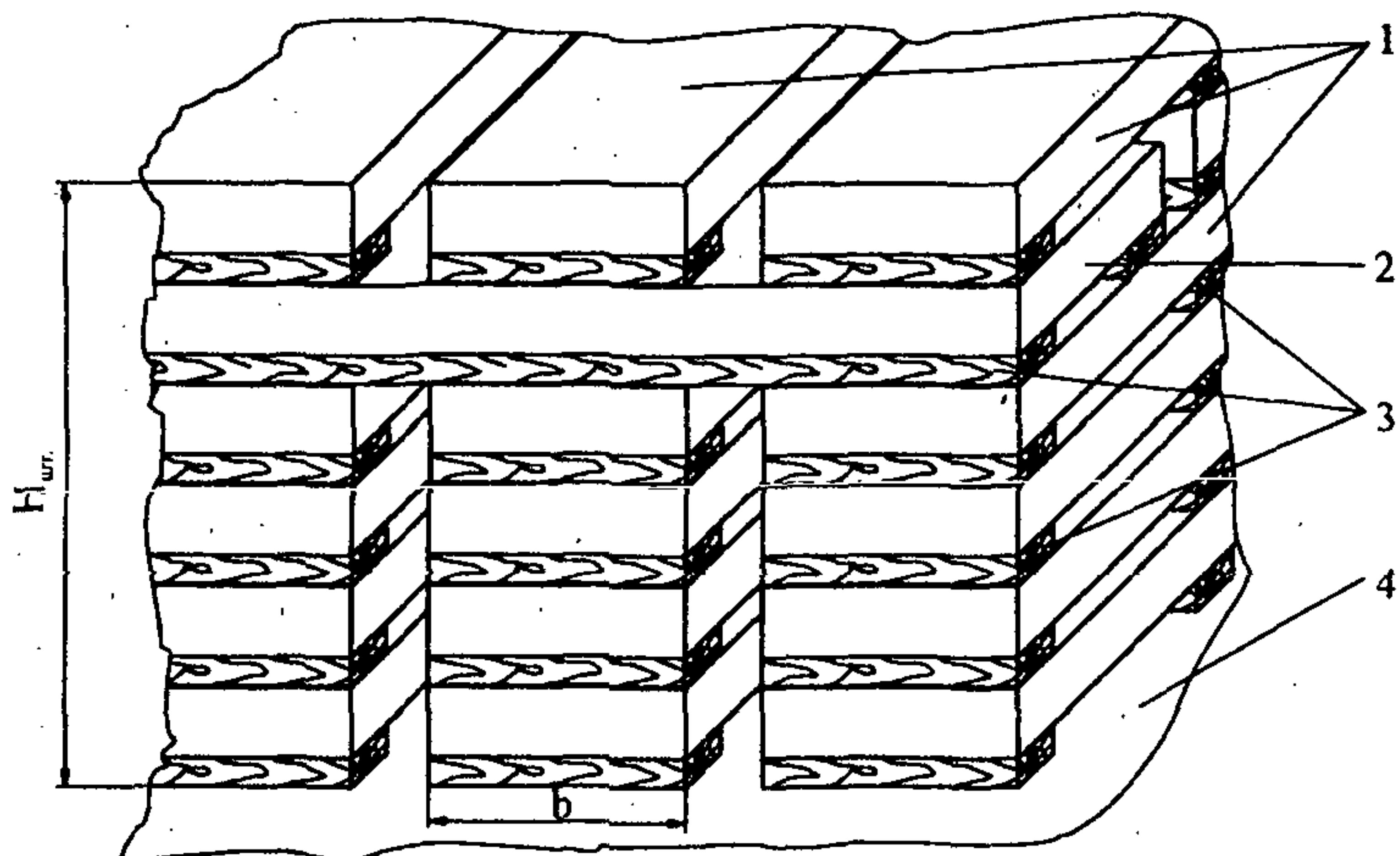
**Рис. 2.11.2. Схема укладки слитков прямоугольного сечения и слябов:**
