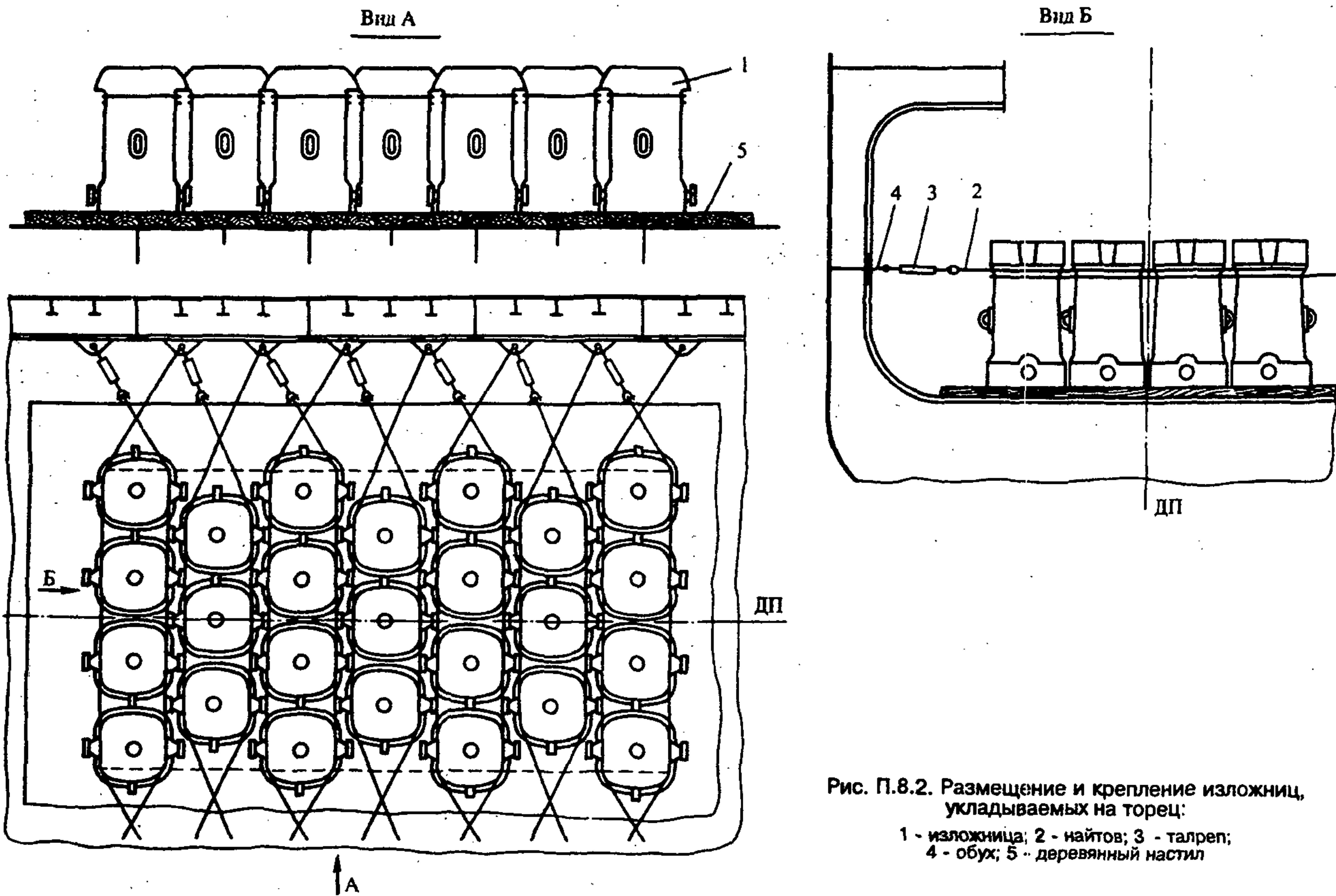
Рис. П.8.2. Размещение и крепление изложниц, укладываемых на торец:
