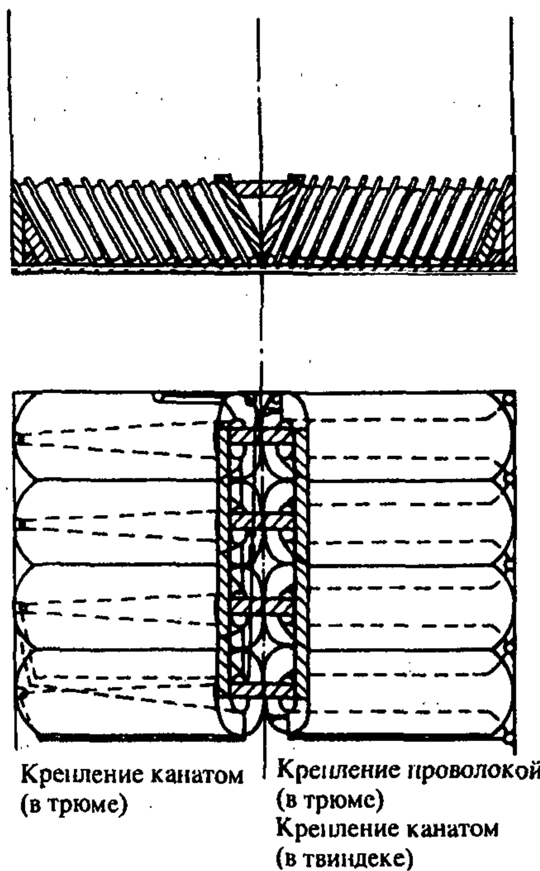
Рис. 2.17.1. Размещение и крепление бандажей (колес)
