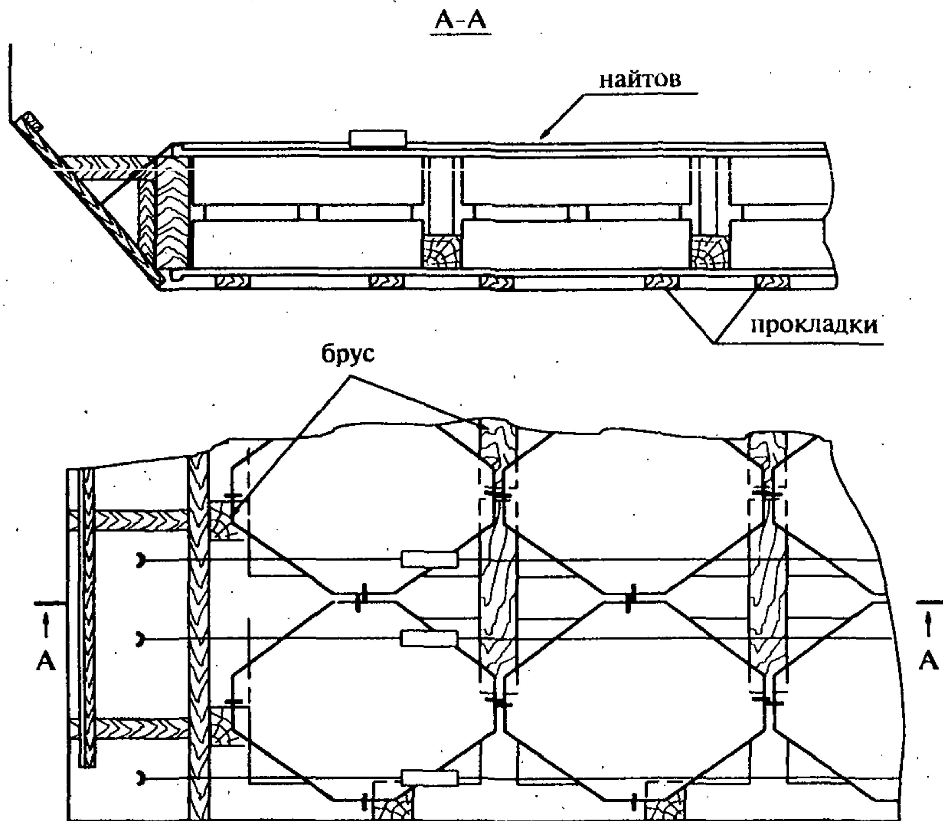
**Рис. П.12.1. Крепление пакетов с ромбовидной формой верхнего
