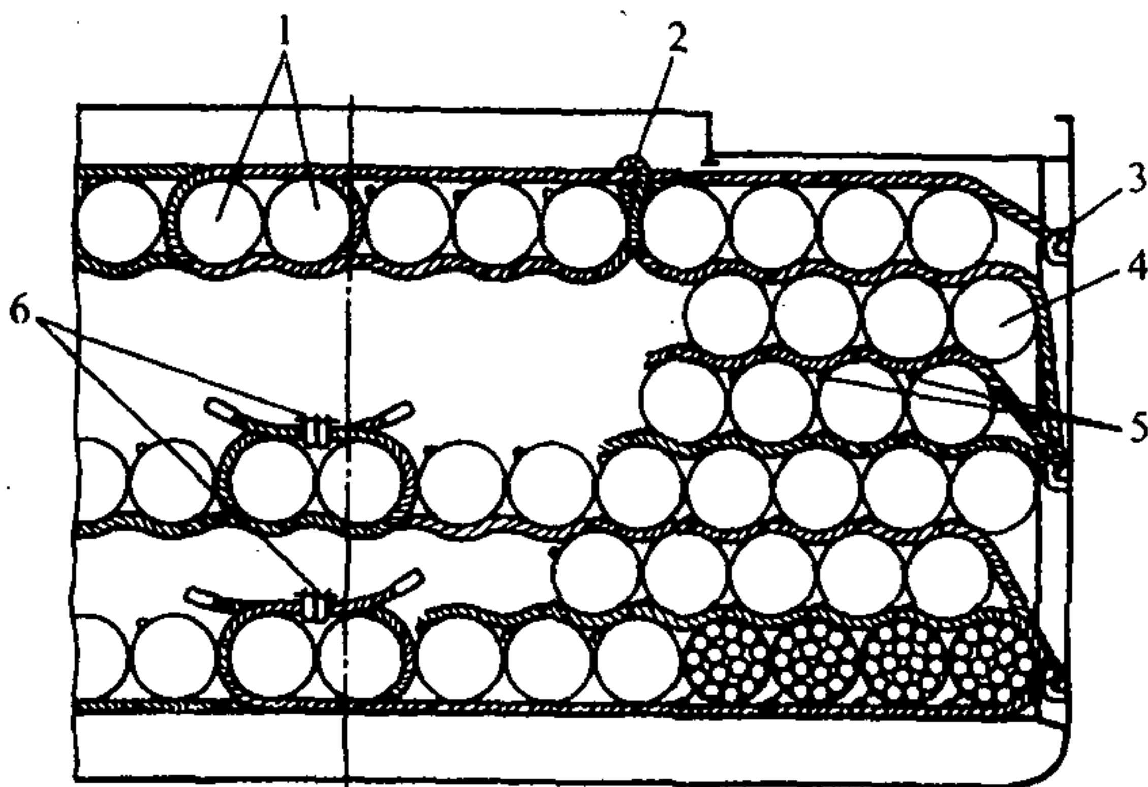
Рис. 2.1.3. Укладка и крепление УГМ с трубами малого диаметра с применением штивующих стропов:
