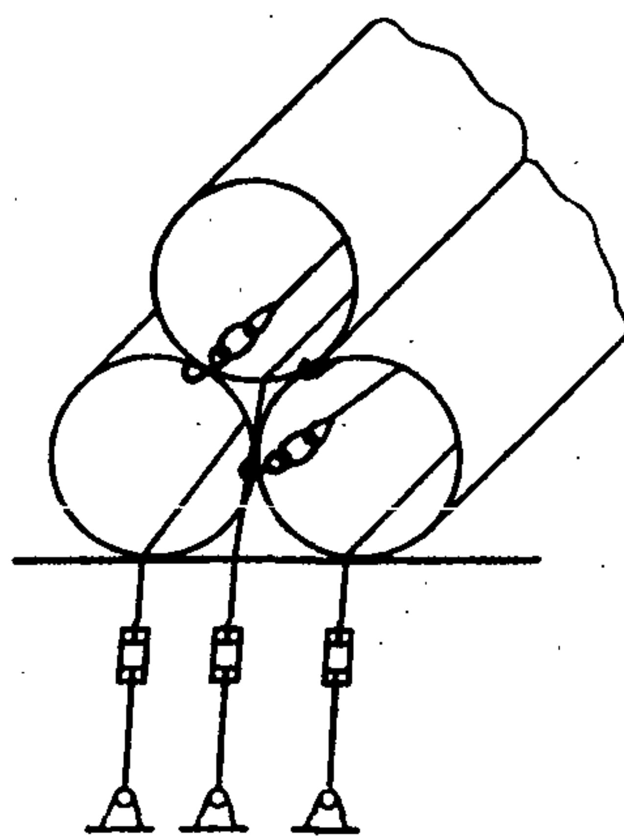
Рис. 2.2.4. Индивидуальное крепление поперечных труб
