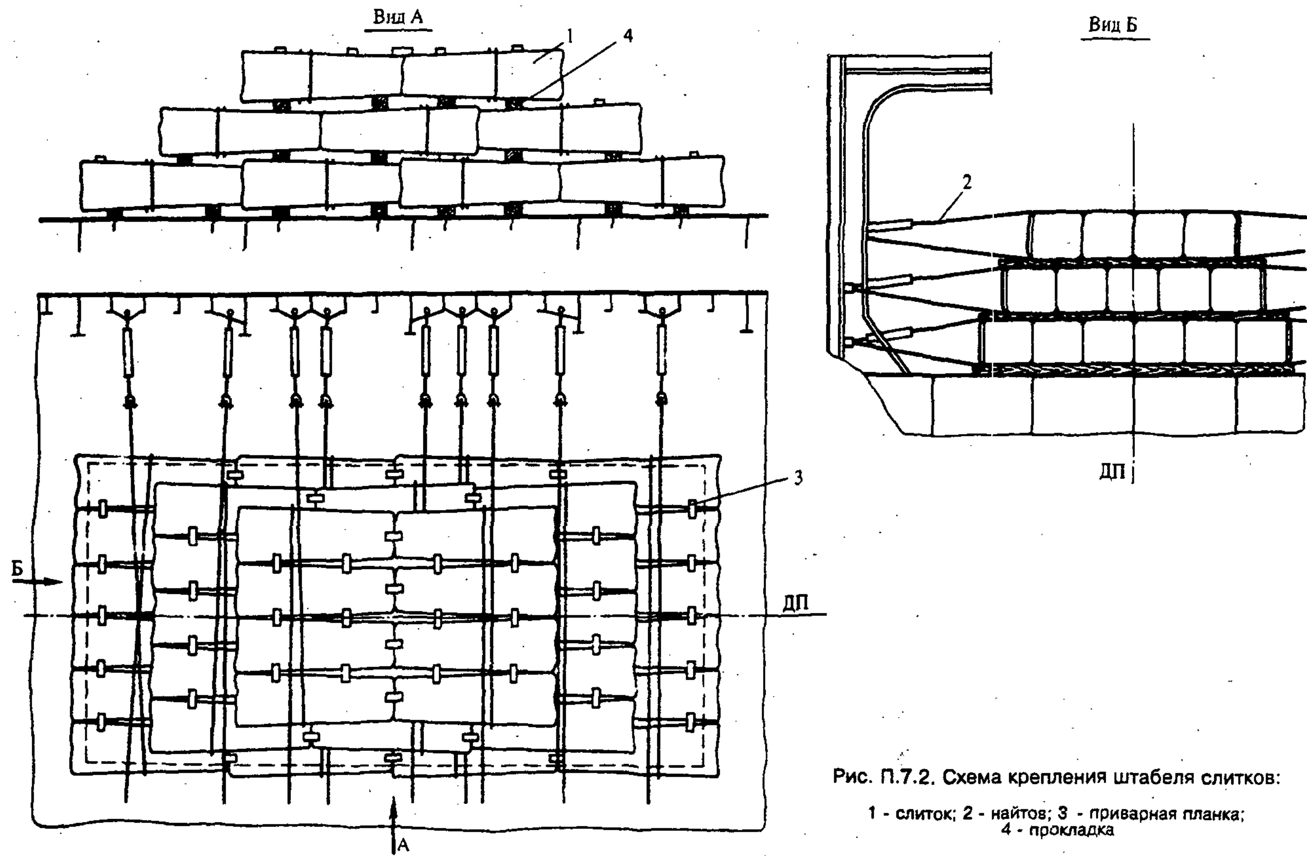
Рис. П.7.2. Схема крепления штабеля слитков:
