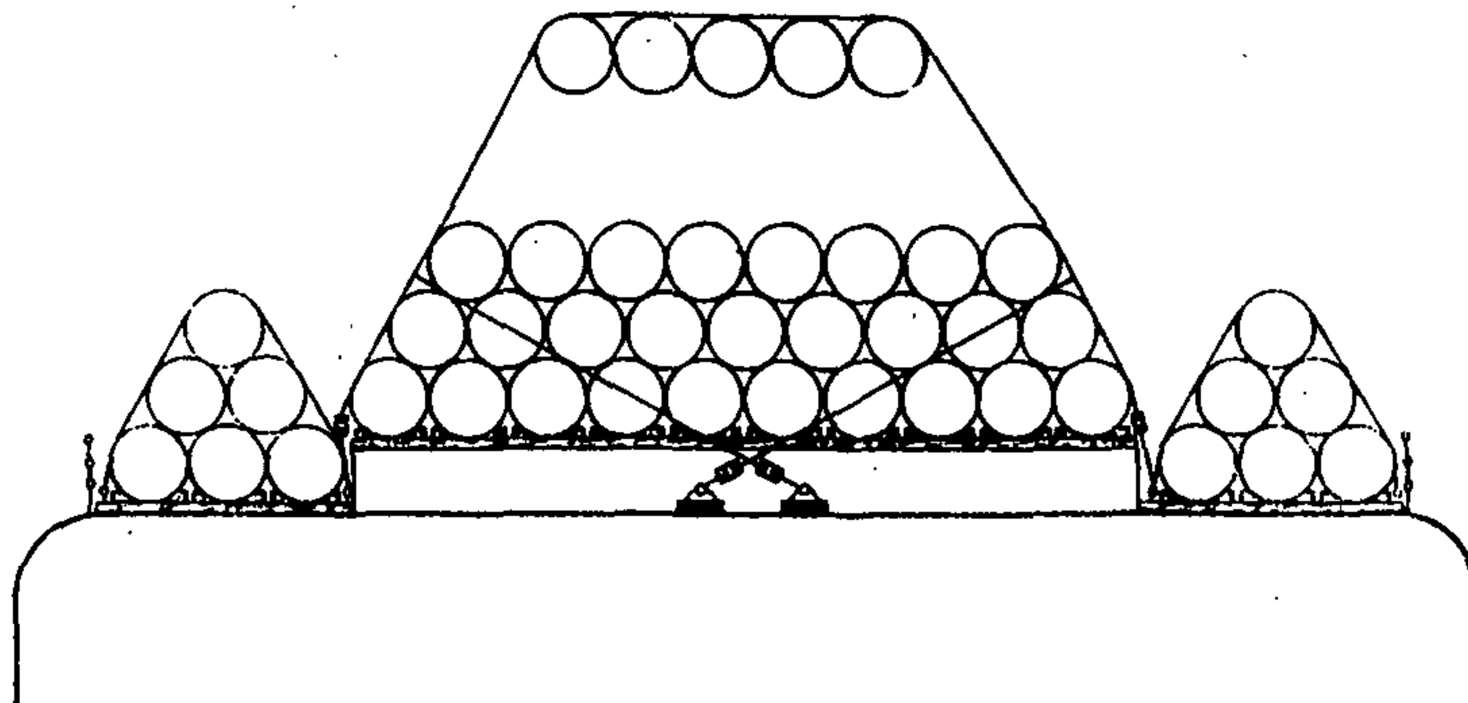
Рис. 2.2.1. Укладка труб отдельными штабелями
