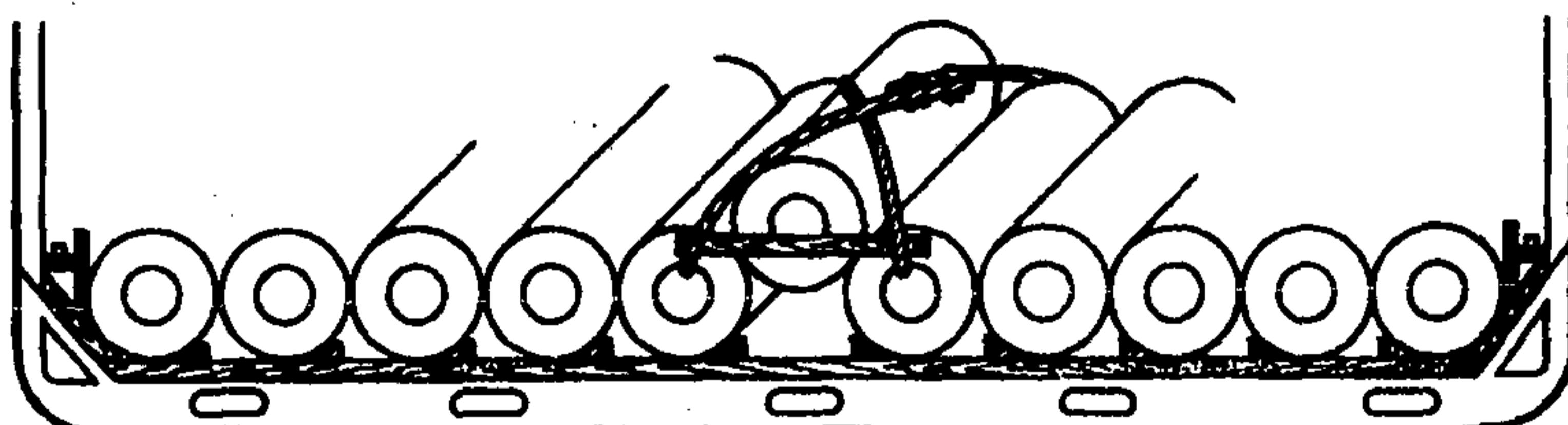
Рис. 2.4.2. Укладка рулона в один ярус и их крепление
