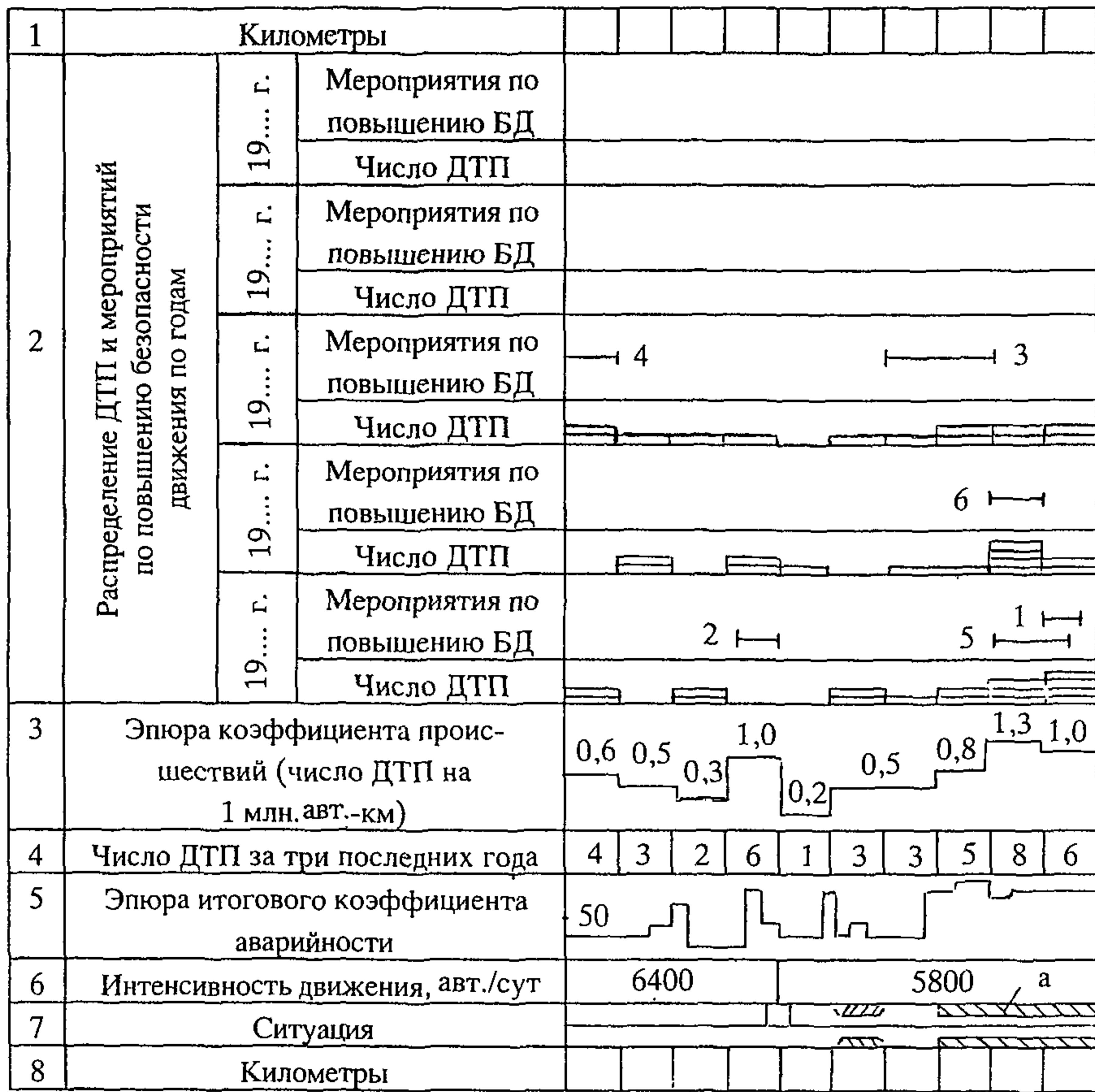
**Примечание.** В графах “Мероприятия по повышению БД” цифрами обозначены: 1 - строительство тротуаров; 2 - увеличение радиуса кривой в плане; 3 - разметка проезжей части; 4 - укрепление обочин; 5 - устройство шероховатой поверхности обработки; 6 - укрепление кромки проезжей части; а - населенный пункт.
