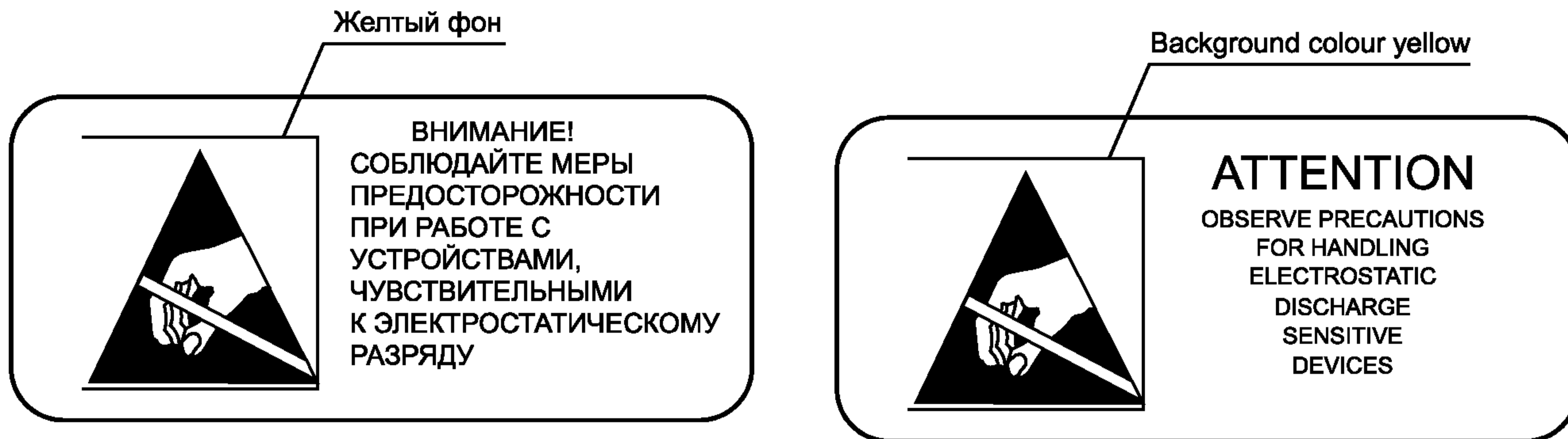
Рисунок 13 — Пример маркировки чувствительных к электростатическому разряду устройств
