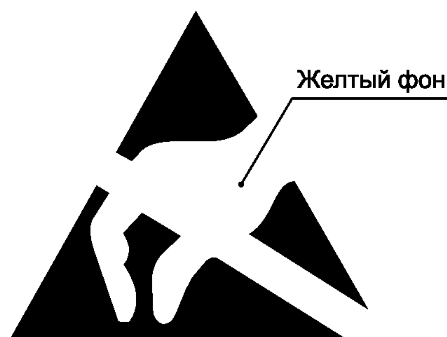
Рисунок 12 — Чувствительная к электростатическому разряду деталь или узел
