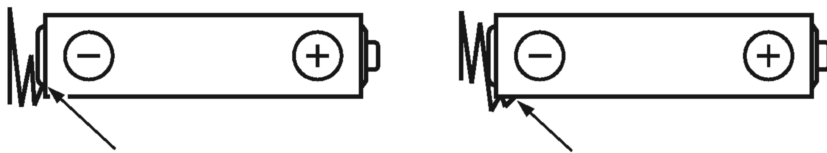
Рисунок В.10а – Пружина проскальзывает снизу оболочки – возможен контакт с металлом
