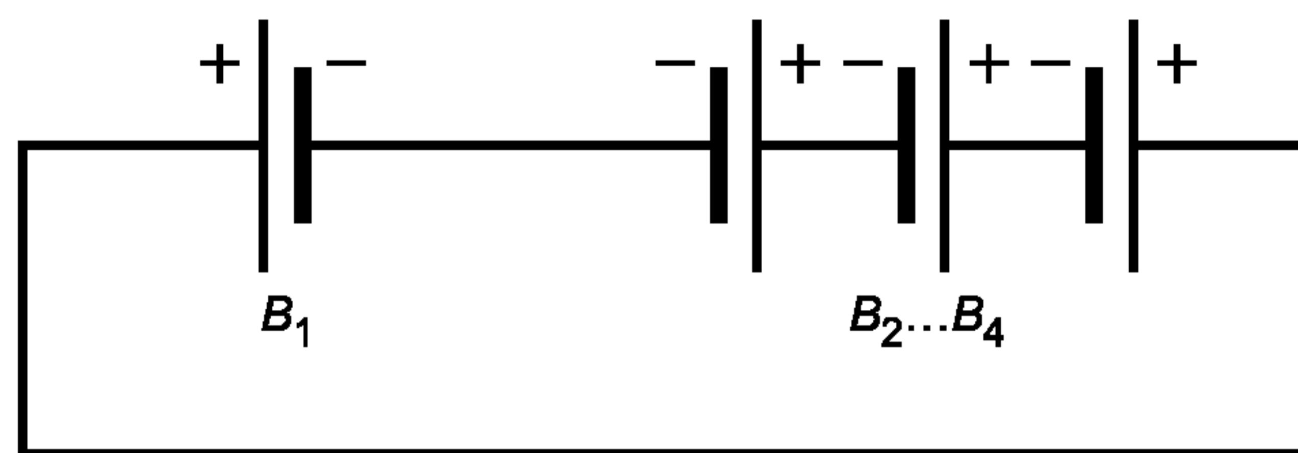
$B_1$  — испытуемый элемент;  $B_2 \dots B_4$  — аналогичные неразряженные элементы
