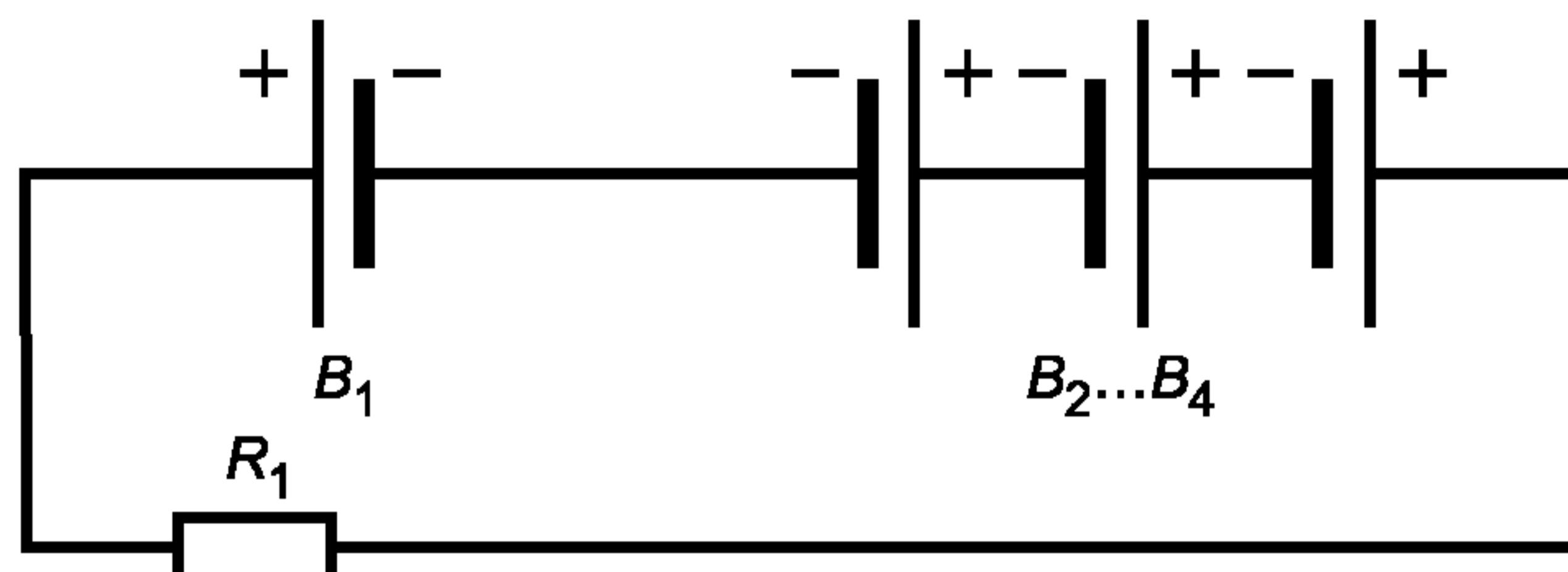
$B_1$  — испытуемая батарея с 50 %-ной степенью разряженности (для повторного испытания с 75 %-ной степенью разряженности);
