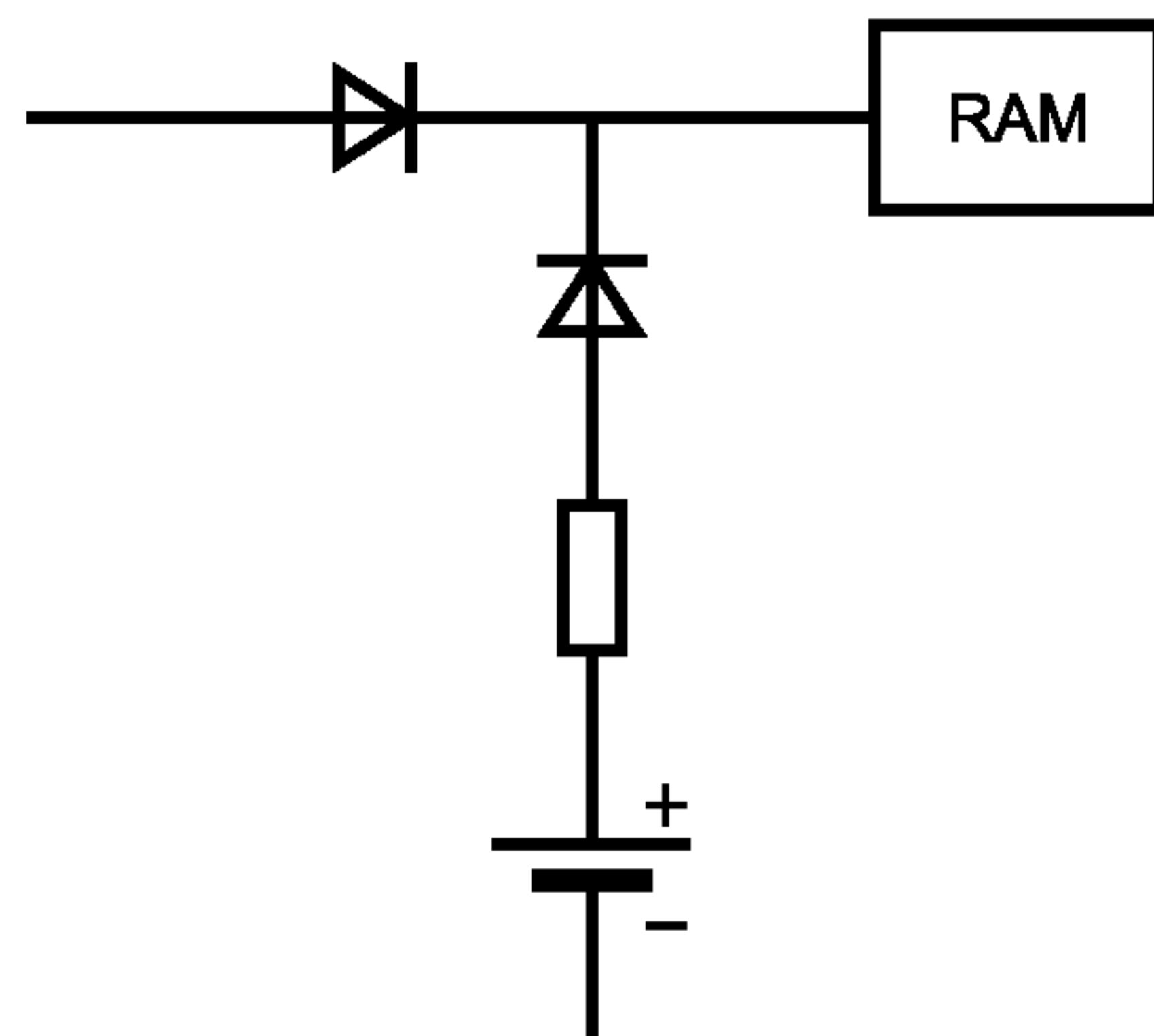
Рисунок 6 — Схема соединений для обеспечения защиты от заряда
