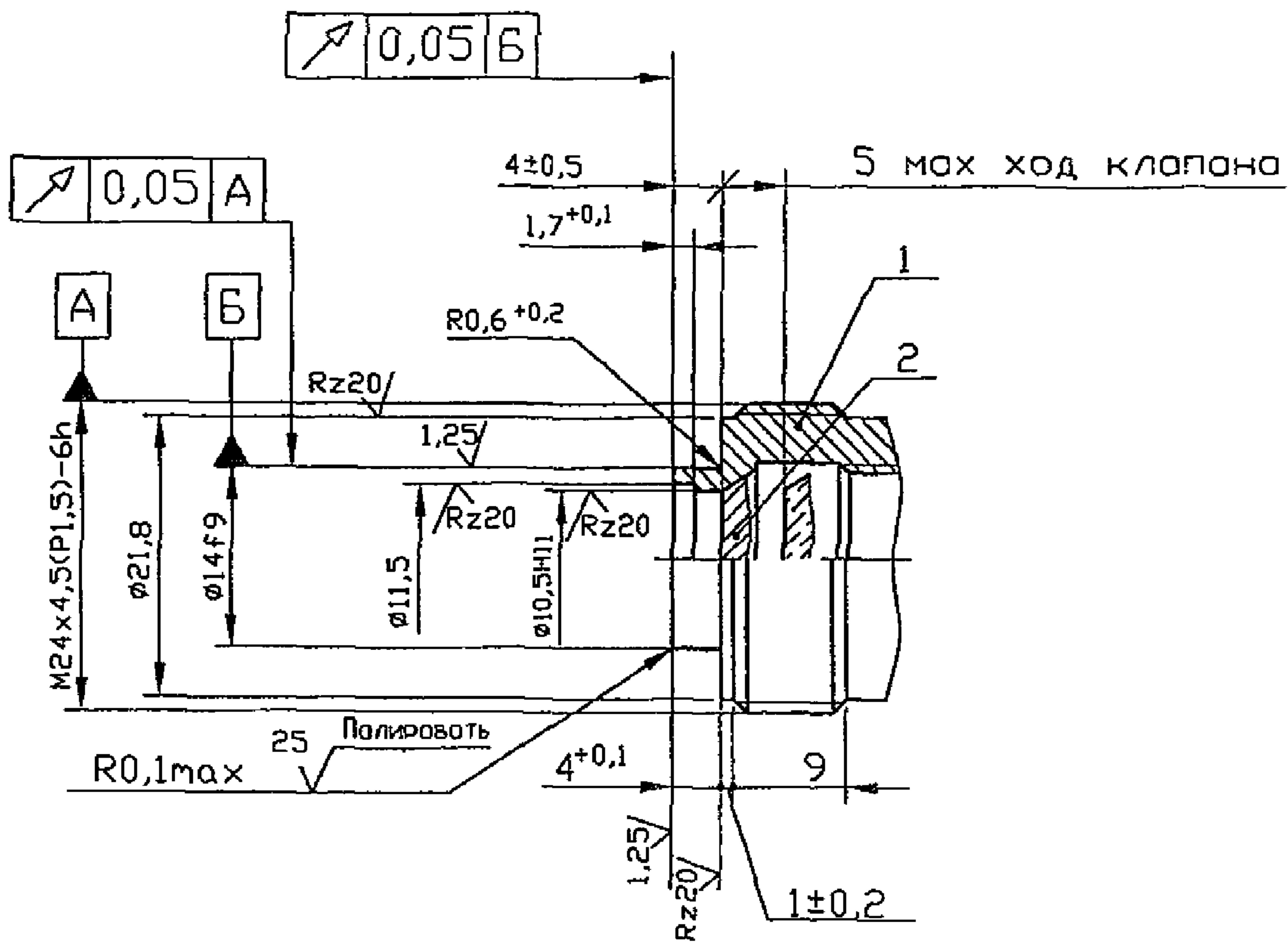
1 – корпус бортового клапана; 2 - клапан
