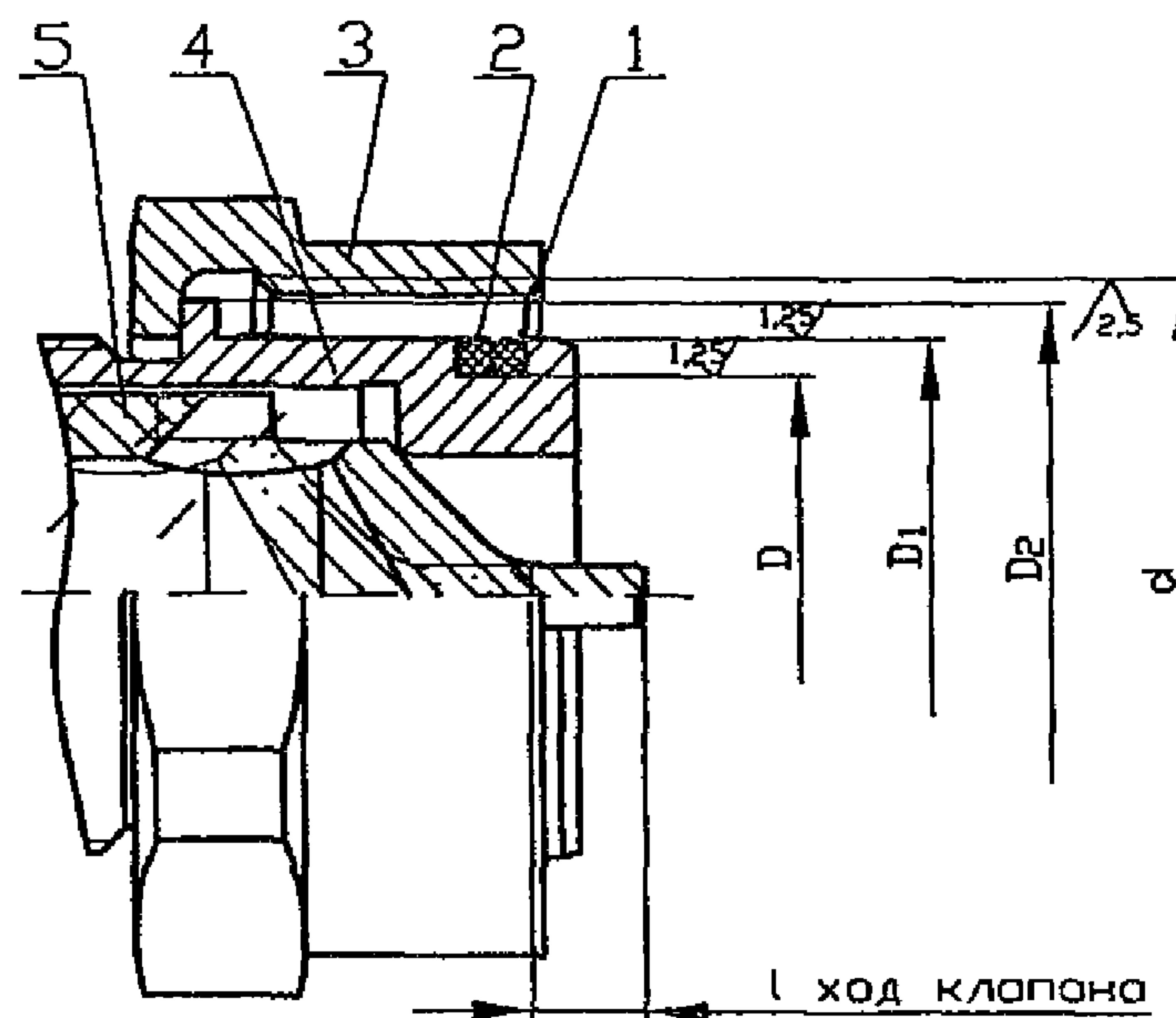
1 - кольцо уплотнительное, 2 - шайба защитная, 3 - гайка; 4 - гильза, 5 - клапан
