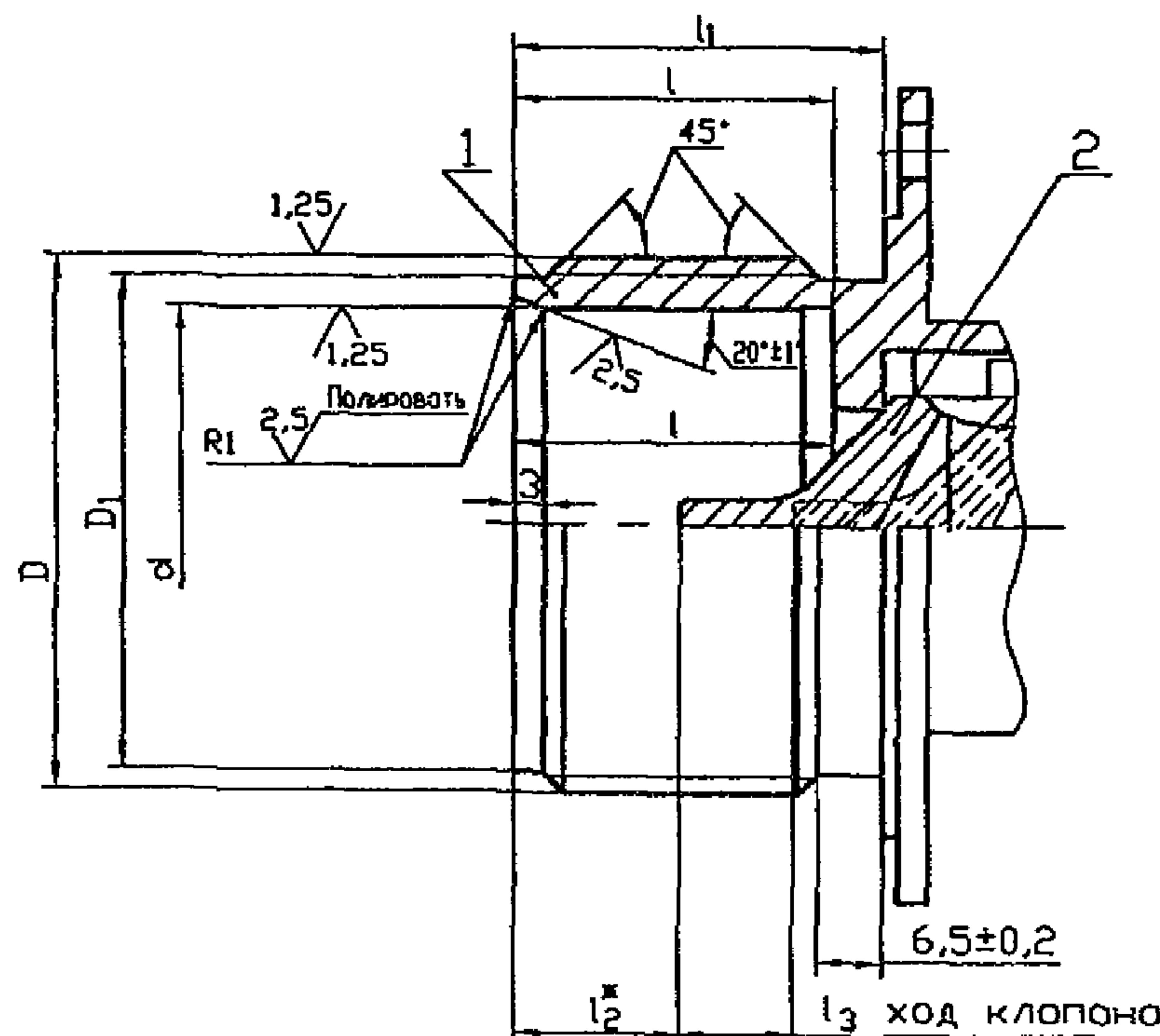
1 – корпус бортового клапана; 2 - клапан
