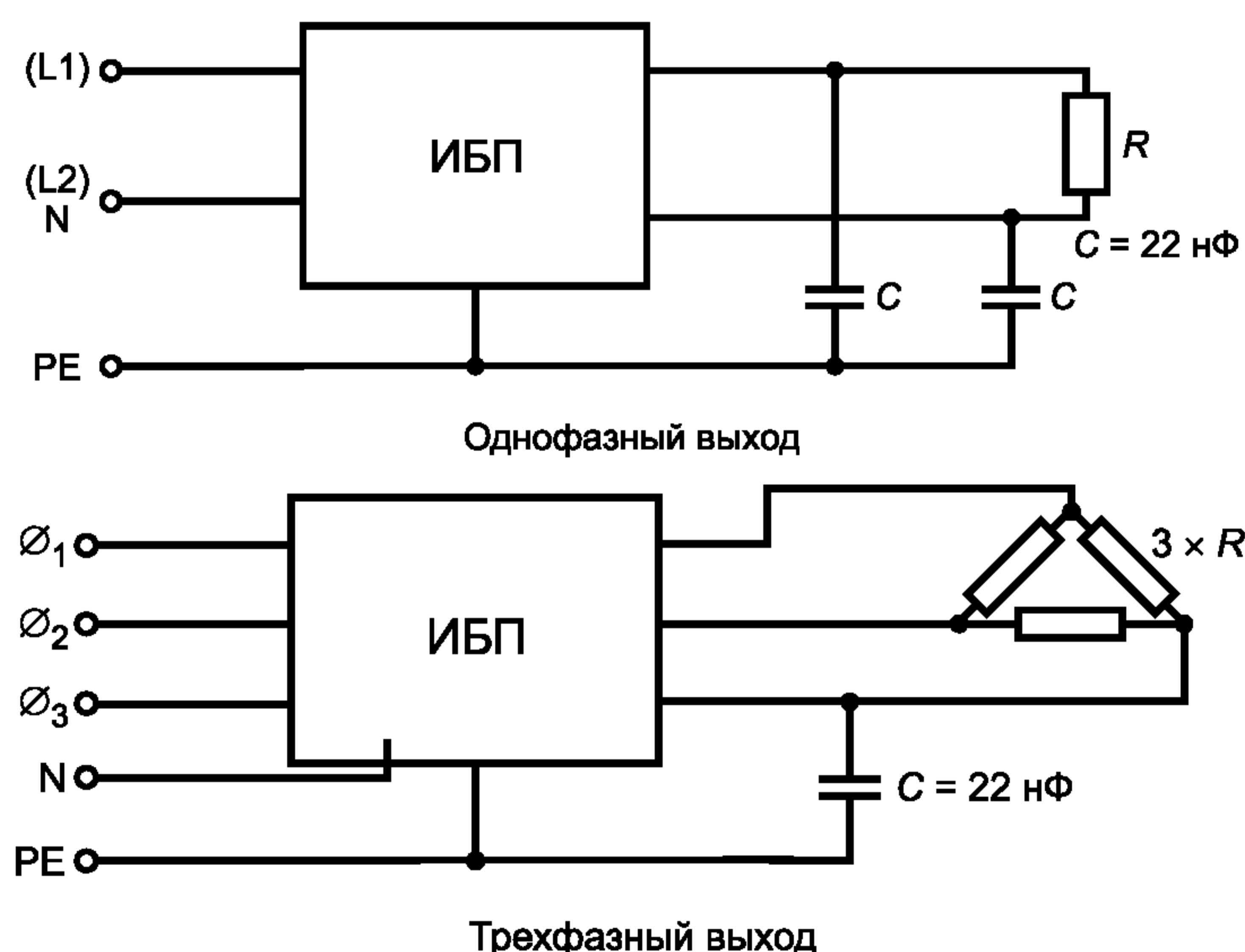
Рисунок L.1 — Схема подключения испытуемого ИБП
