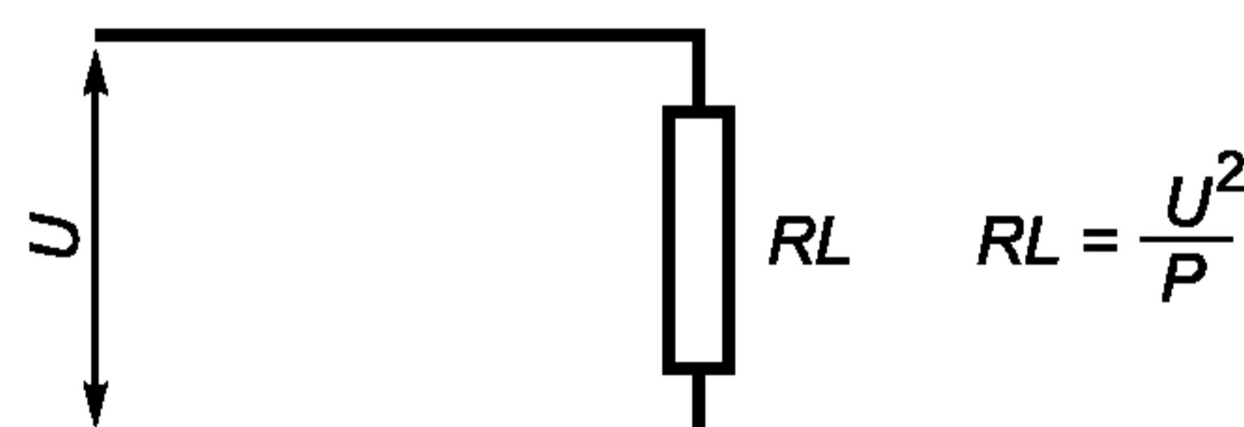
Рисунок М.1 — Эталонная активная нагрузка
