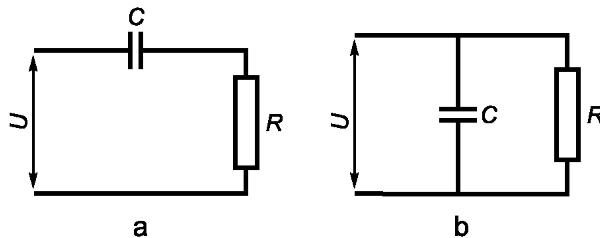
Рисунок M.3 — Эталонная активно-емкостная нагрузка:
