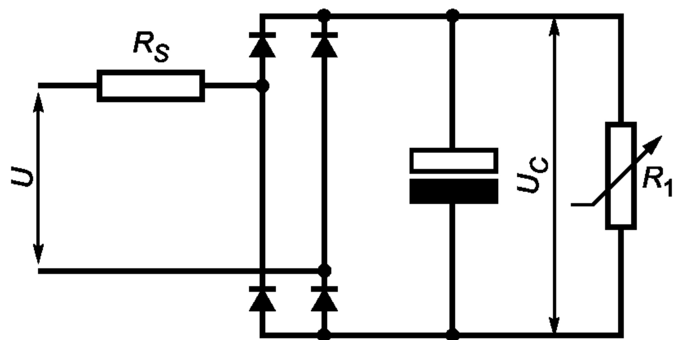
Рисунок M.4 — Эталонная нелинейная нагрузка
