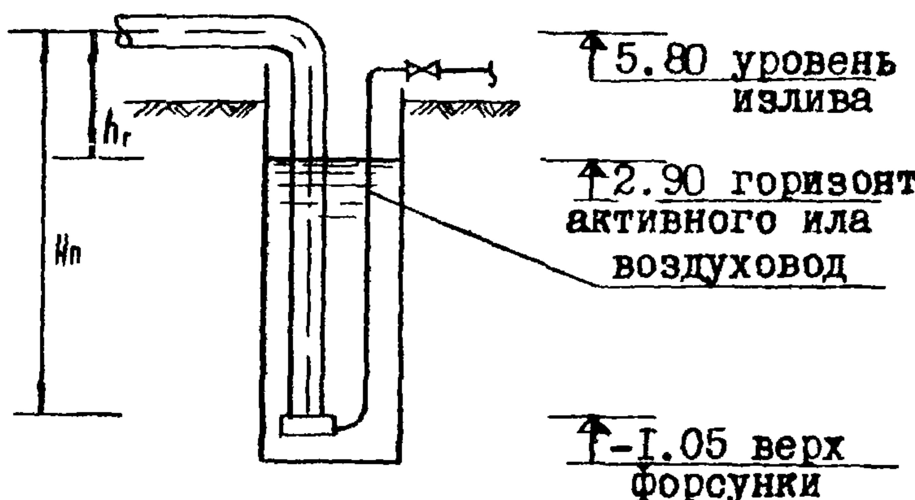
Расчетный расход циркулирующего активного ила (количество ила от двух вторичных отстойников диаметром 30 м)
