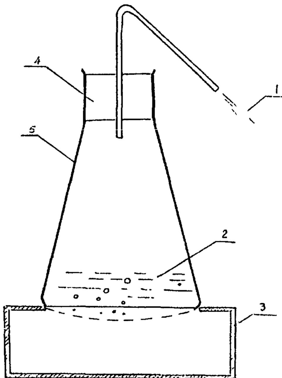
**Рис. 7.** Получение паров ацетона для просветления фильтров
