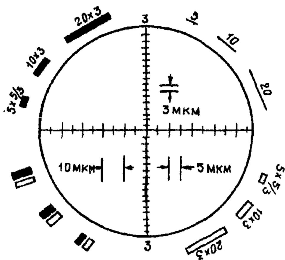
Рис. 2. Окулярный измеритель Валтона-Бекетта.
