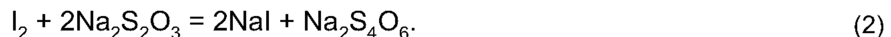
Разница между холостым титрованием и титрованием образца дает количество йода, вступившего в реакцию, и, следовательно, количество сульфида натрия.
