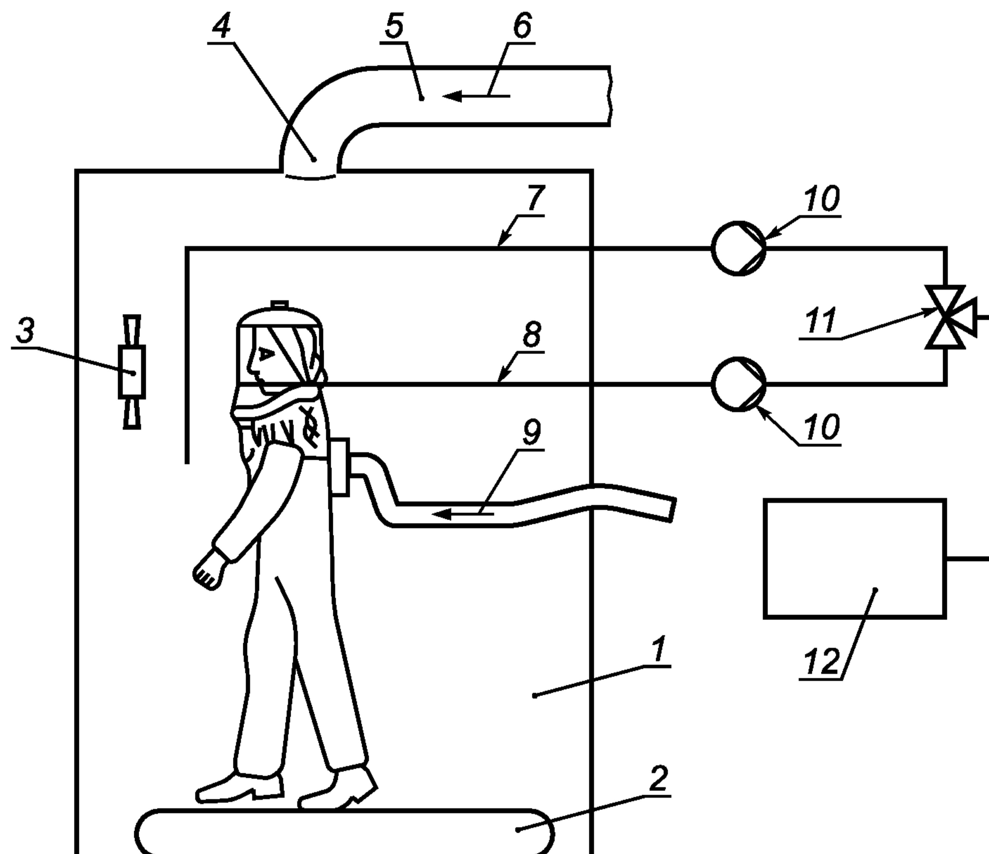
1 — камера; 2 — бегущая дорожка; 3 — вентилятор (если требуется); 4 — заслонка; 5 — труба; 6 — воздух + SF<sub>6</sub>; 7 — пробоотборник в камере; 8 — пробоотборник в дыхательной зоне; 9 — воздух для дыхания; 10 — насос для пробы; 11 — переключающий клапан; 12 — анализатор
