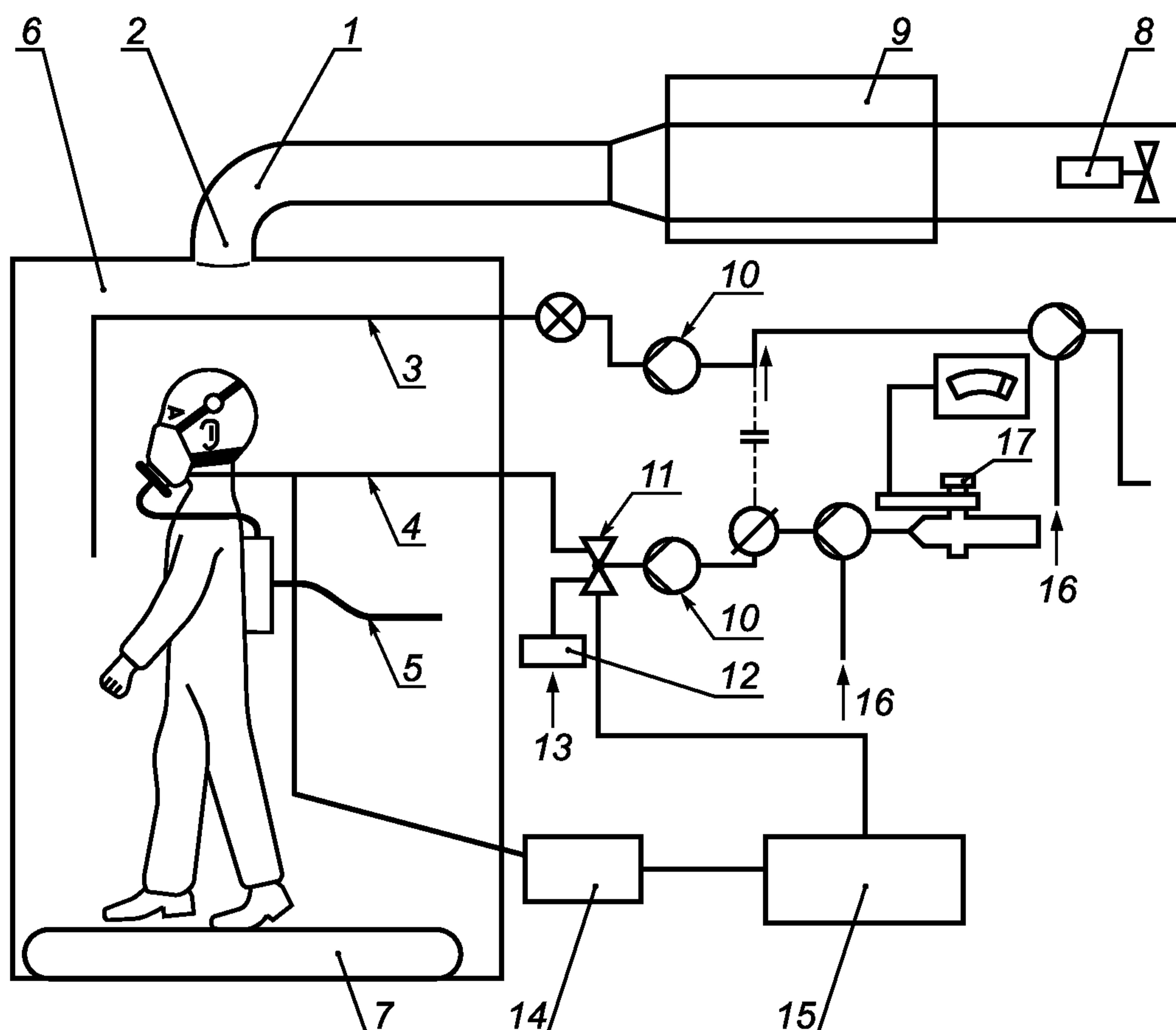
1 — труба; 2 — заслонка; 3 — пробоотборник в камере; 4 — пробоотборник в дыхательной зоне; 5 — воздух для дыхания; 6 — камера; 7 — бегущая дорожка; 8 — вентилятор; 9 — распылитель; 10 — насос; 11 — переключающий клапан; 12 — фильтр; 13 — чистый воздух; 14 — манометр; 15 — устройство импульсного отбора проб; 16 — дополнительная подача воздуха (если необходимо); 17 — фотометр
