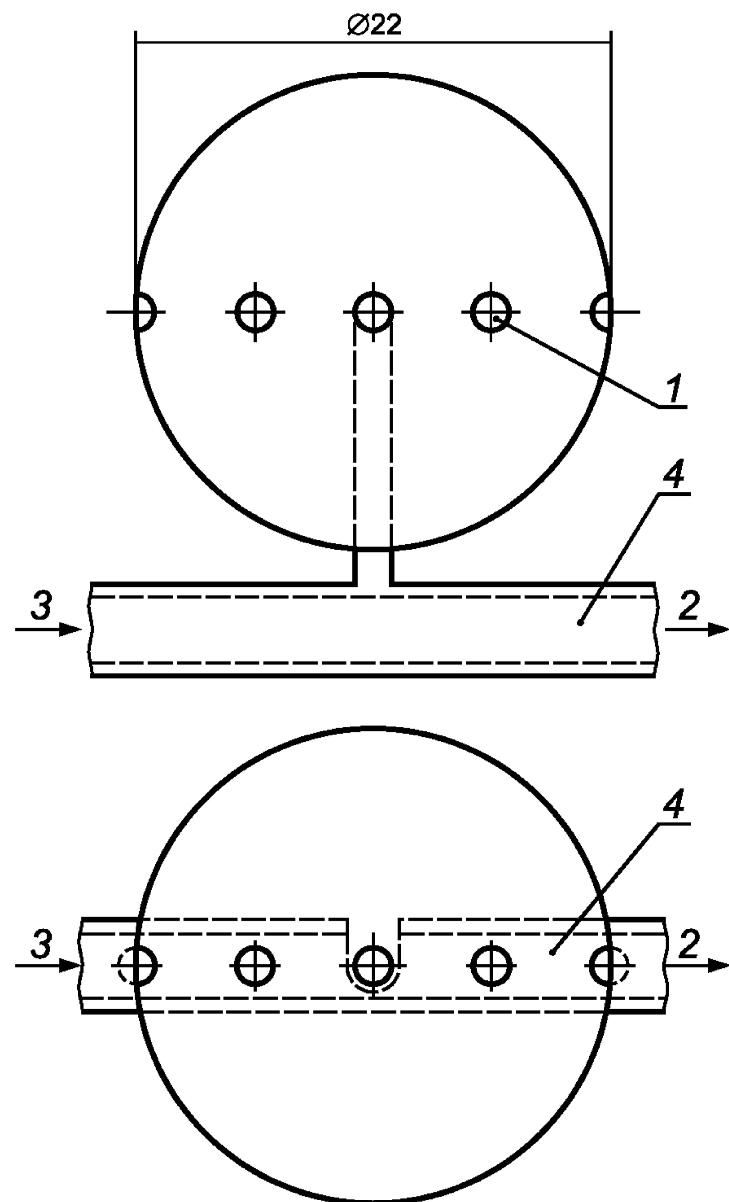
1 — восемь отверстий диаметром 1,5 мм, расположенных равномерно; 2 — подключение к насосу пробоотборника;
