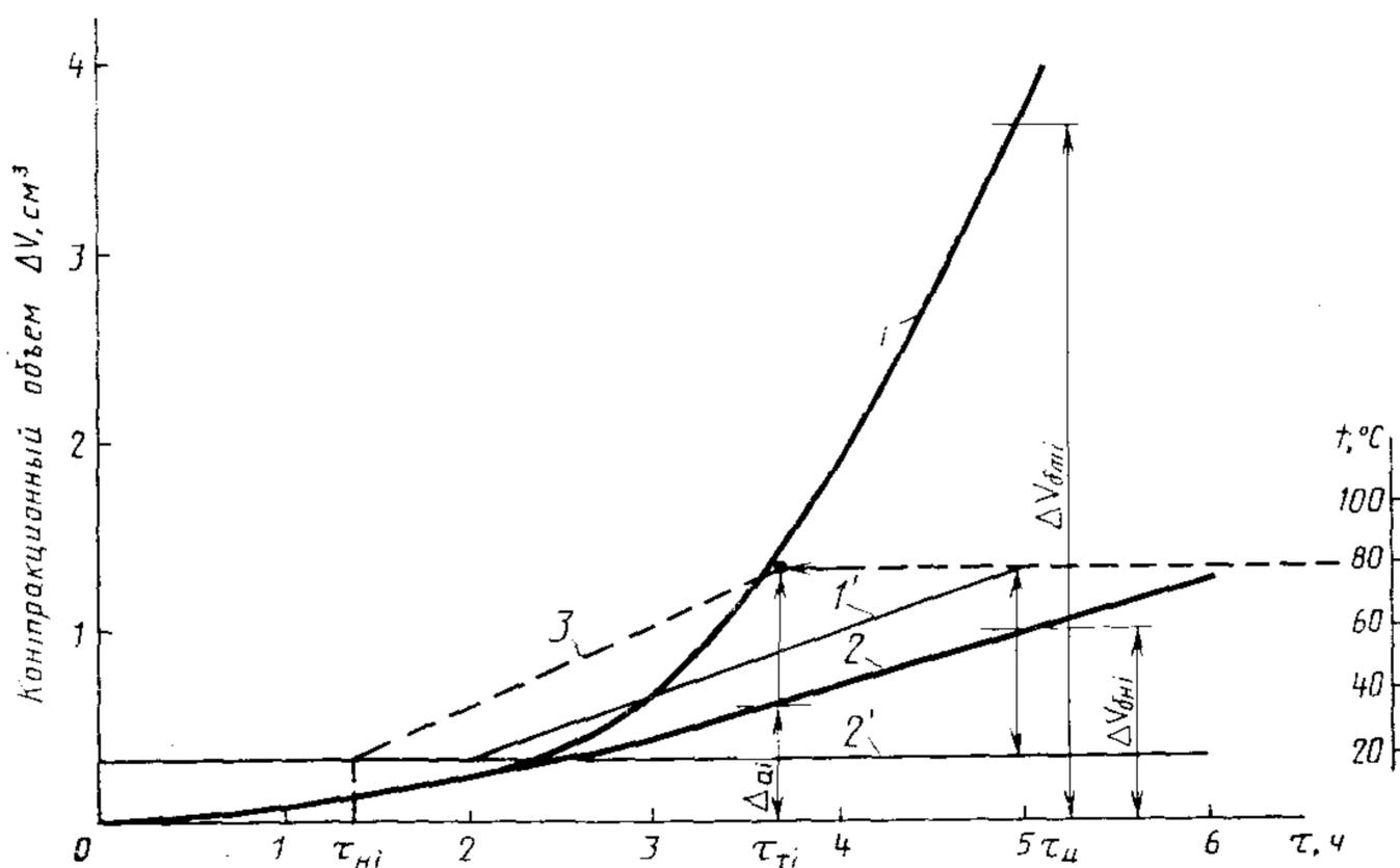
5.4.3. Определение времени  $\tau_i$  твердения материала, к которому должна быть достигнута требуемая прочность бетона.
