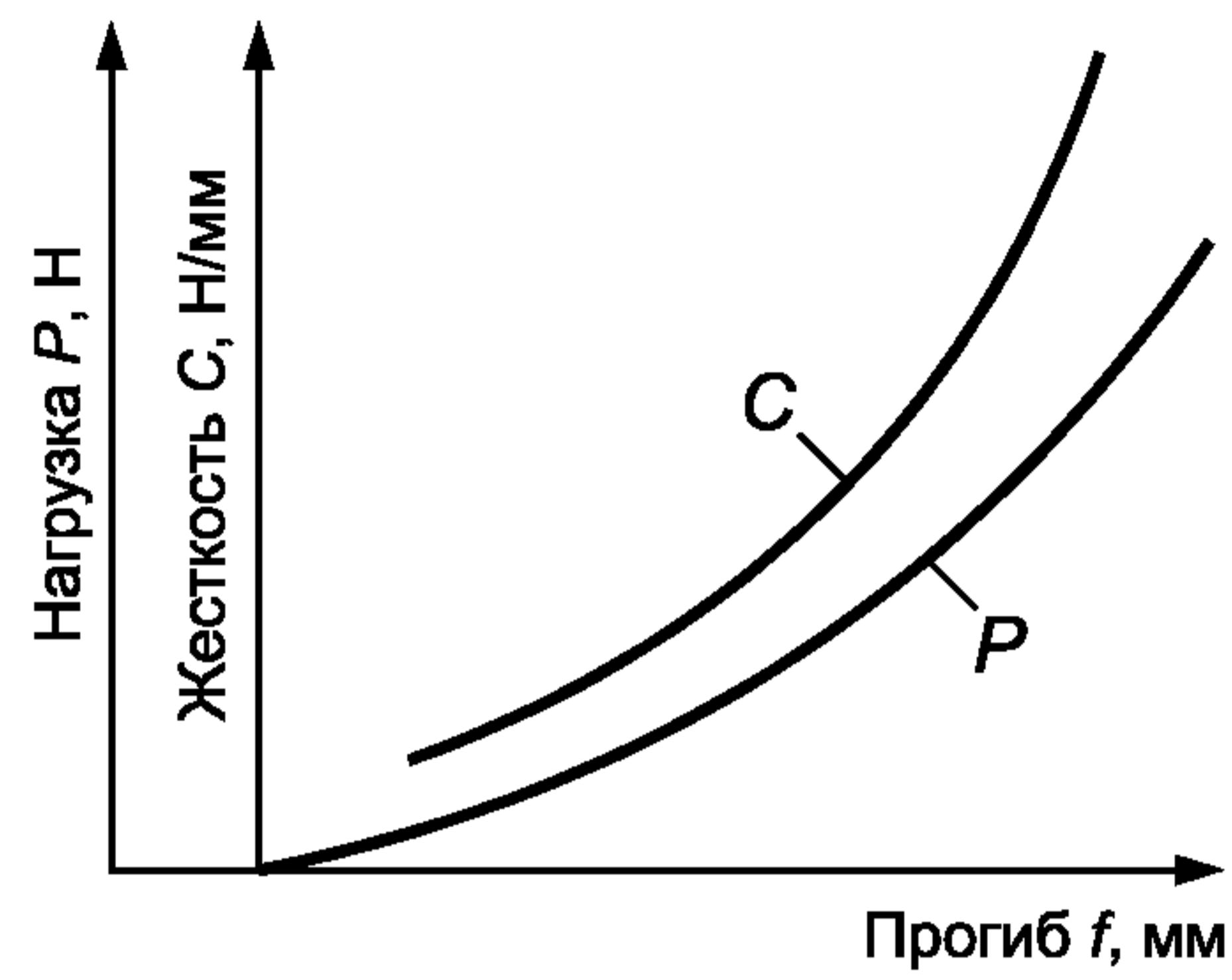
Жесткость пружины С, Н/мм, определяют, как минимум, в пяти точках зависимости нагрузки  $P$  от прогиба  $f$  как производную  $dP/df$ .
