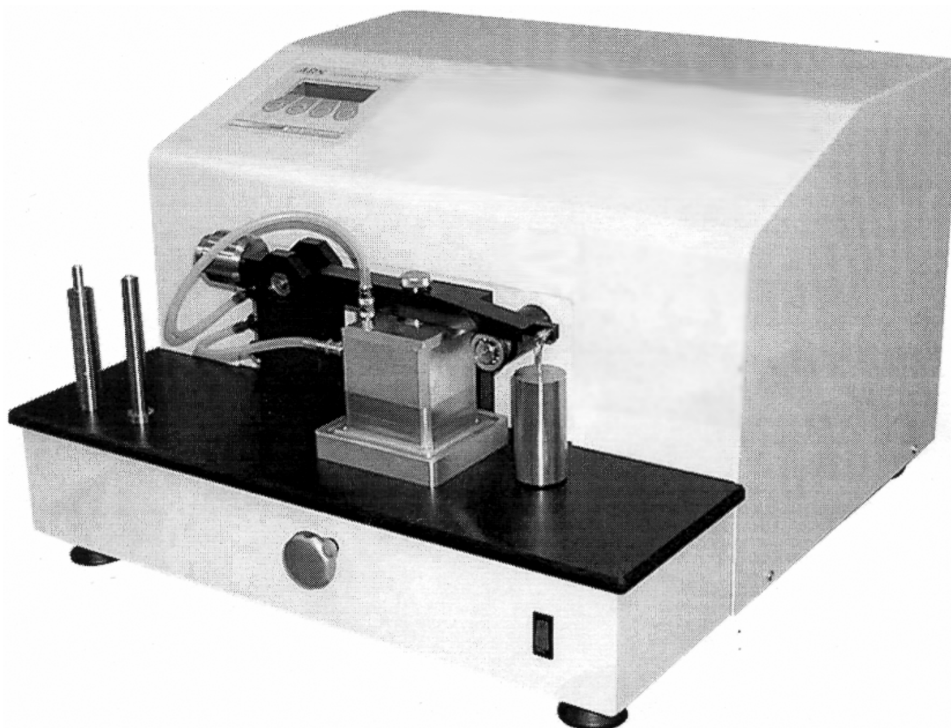
Рисунок A2.1 — Полностью автоматический аппарат для оценки смазывающей способности в системе «шар-цилиндр»
