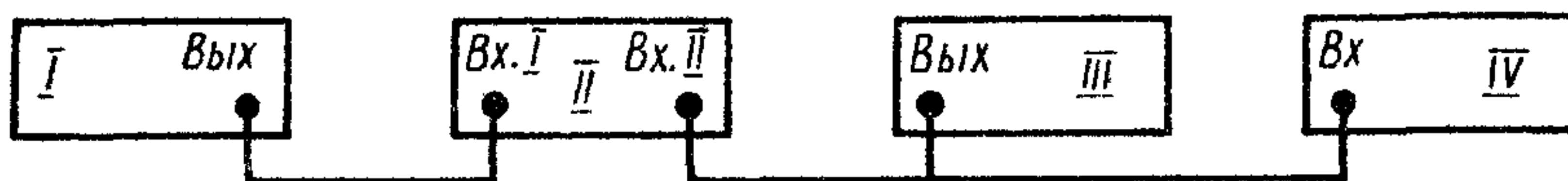
I —поверяемый аппарат; II —двухлучевой осциллограф С1-18; III —генератор сигналов ГЗ-49; IV —вольтметр переменного тока ВЗ-24.
