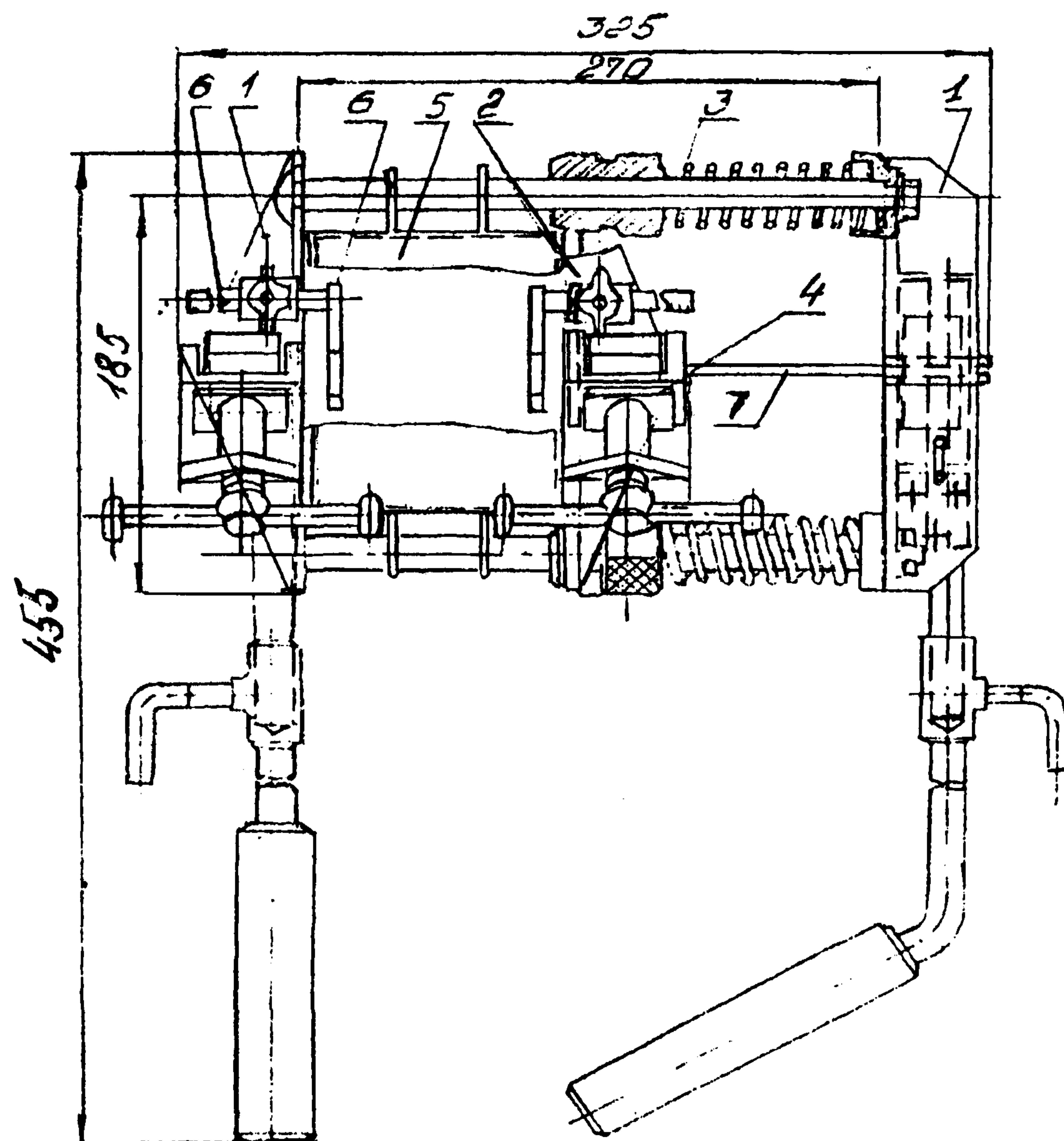
Аппарат типа АТСП для сварки проводов
