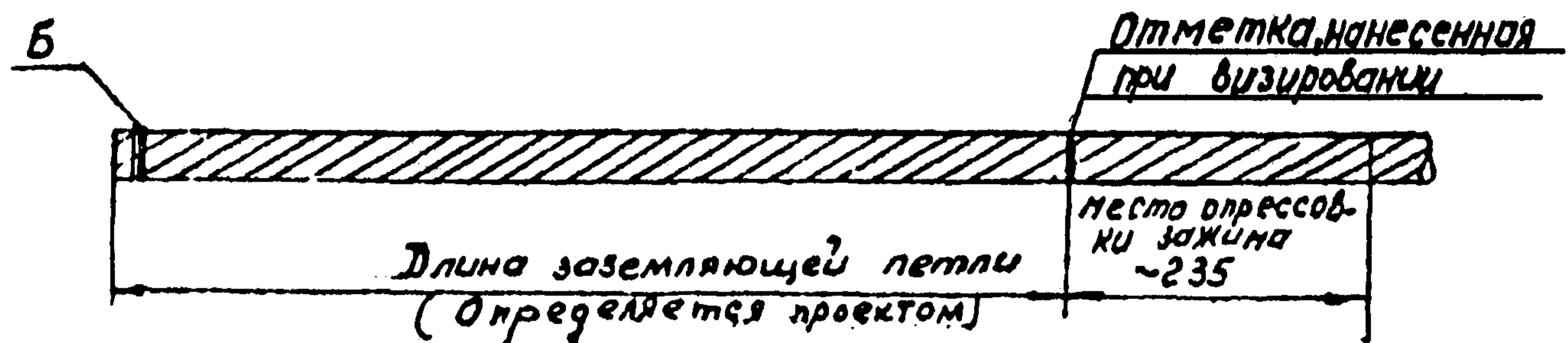
Установка и опрессовка зажима
