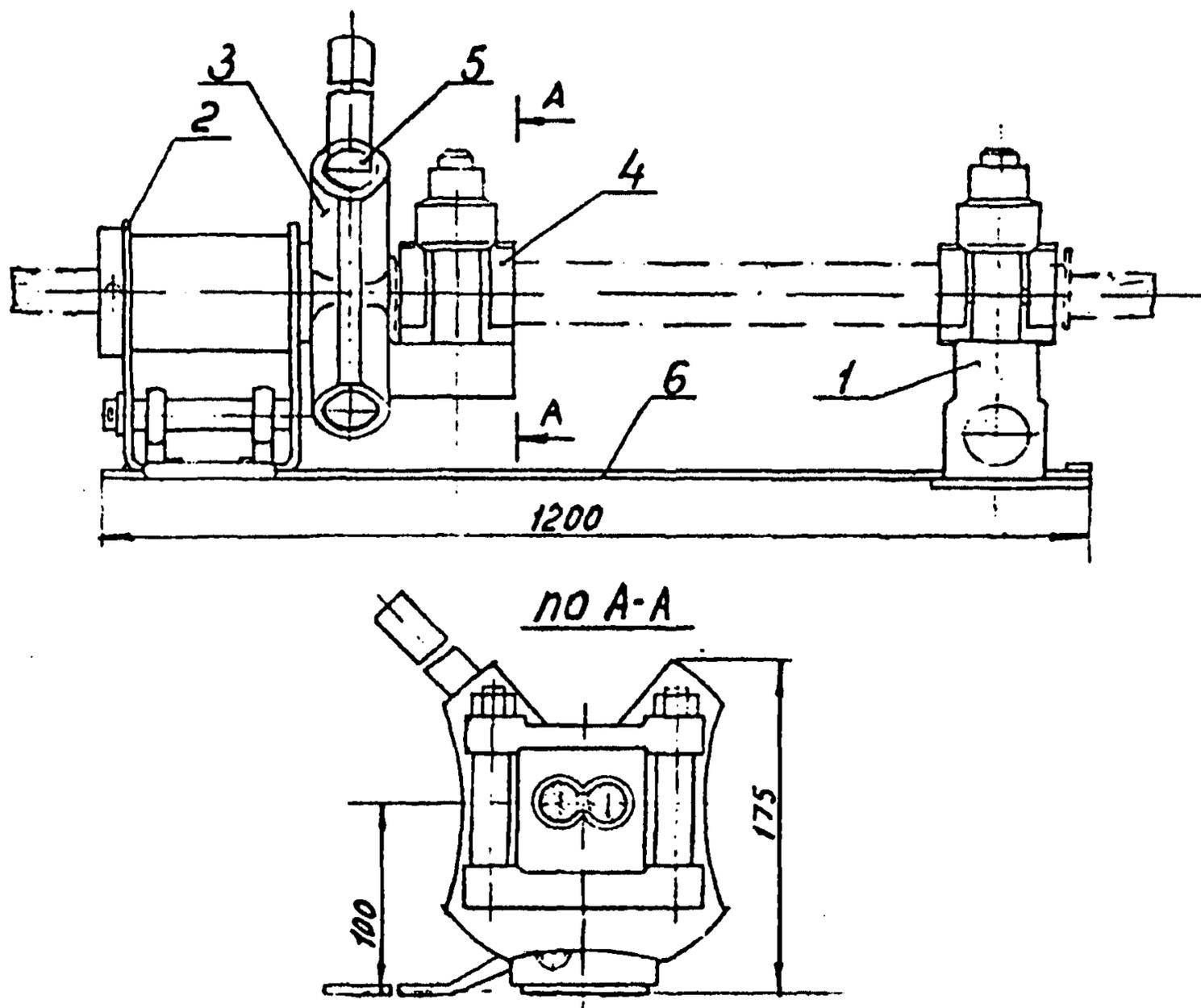
Приспособление МЦ-230А для скручивания
