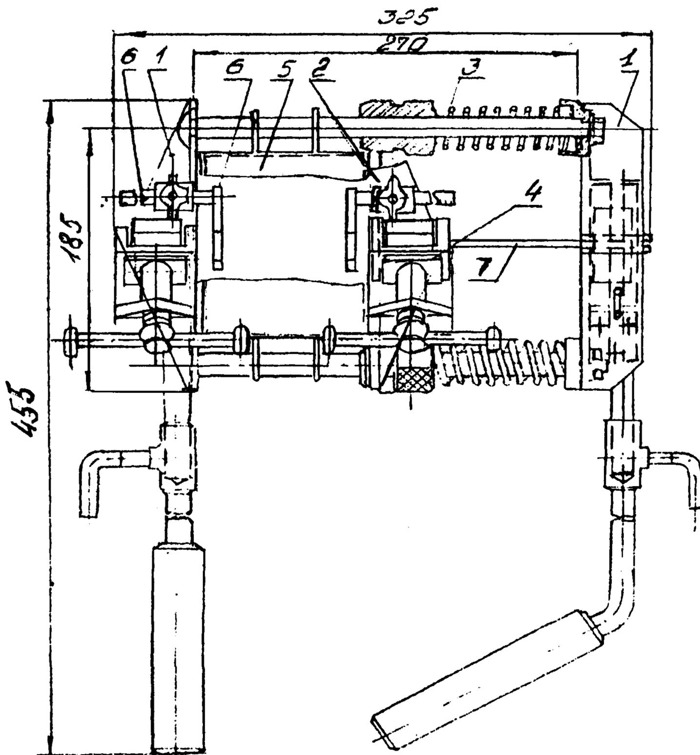
Аппарат типа АТСП для сварки проводов
