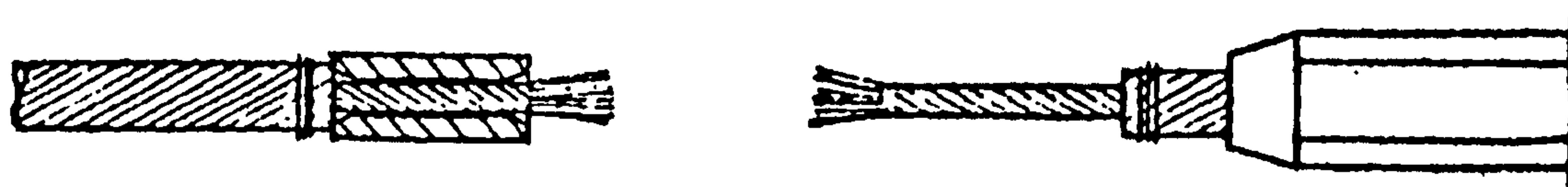
Положение сердечника соединителя до опрессовки
