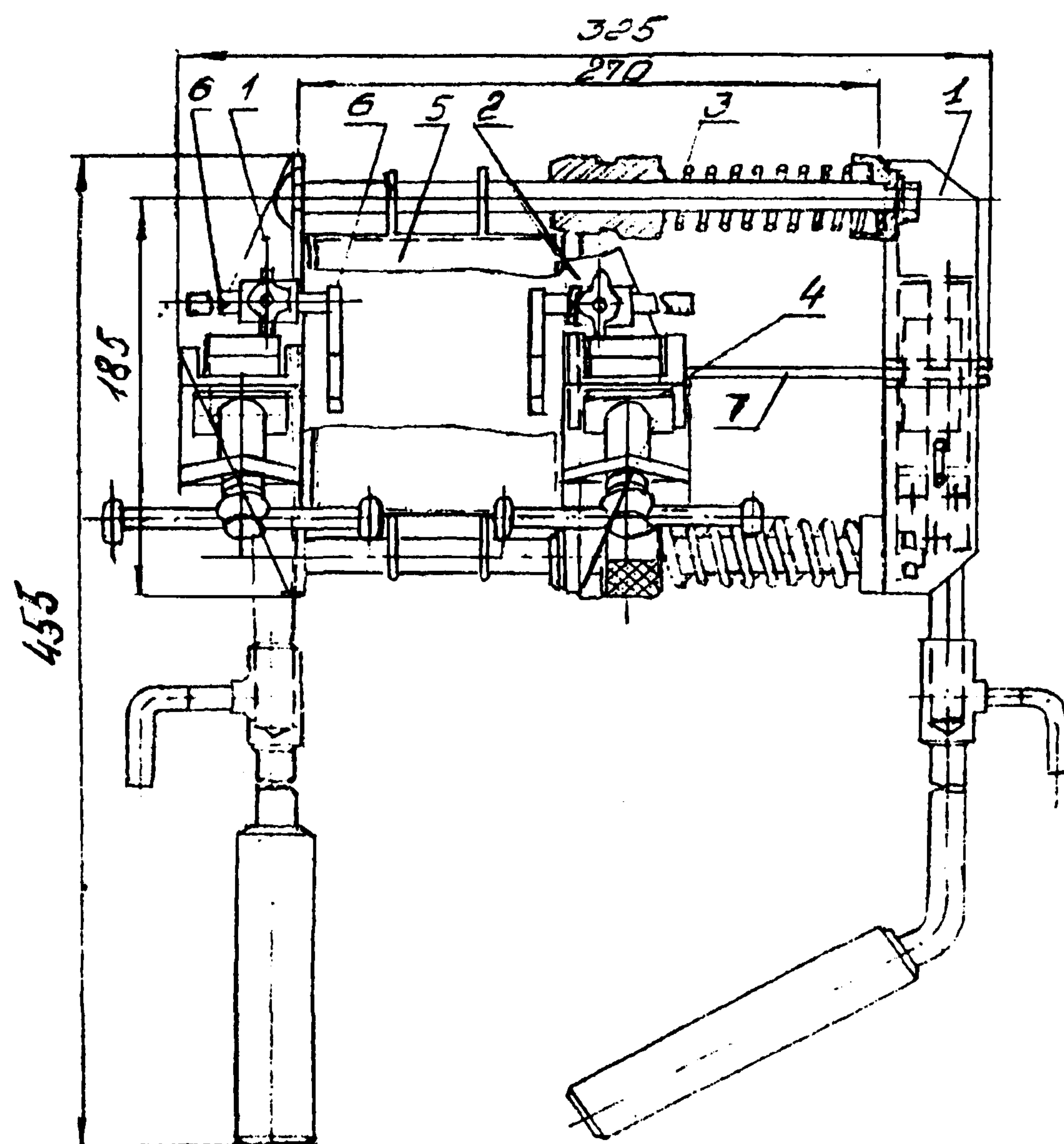
Аппарат типа АТСП для сварки проводов
