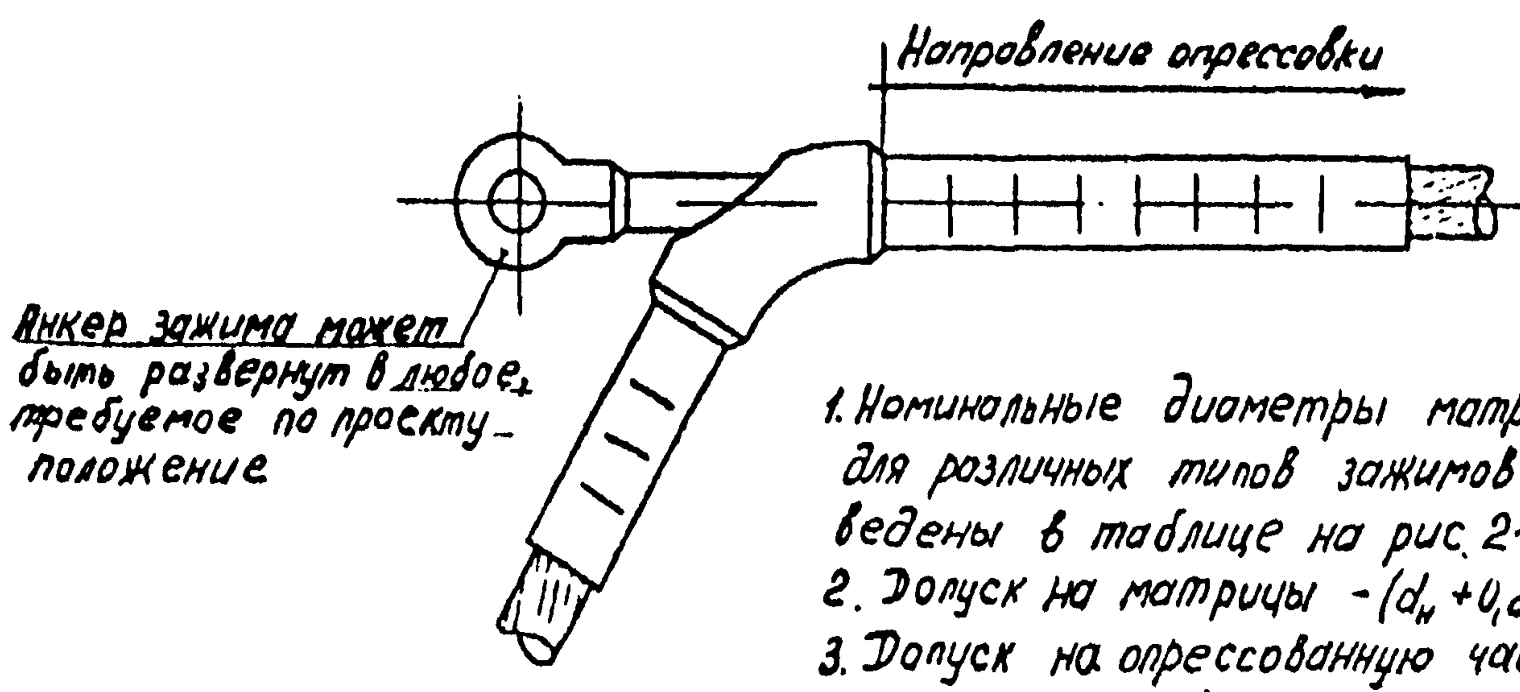
Рис. 2-4. Опрессовка линейной части корпуса зажима НАС.
