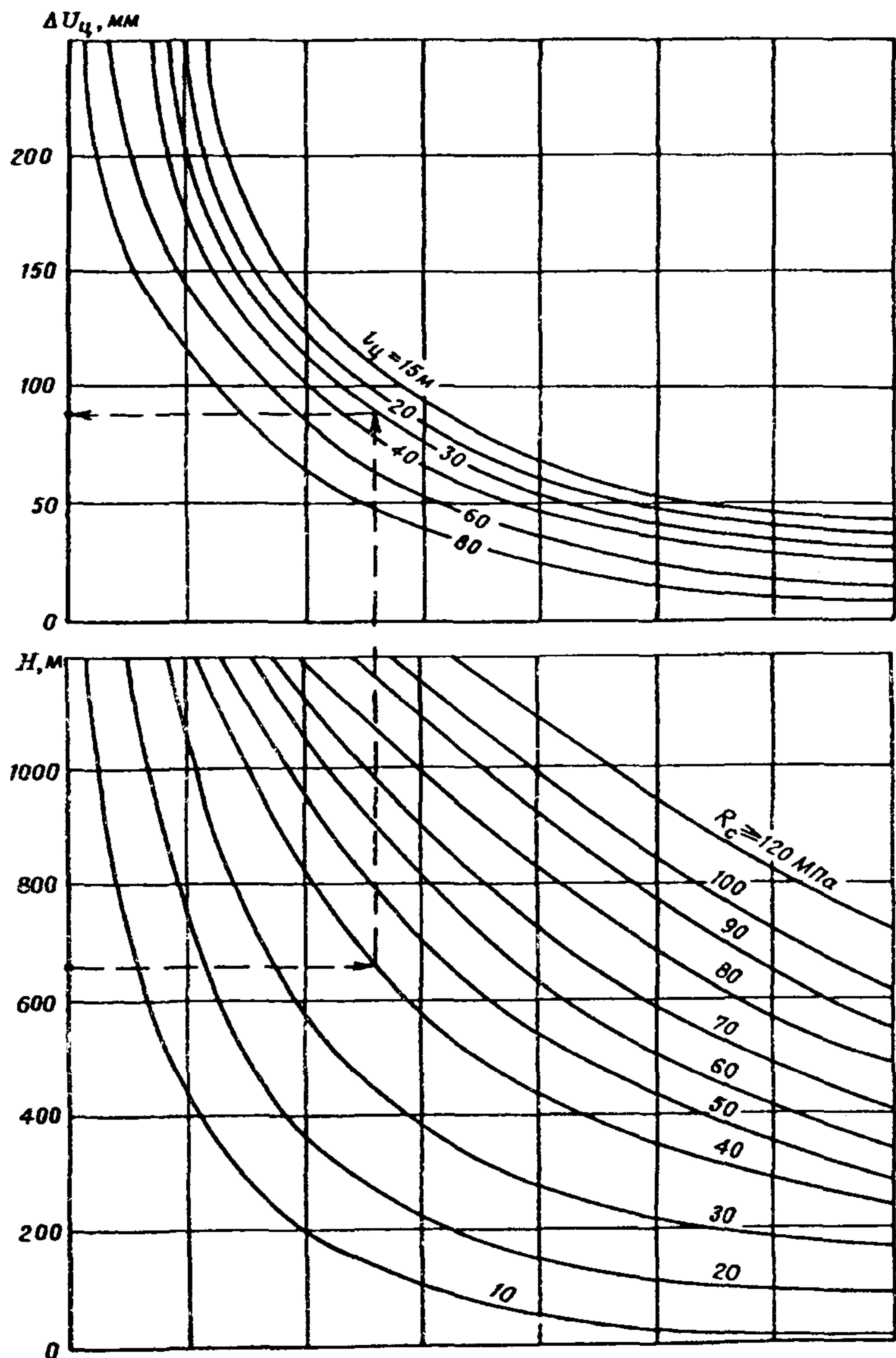
Рис. П.1.2. Расчетные смещения кровли при охране выработки целиками
