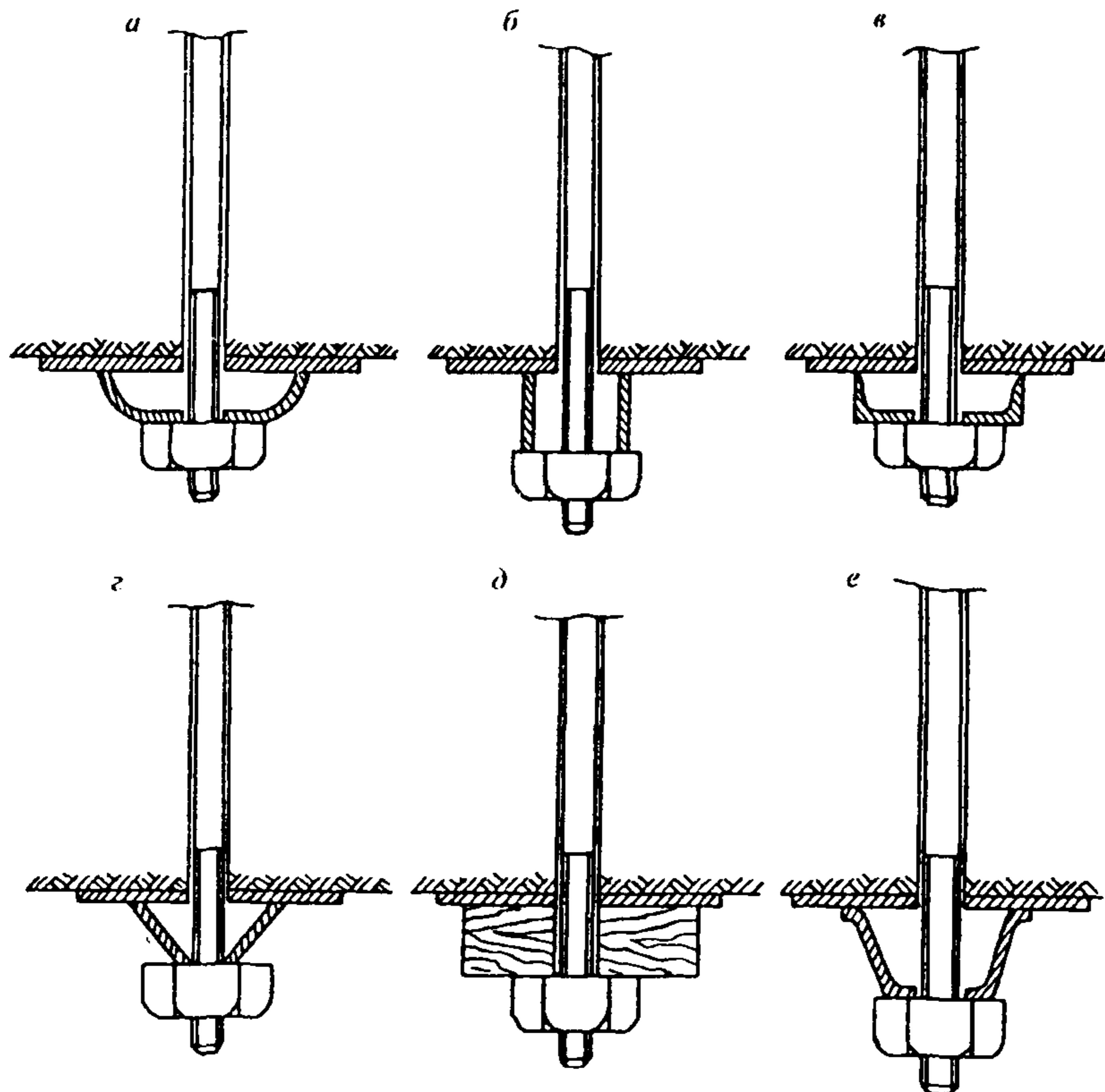
Рис. П.3.1. Элементы податливости из податливой опорной пластины (а), трубы (б), швеллера (в), уголка (г), деревянного бруса (д), спецпрофиля СВП-17 (е)
