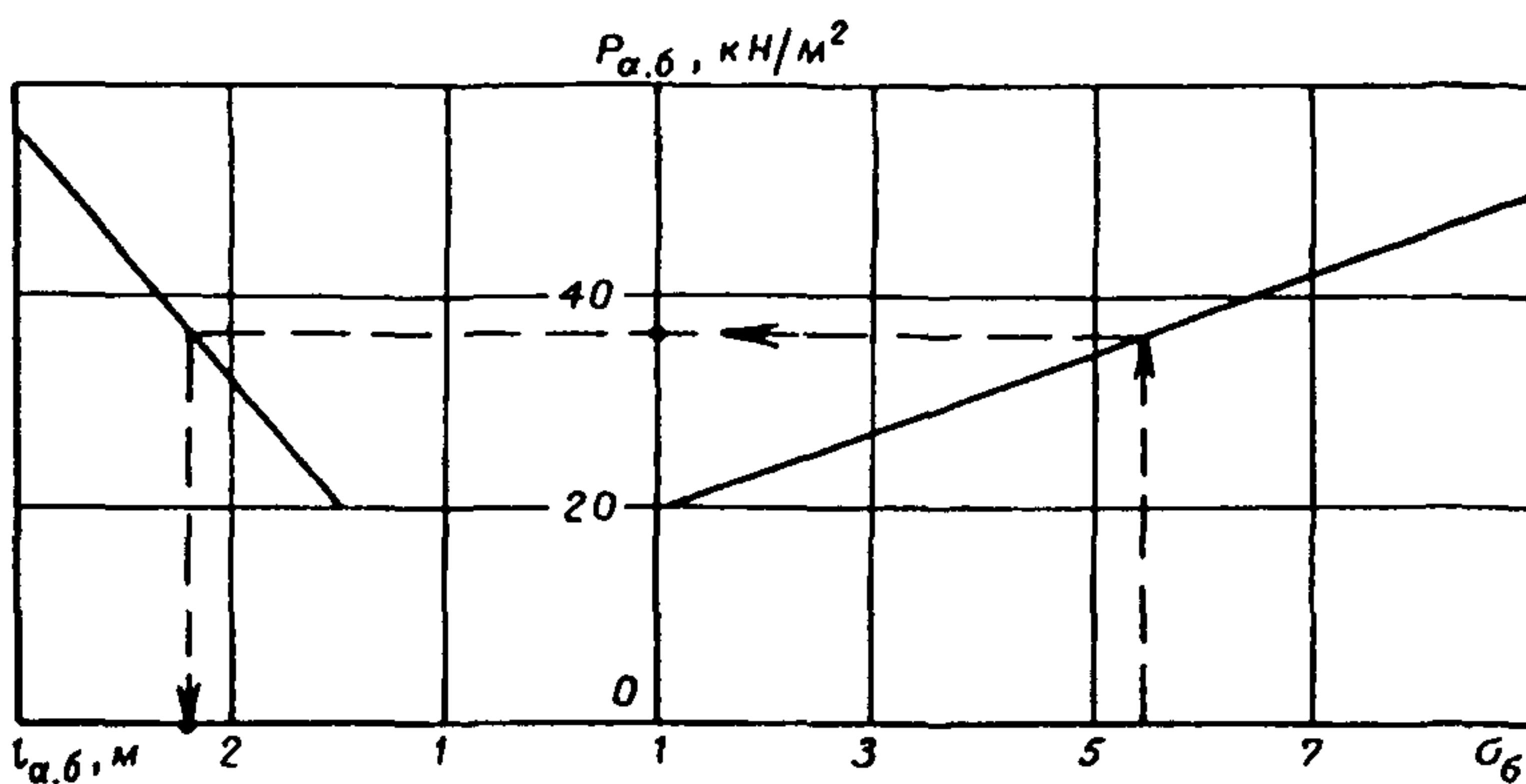
Рис. 2. Номограмма для определения параметров анкерной крепи в боках выработки (пунктирной линией показан ключ к определению  $P_{a,b}$  и  $l_{a,b}$  расчетных значений  $\sigma_b$ )
