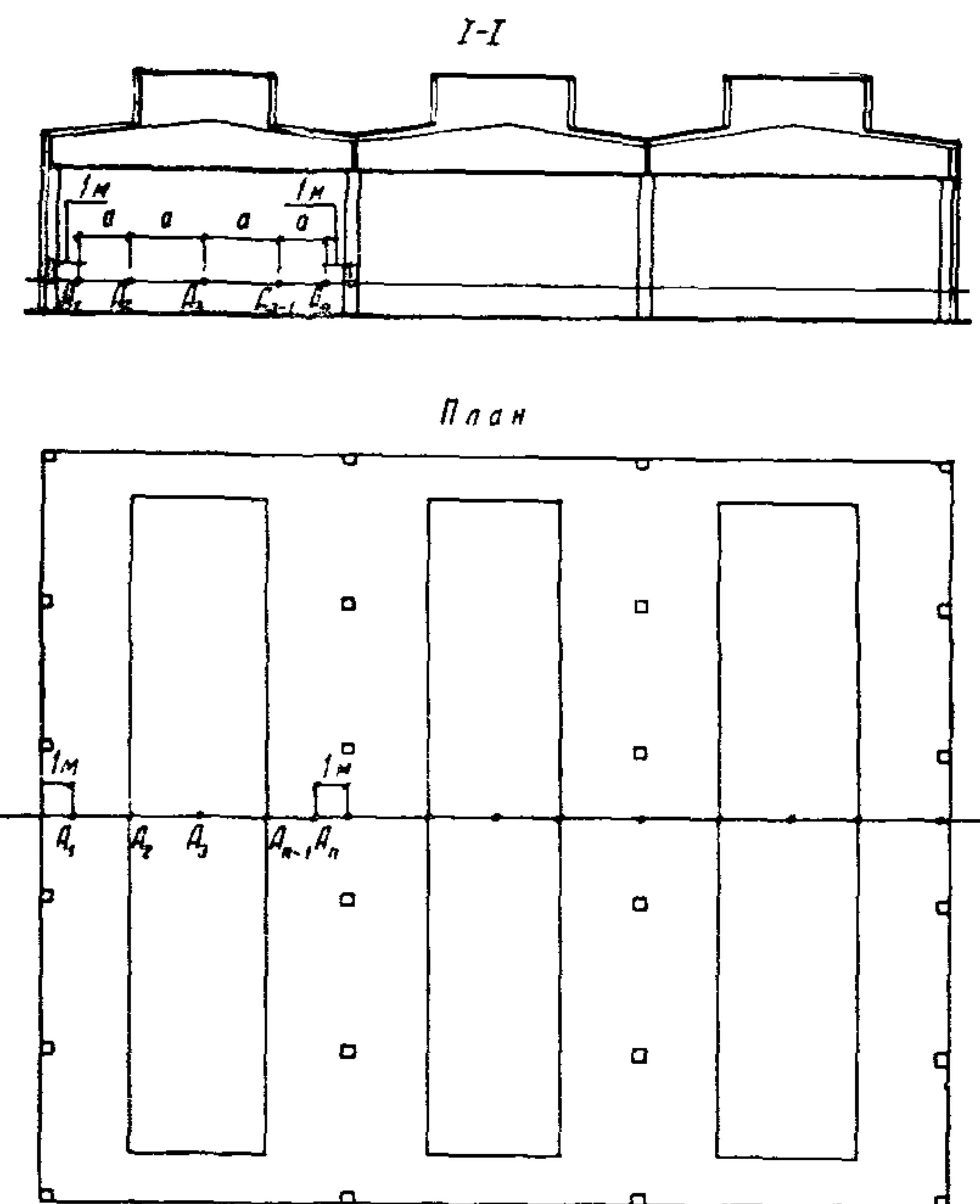
Рис. 3. Характерный поперечный разрез помещения для расчета к.е.о. при верхнем освещении
