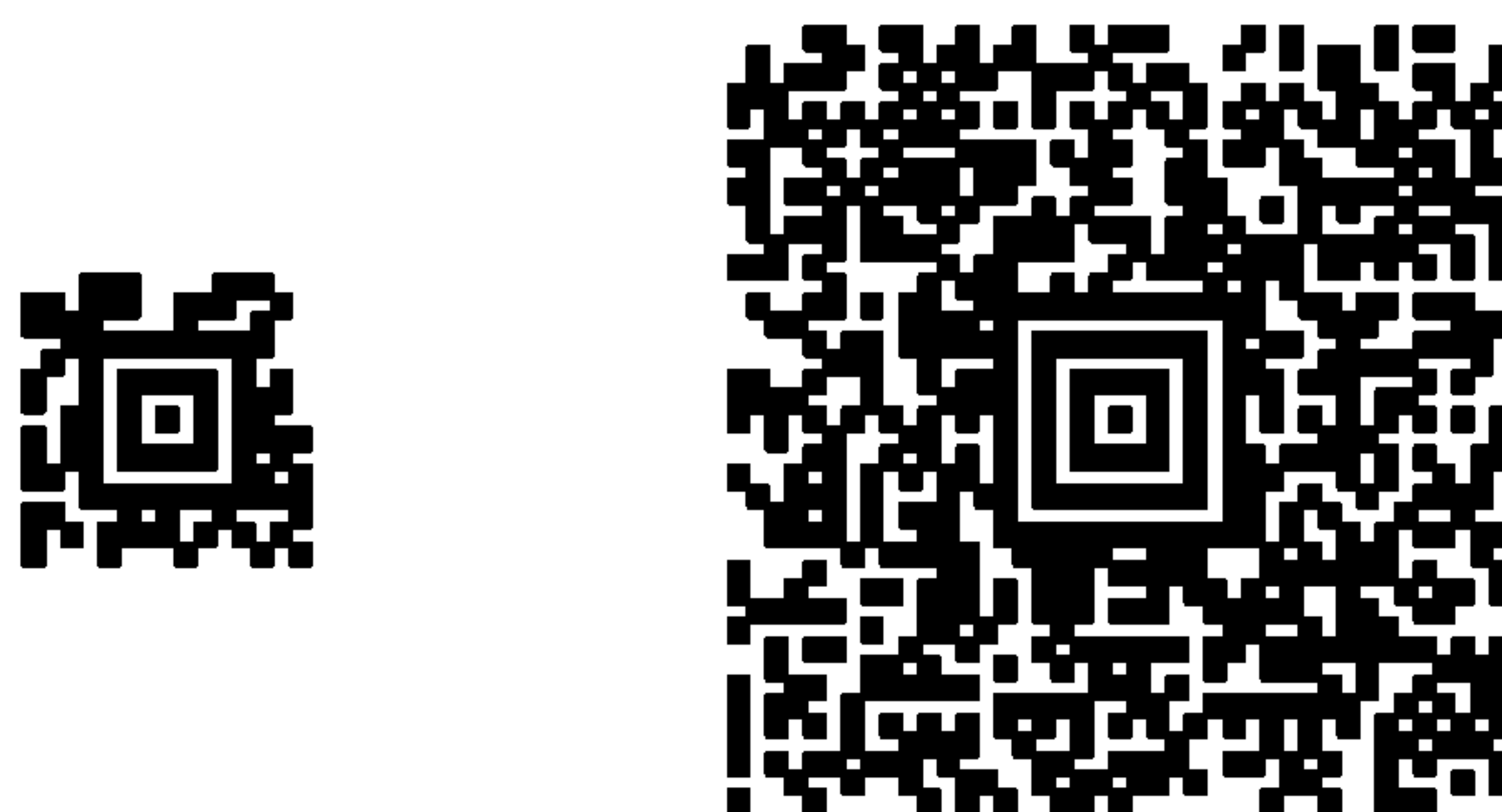
Рисунок 1 — Типовые символы Aztec Code
