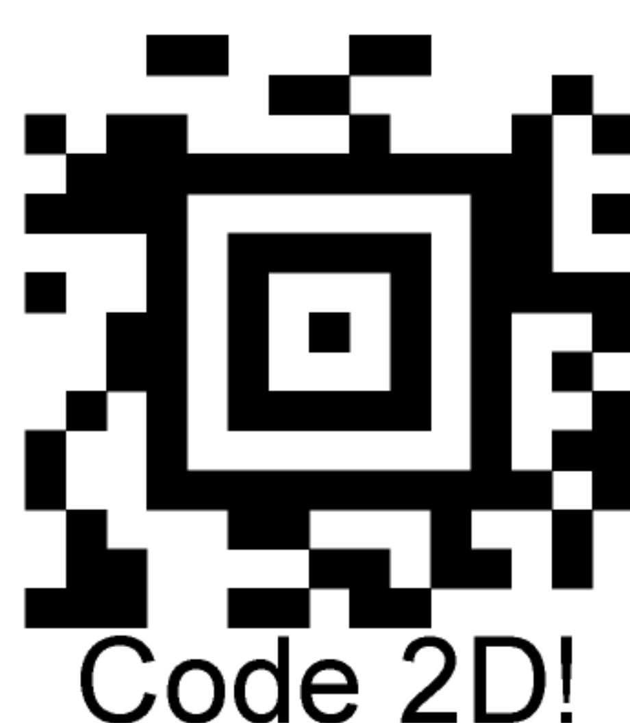
Рисунок G.2 — Символ Aztec Code, кодирующий данные сообщения «Code 2D!»
