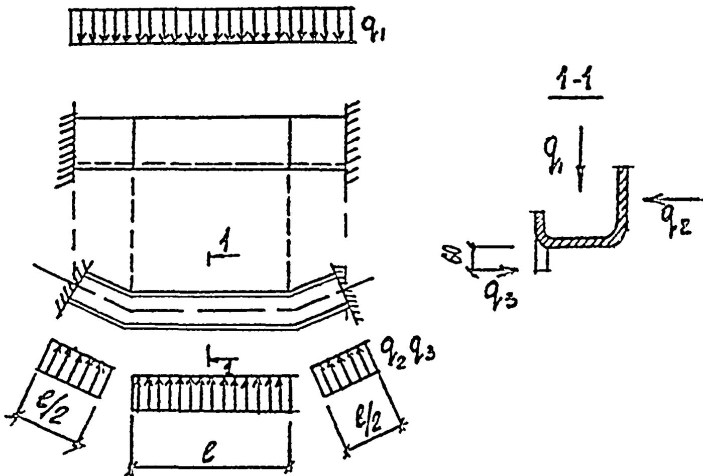
РАСЧЕТНЫЕ НАГРУЗКИ НА ЛОТКИ
