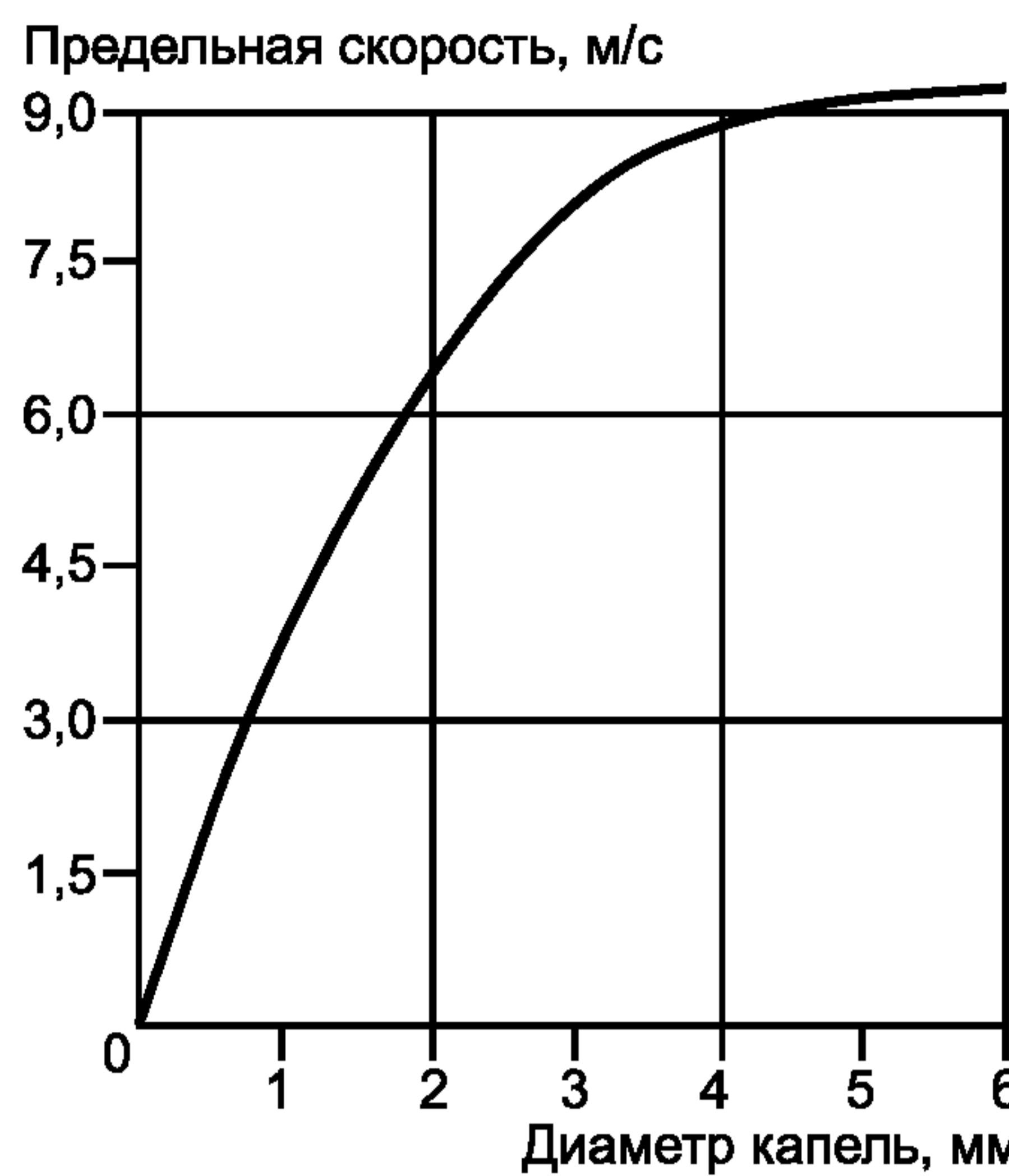
Рисунок 1 — Конечная скорость капель дождя в чистом воздухе
