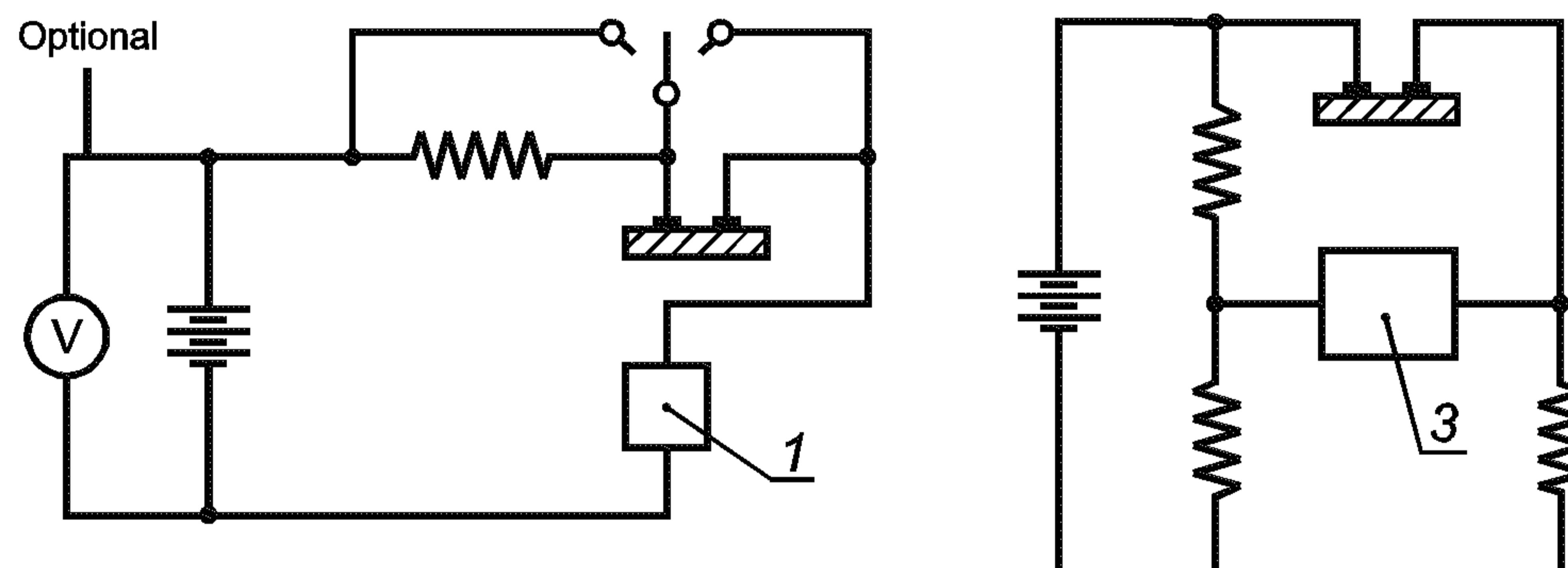
a) Определение соотношения электрических токов, когда одно и то же напряжение прикладывают последовательно к двум сопротивлениям
