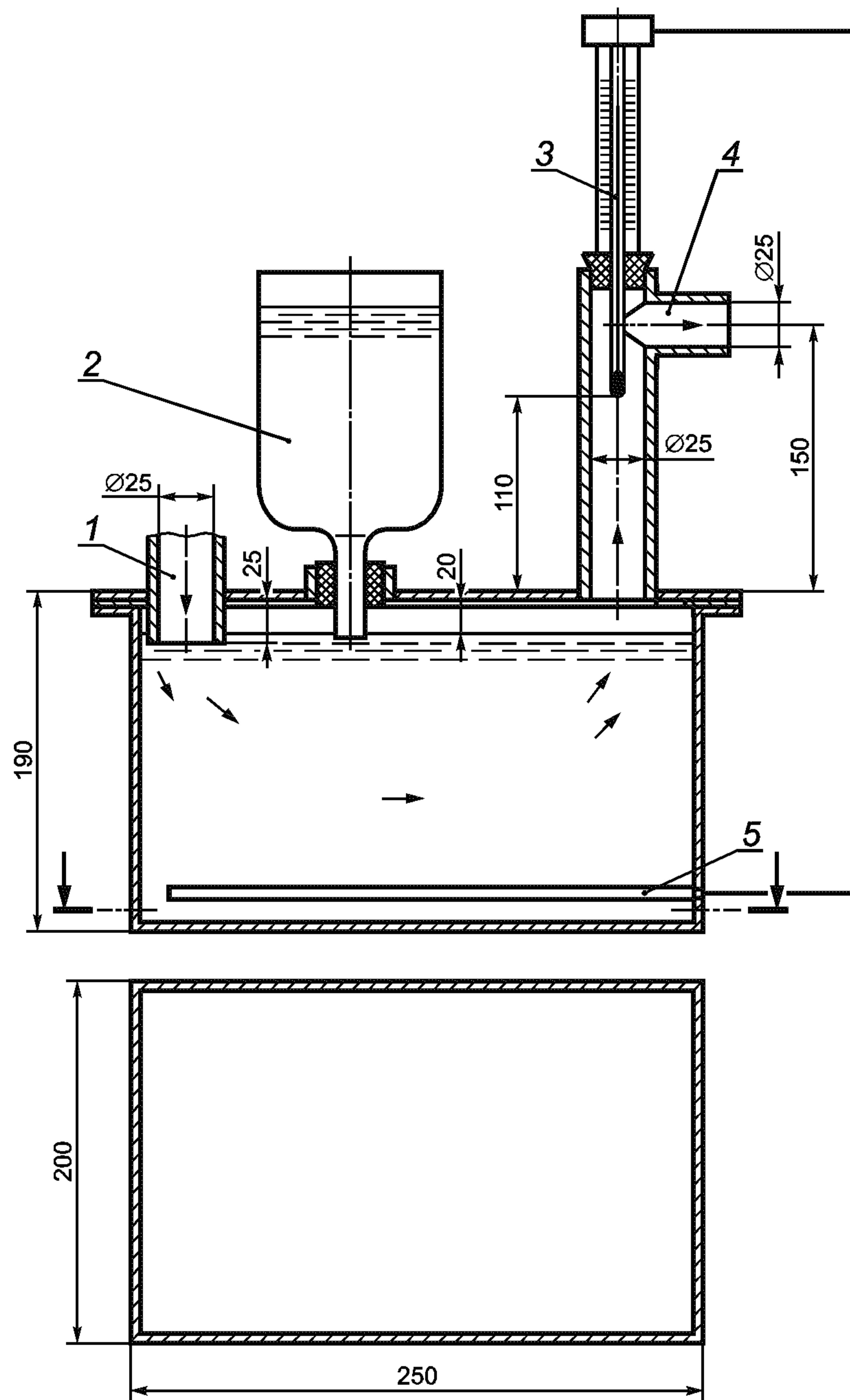
1 — от искусственных легких; 2 — пополняемый контейнер; 3 — терморегулирующее устройство; 4 — к контрольному клапану;
