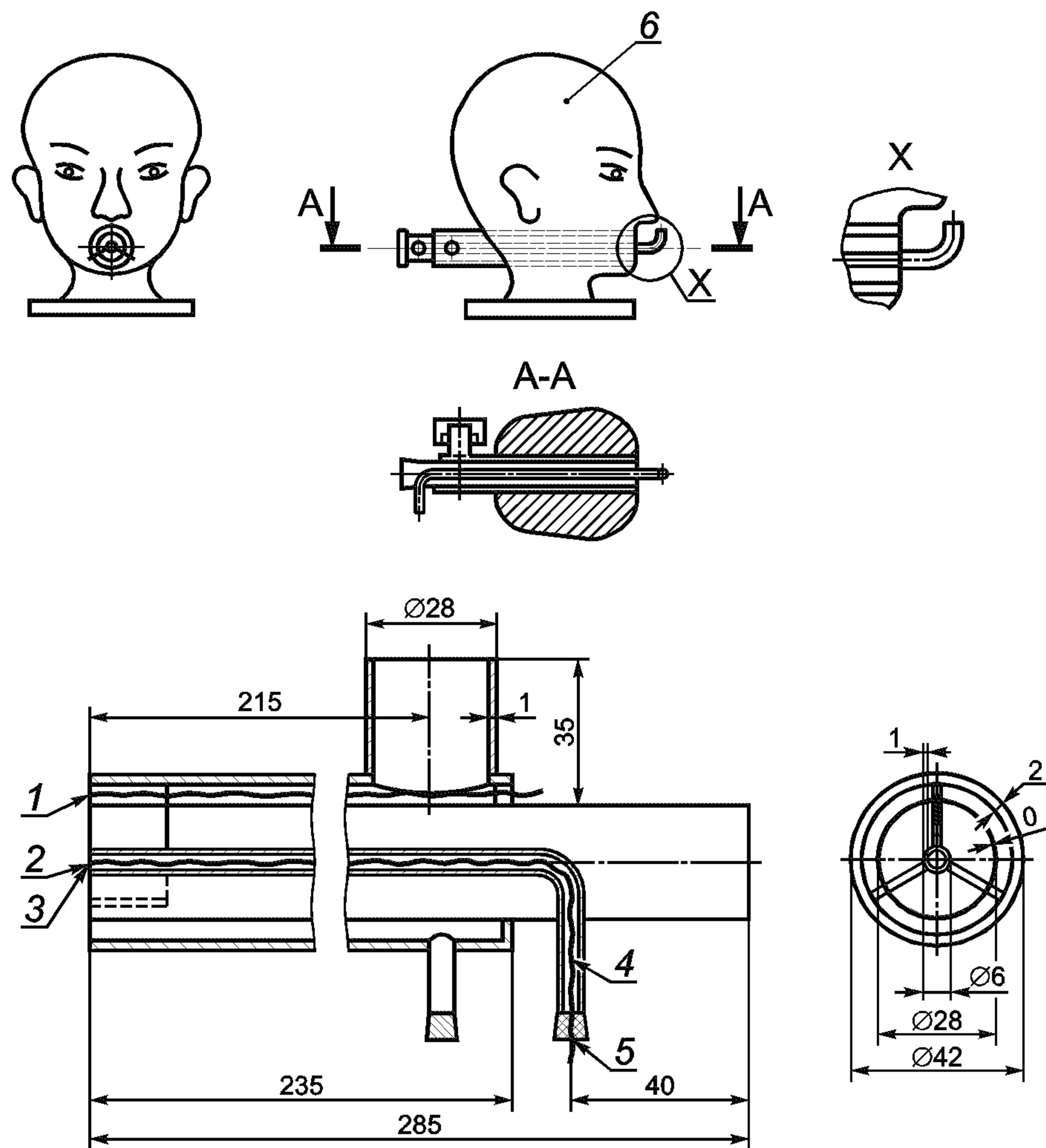
1 — точка измерения температуры (на выдохе); 2 — точка измерения температуры (на вдохе); 3 — точка измерения давления;
