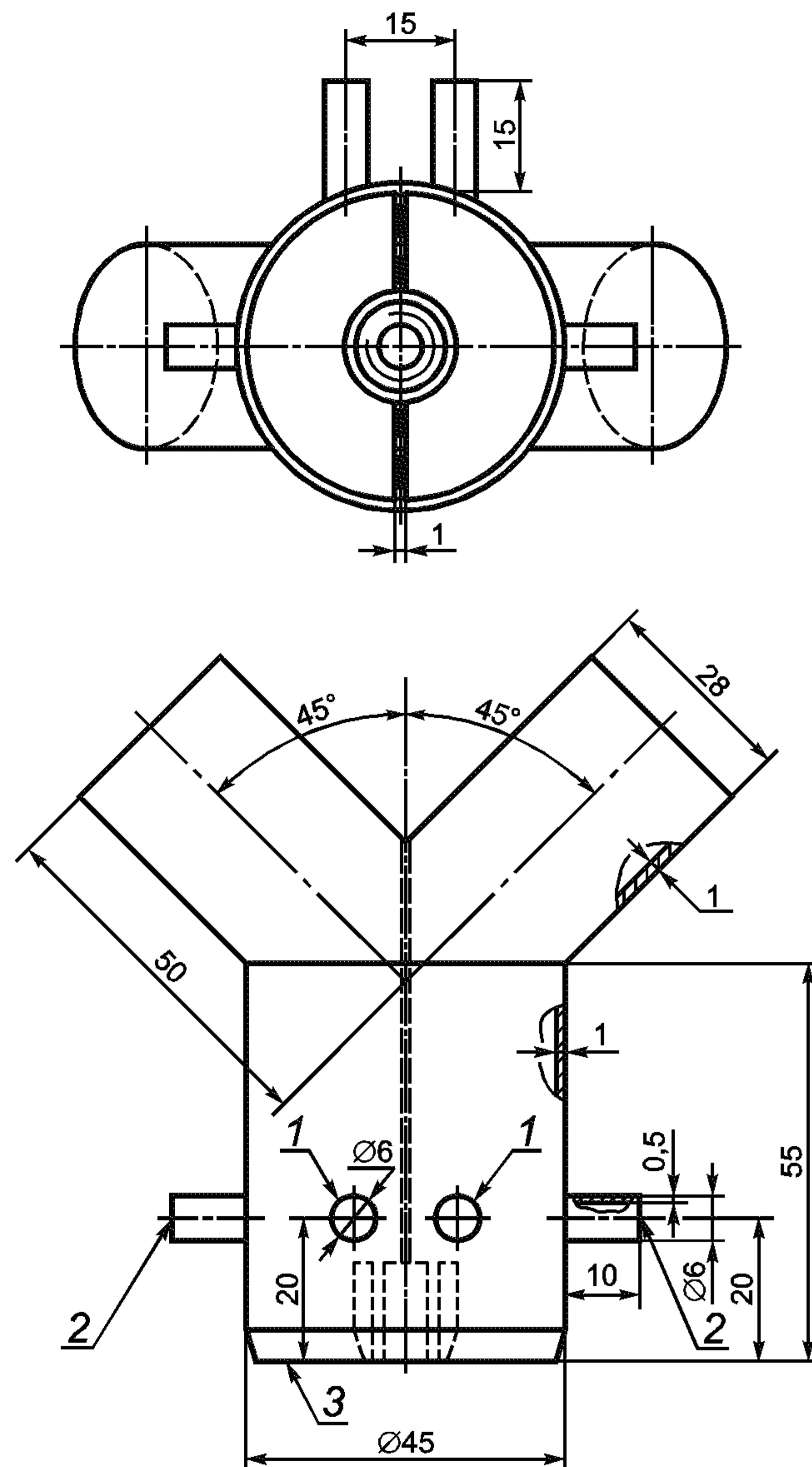
1 — точка измерения давления; 2 — точка измерения температуры; 3 — центральное резьбовое соединение
