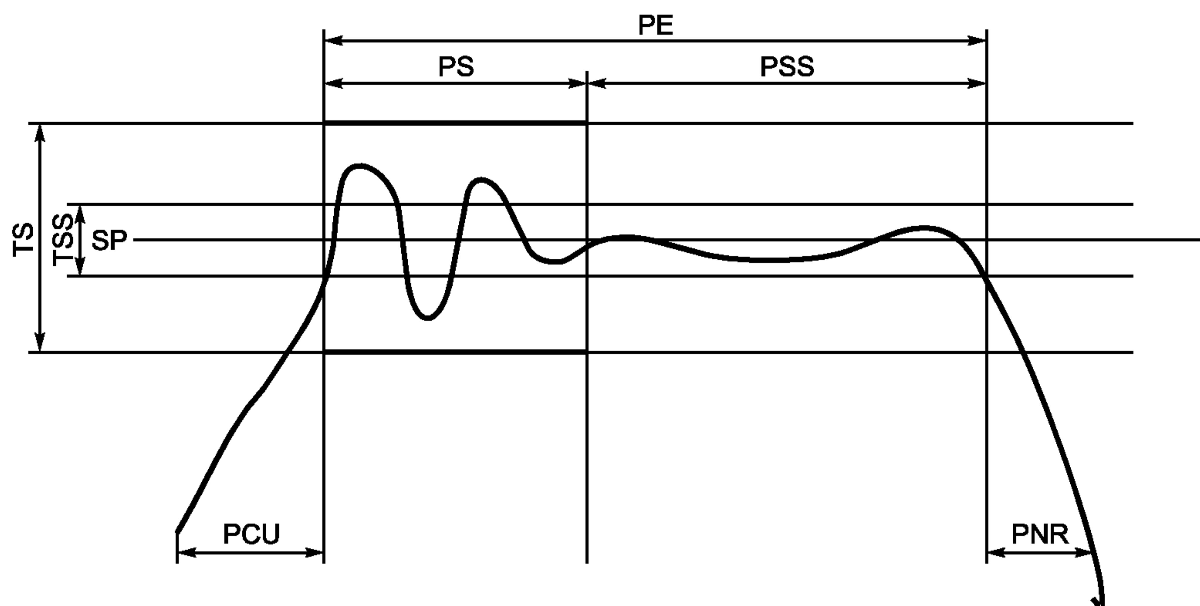
PS — период стабилизации; PSS — период постоянного состояния; РЕ — период выдержки; PCU — период подъема; PNR — нулевая точка реакции; SP — заданная точка; TS — допуск стабилизации; TSS — допуск постоянного состояния
