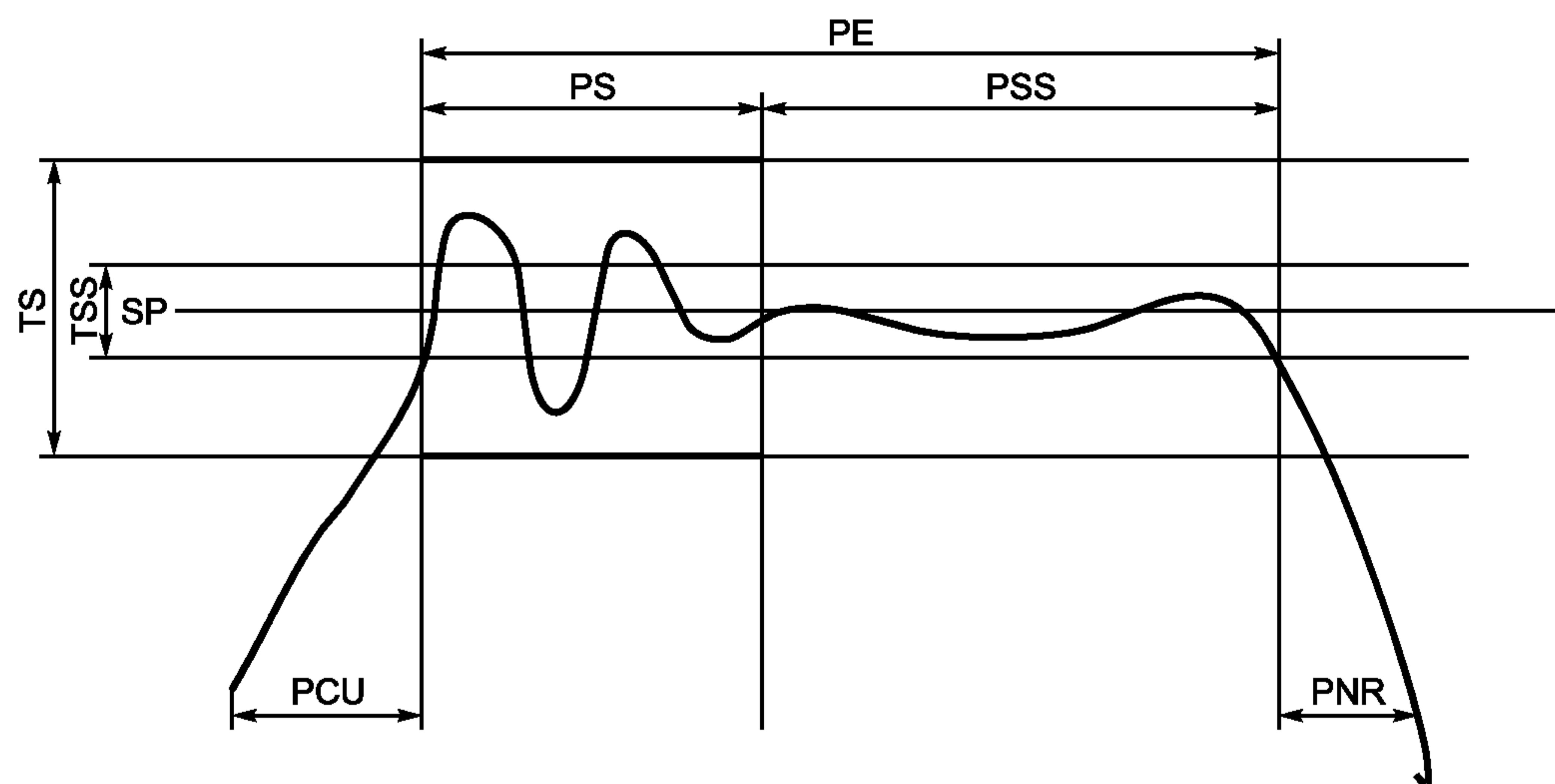
PS — период стабилизации; PSS — период постоянного состояния; PE — период выдержки; PCU — период подъема; PNR — нулевая точка реакции; SP — заданная точка; TS — допуск стабилизации; TSS — допуск постоянного состояния
