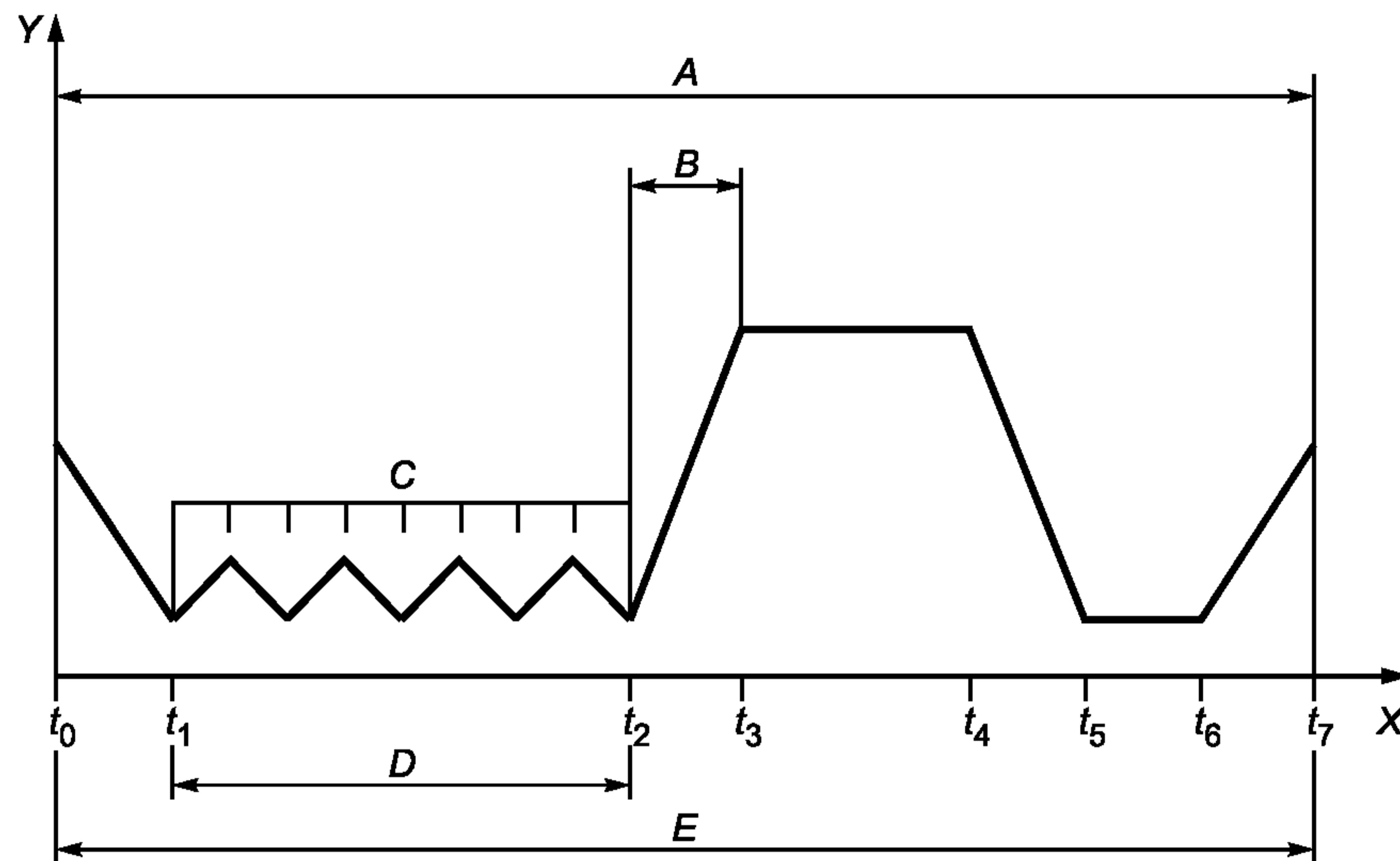
X — время; Y — измеренная переменная процесса; A — цикл (процесс); B — периоды; C — шаги; D — время продолжительности периода = ( $t_2 - t_1$ ); E — время продолжительности цикла = ( $t_7 - t_0$ )
