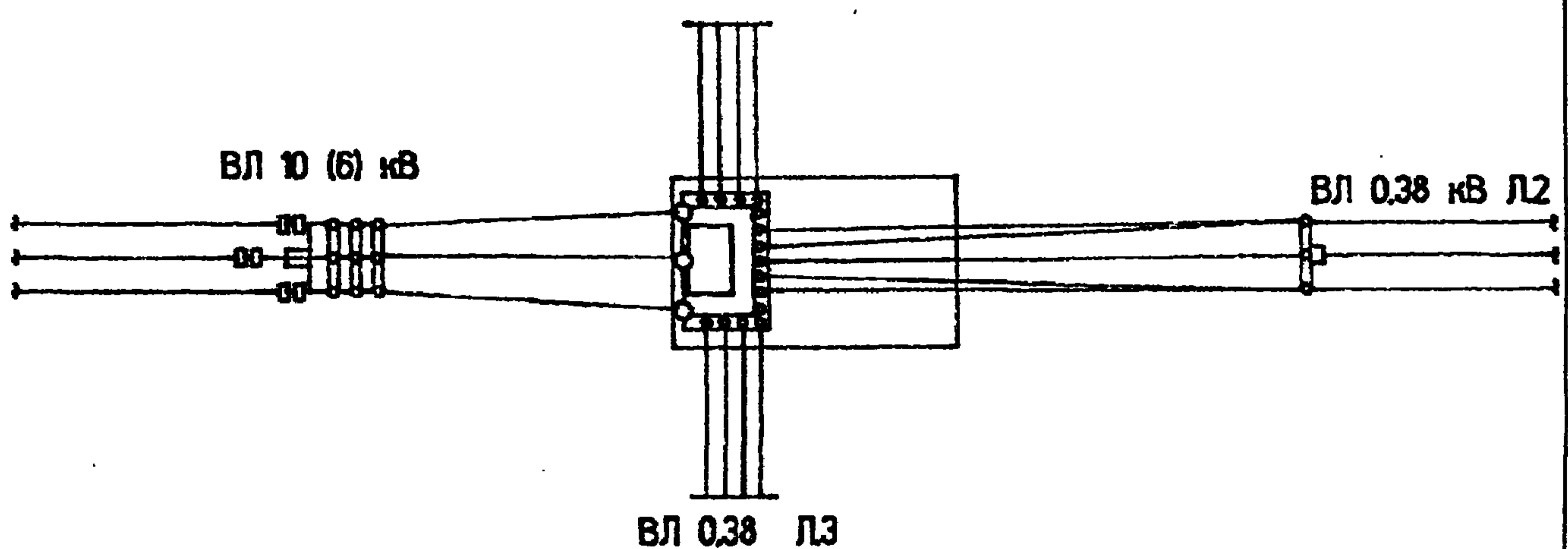
1. Расстояние от неизолированных токоведущих частей КТПК напряжением 6-10 кВ до земли должно быть не менее 4,5 м и напряжением 0,38 кВ - не менее 3,5 м.
