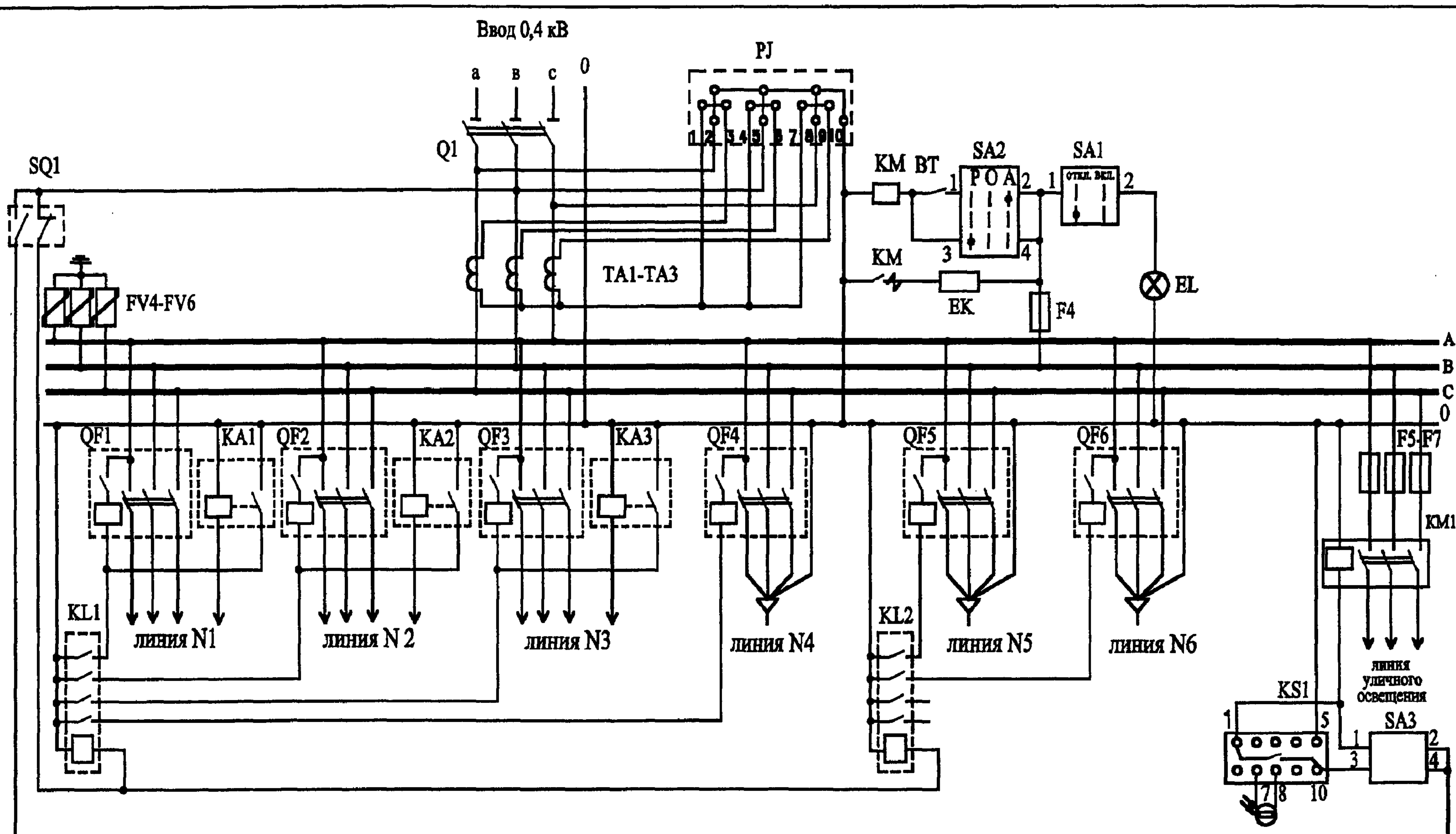
Схема электрическая РУ 0,4 кВ КТПК с ВН мощностью 400 кВА
