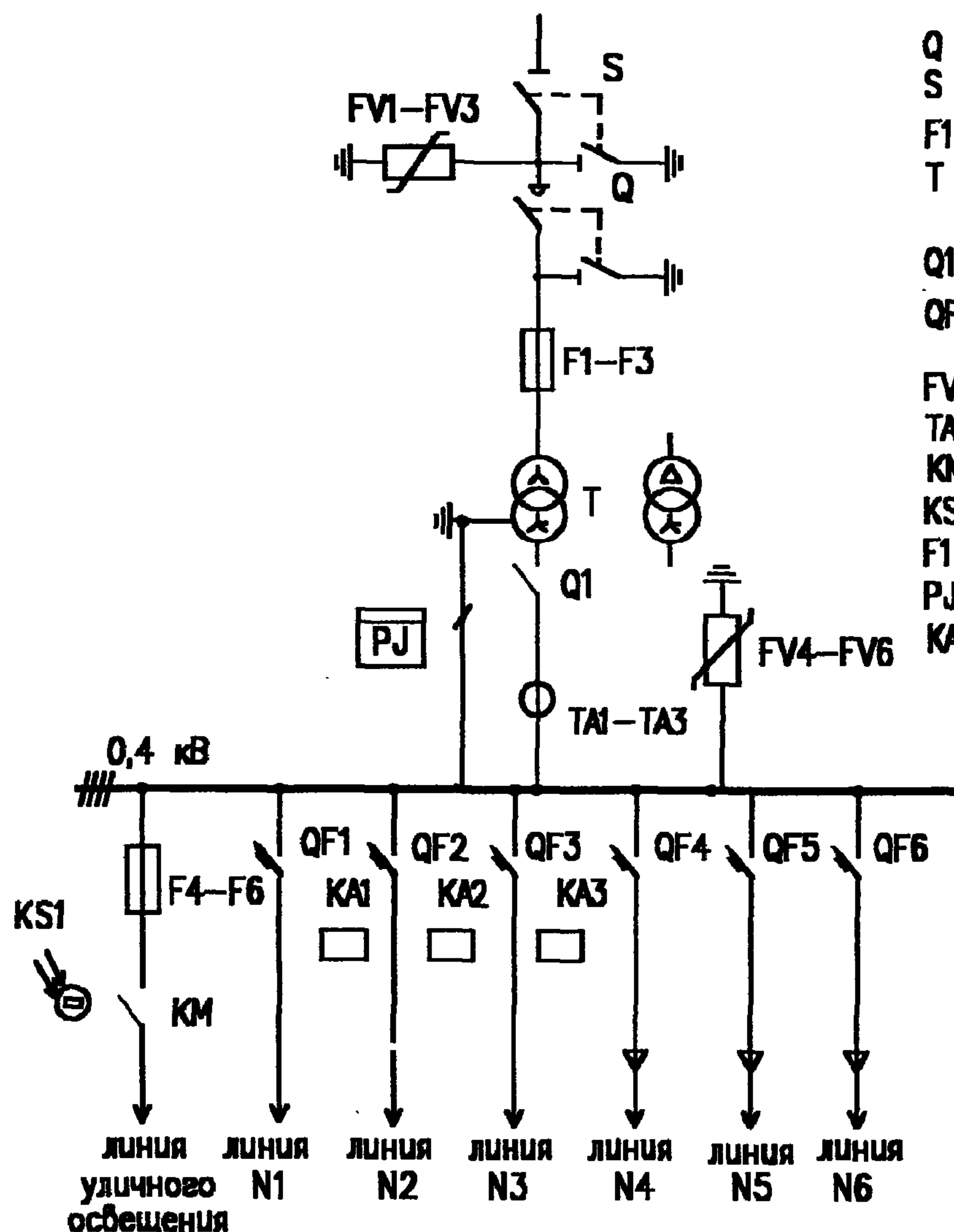
Q – выключатель нагрузки 10 кВ
