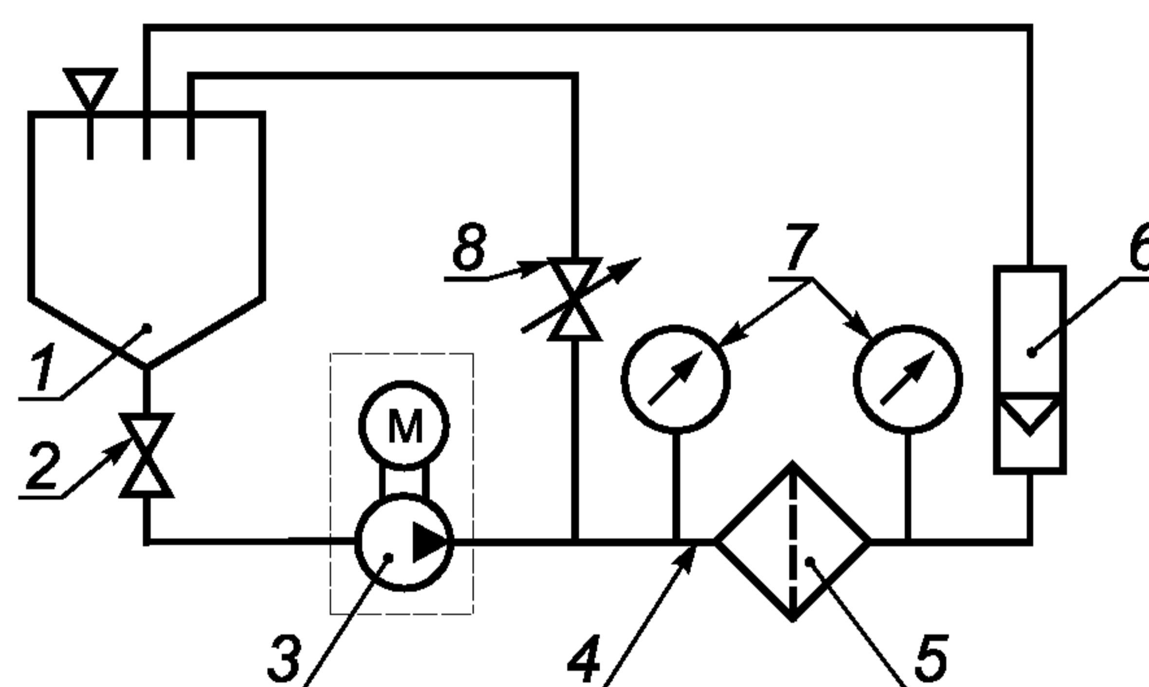
1 — расходный бак; 2, 8 — краны; 3 — насос; 4 — соединительные трубы и шланги; 5 — испытуемый фильтр; 6 — расходомер; 7 — манометры
