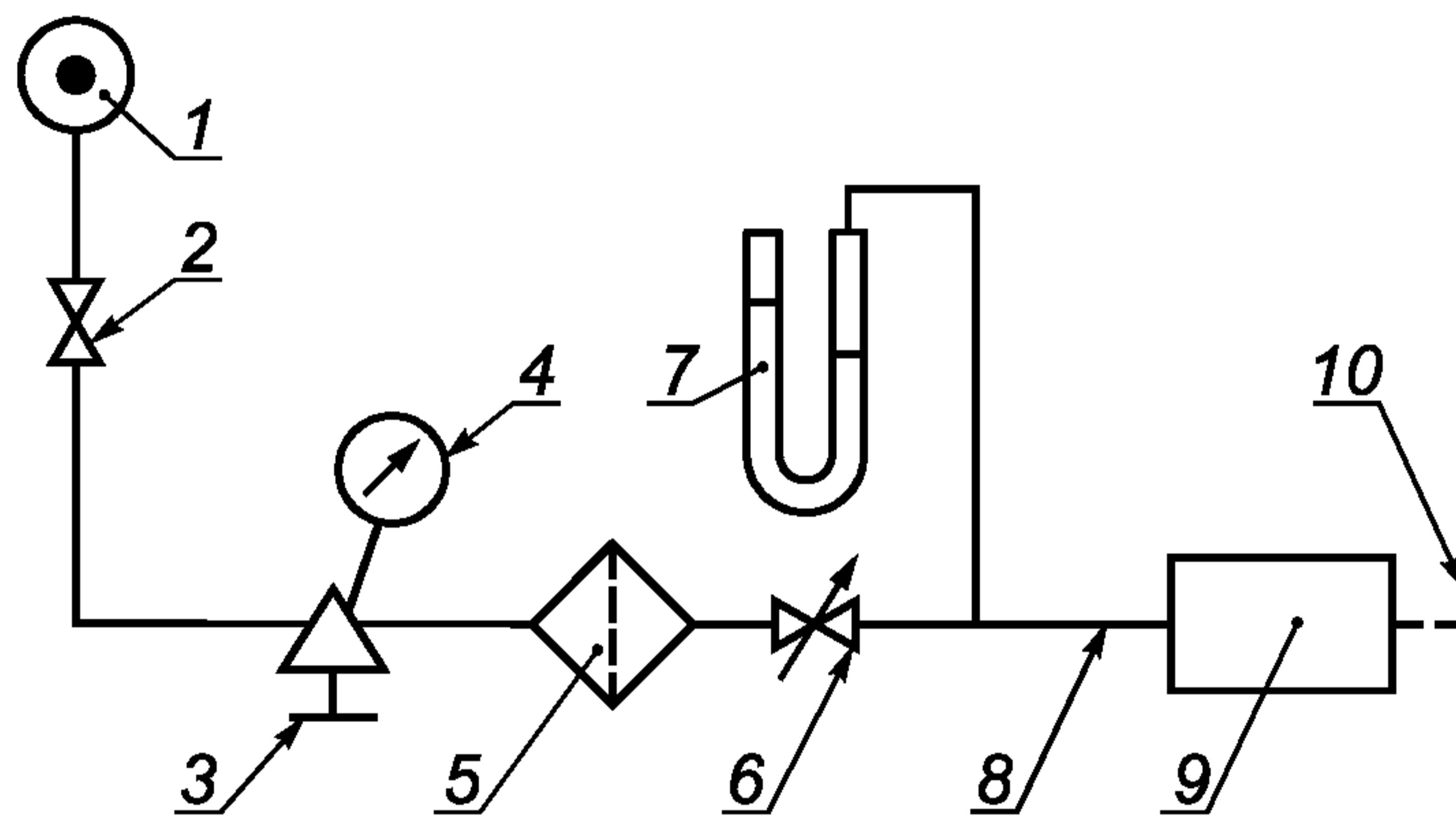
1 — соединение с источником сжатого воздуха; 2, 6 — краны; 3 — редуктор; 4 — манометр; 5 — технологический фильтр; 7 — жидкостный манометр; 8 — соединительные трубы и шланги; 9 — испытуемый фильтрующий элемент; 10 — заглушка
