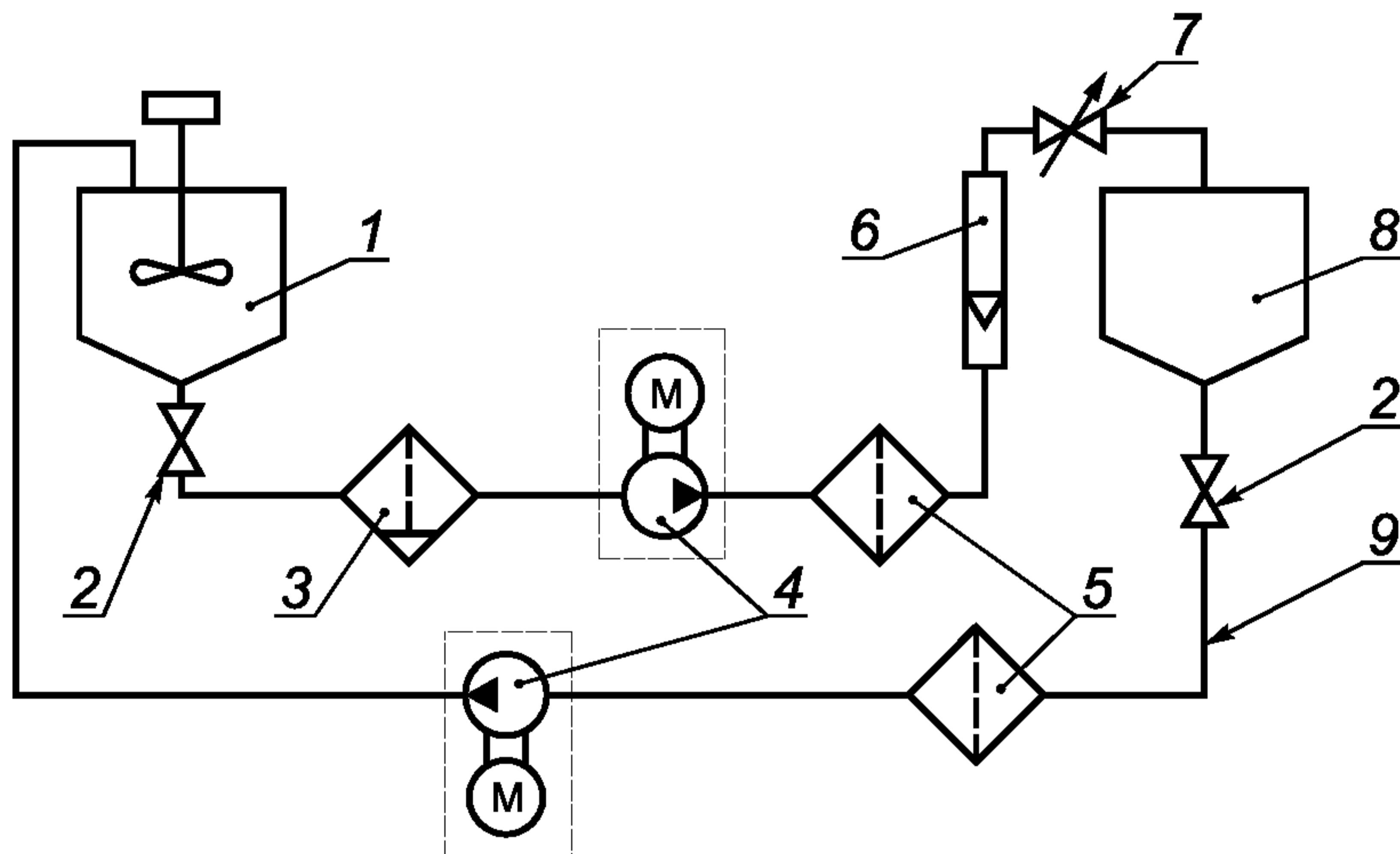
1 — расходный бак; 2, 7 — краны; 3 — испытуемый фильтр; 4 — насос; 5 — технологический фильтр; 6 — ротаметр; 8 — вспомогательный бак; 9 — соединительные трубы и шланги
