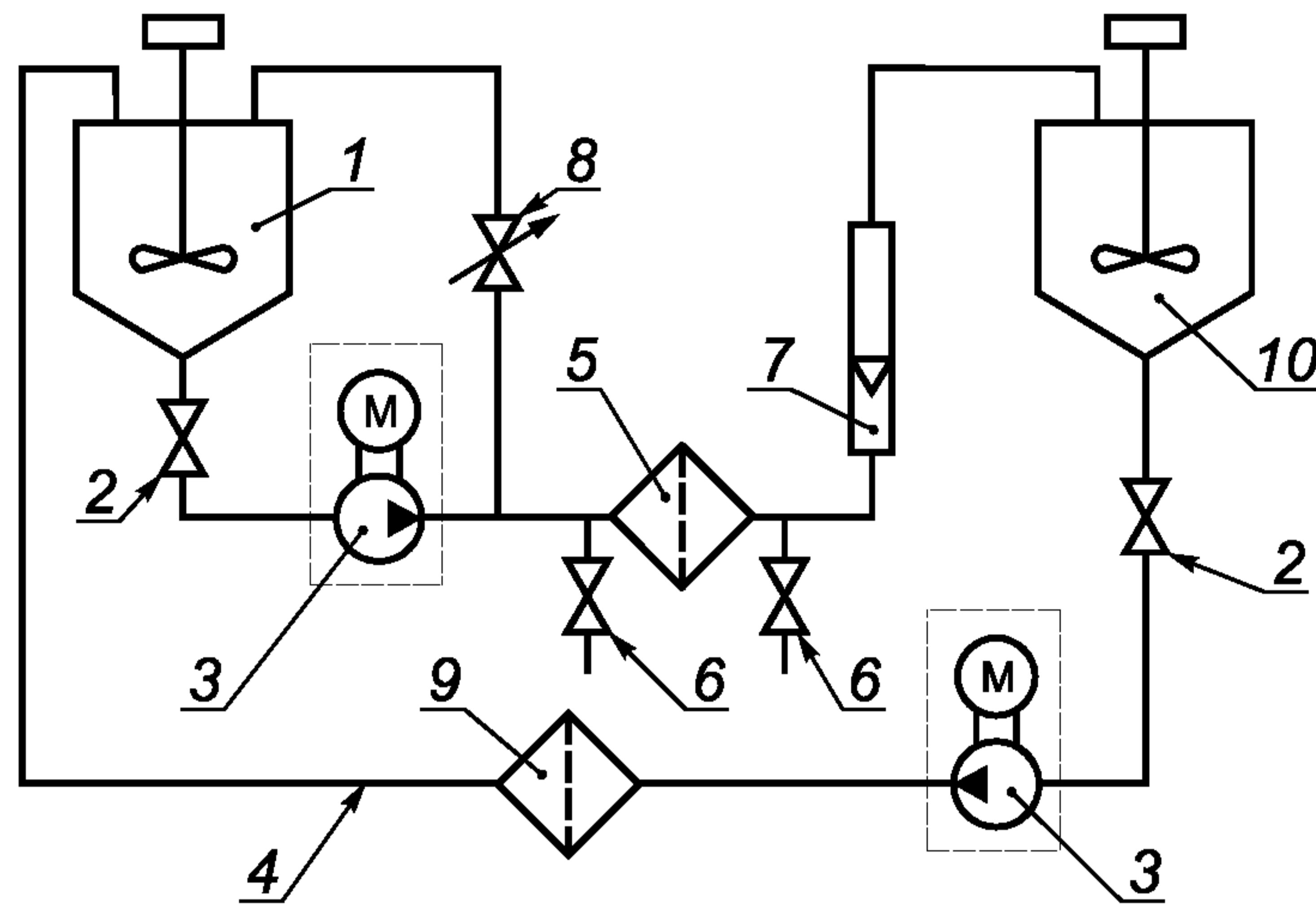
1 — расходный бак; 2, 8 — краны; 3 — насос; 4 — соединительные трубы и шланги; 5 — испытуемый фильтр; 6 — кран отбора проб; 7 — расходомер; 9 — технологический фильтр; 10 — вспомогательный бак
