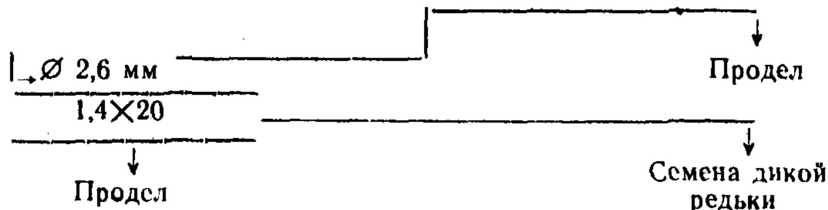
В зависимости от качества и крупности перерабатываемой гречихи размеры сит могут быть скорректированы.
