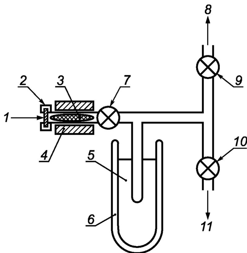
1 — инъекция пробы; 2 — мембранная перегородка; 3 — наполнитель из кварцевого волокна; 4 — нагревательная рубашка (электронагрев или нагрев горячей водой до температуры около 100 °С); 5 — ловушка для воды; 6 — емкость с твердой двуокисью углерода для охлаждения ловушки 5; 7 — вентиль I; 8 — к вакуумному насосу (п. 6.2.7); 9 — вентиль II; 10 — вентиль III; 11 — к емкости для восстановления воды (п. 6.2.11)
