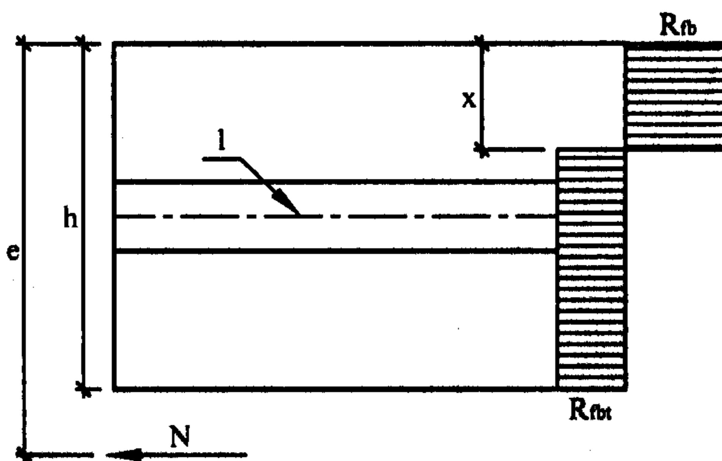
**Рис.7. Эпюры напряжений во внерадиально растянутых элементах прямоугольного сечения**
