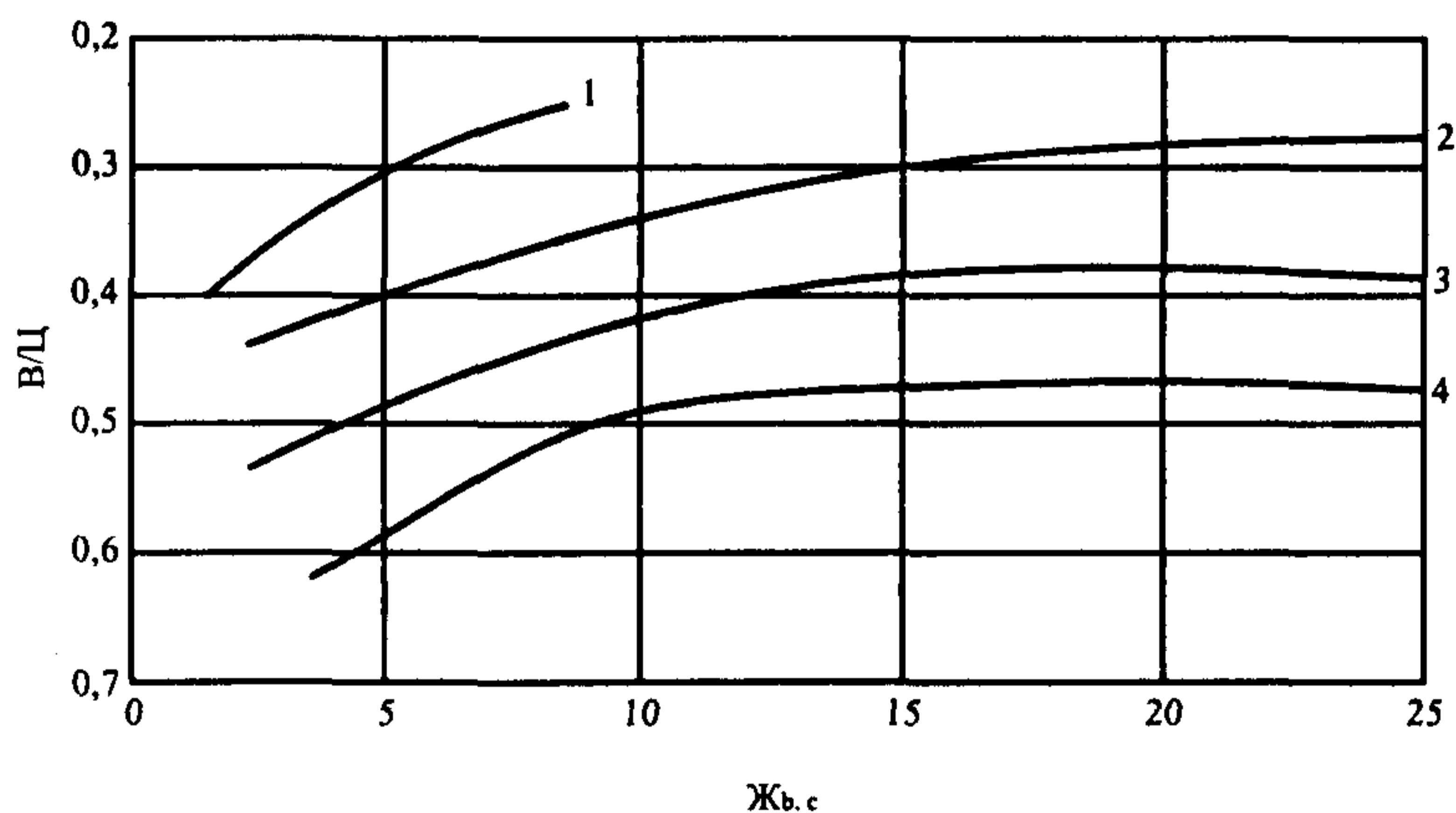
Рис. 1. Графики для подбора отношения Ц:П, обеспечивающего требуемую жесткость сталефибробетонной смеси в зависимости:
