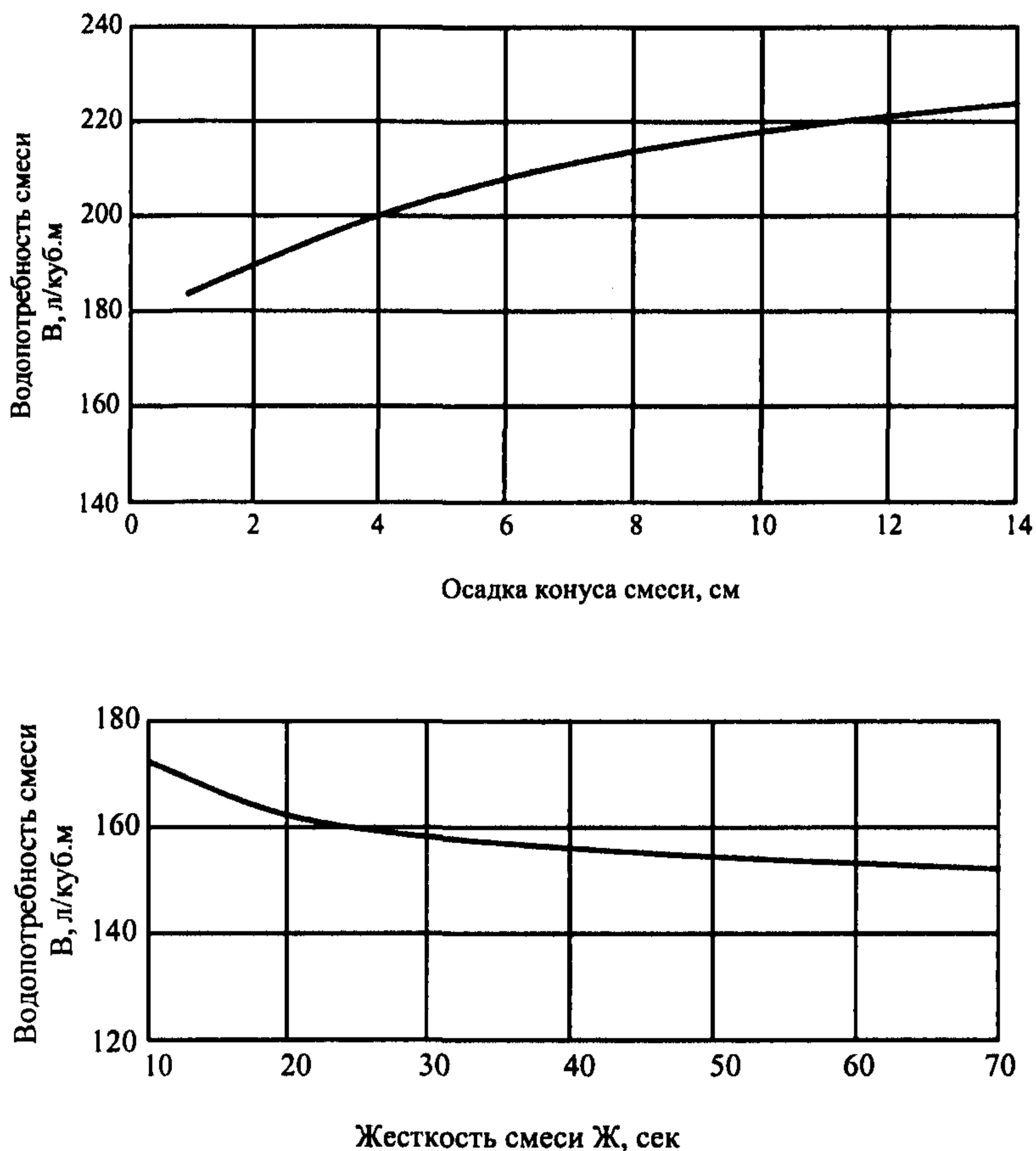
Рис. 3 График водопотребности пластичной (а) и жесткой (б) бетонной смеси
