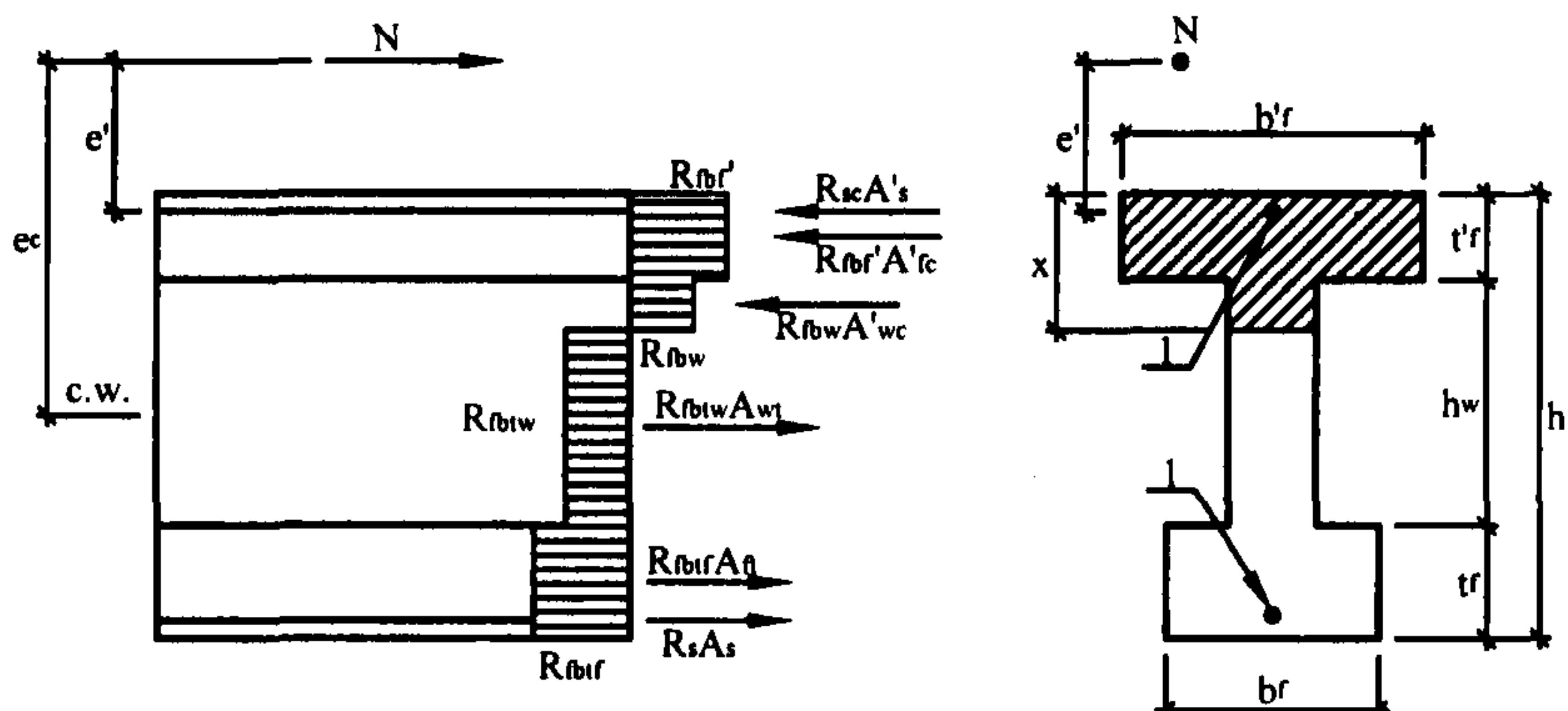
Рис.6. Схема усилий и эпюра напряжений во внерадиально сжатых элементах двутаврового сечения при комбинированном армировании при  $x > t'f$
