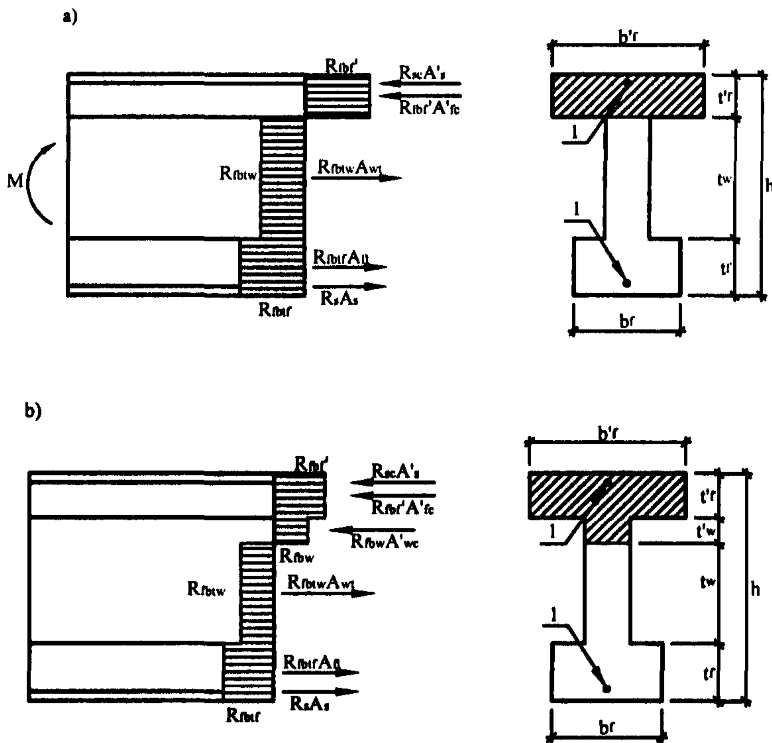
Рис.4. Схема распределения усилий и эпюра напряжений в сечениях, нормальных к продольной оси изгибающего элемента двутаврового сечения при комбинированном армировании
