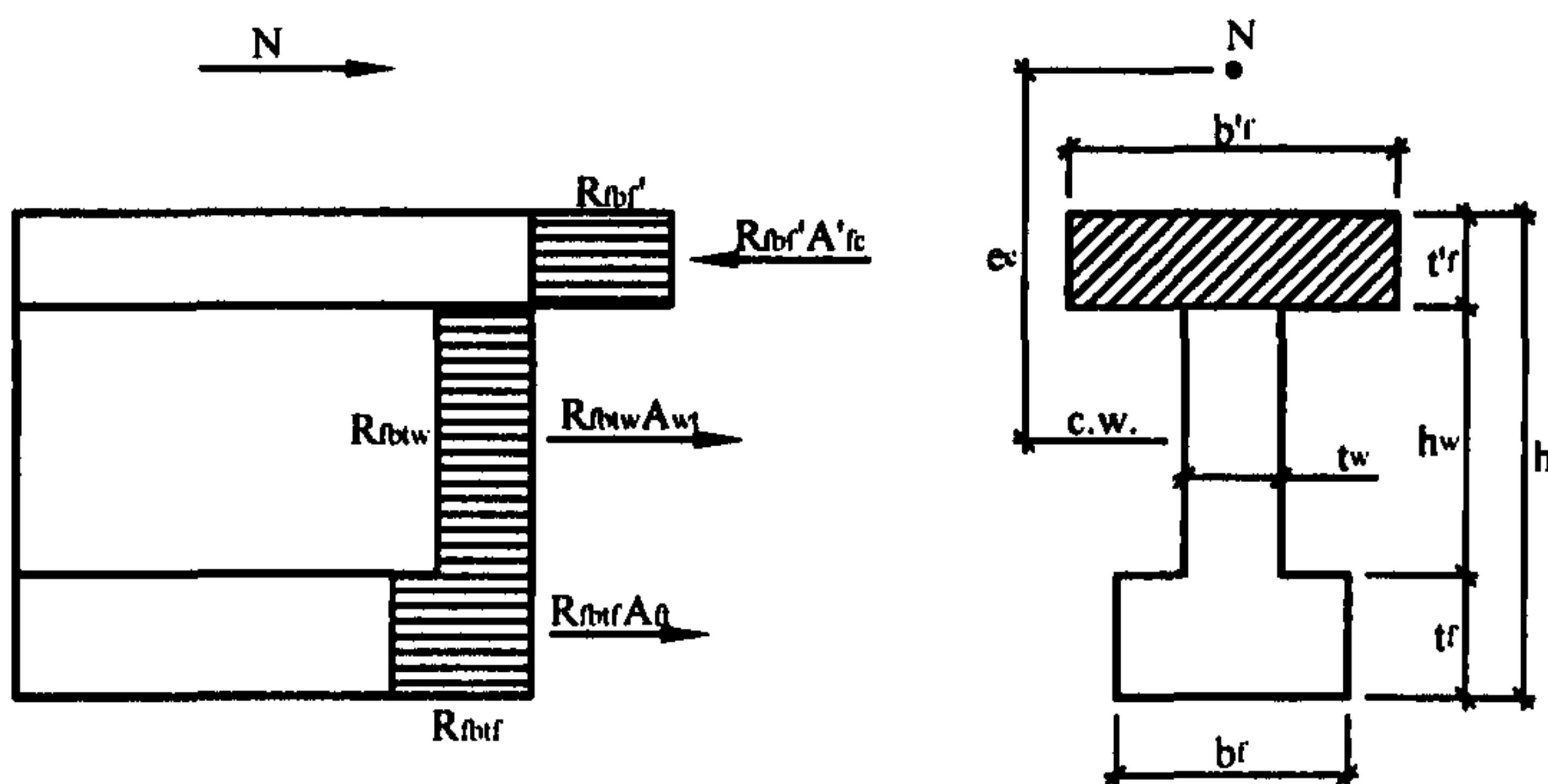
Рис.5. Схема усилий и эпюра напряжений во внерадиально сжатых элементах двутаврового сечения при фибровом армировании,  $x \leq t'f$
