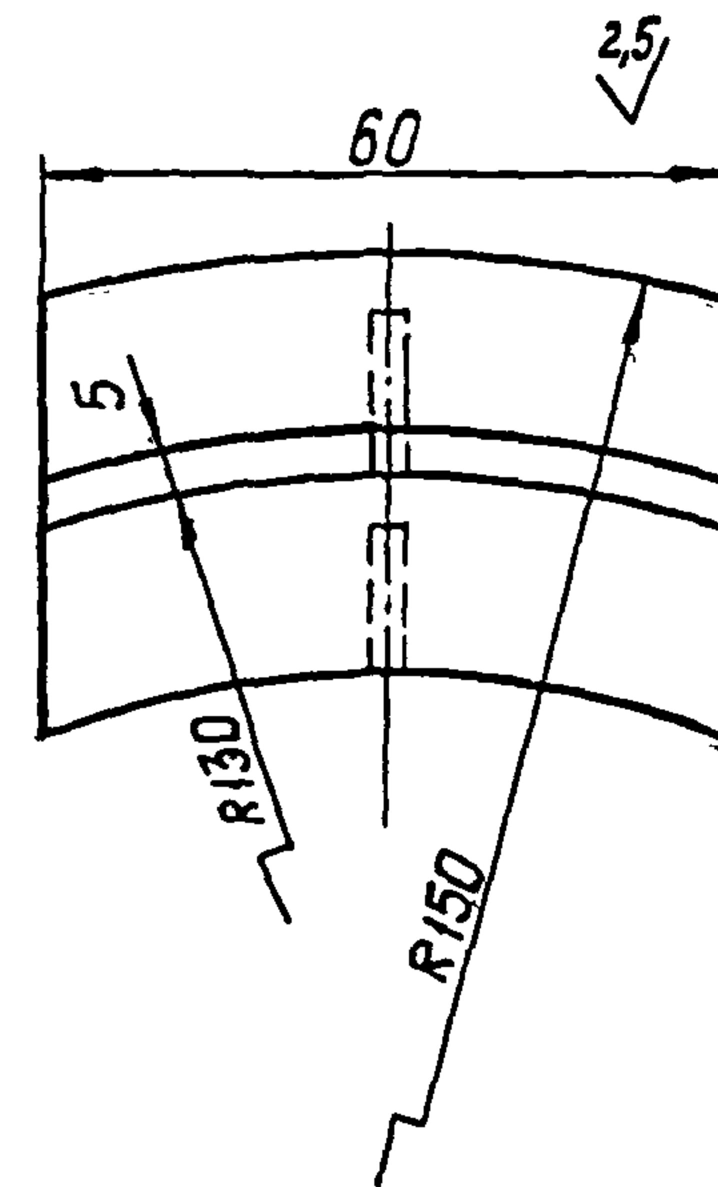
Аналогичные образцы применяются при контроле полых цилиндров с наружным диаметром менее 500 мм
