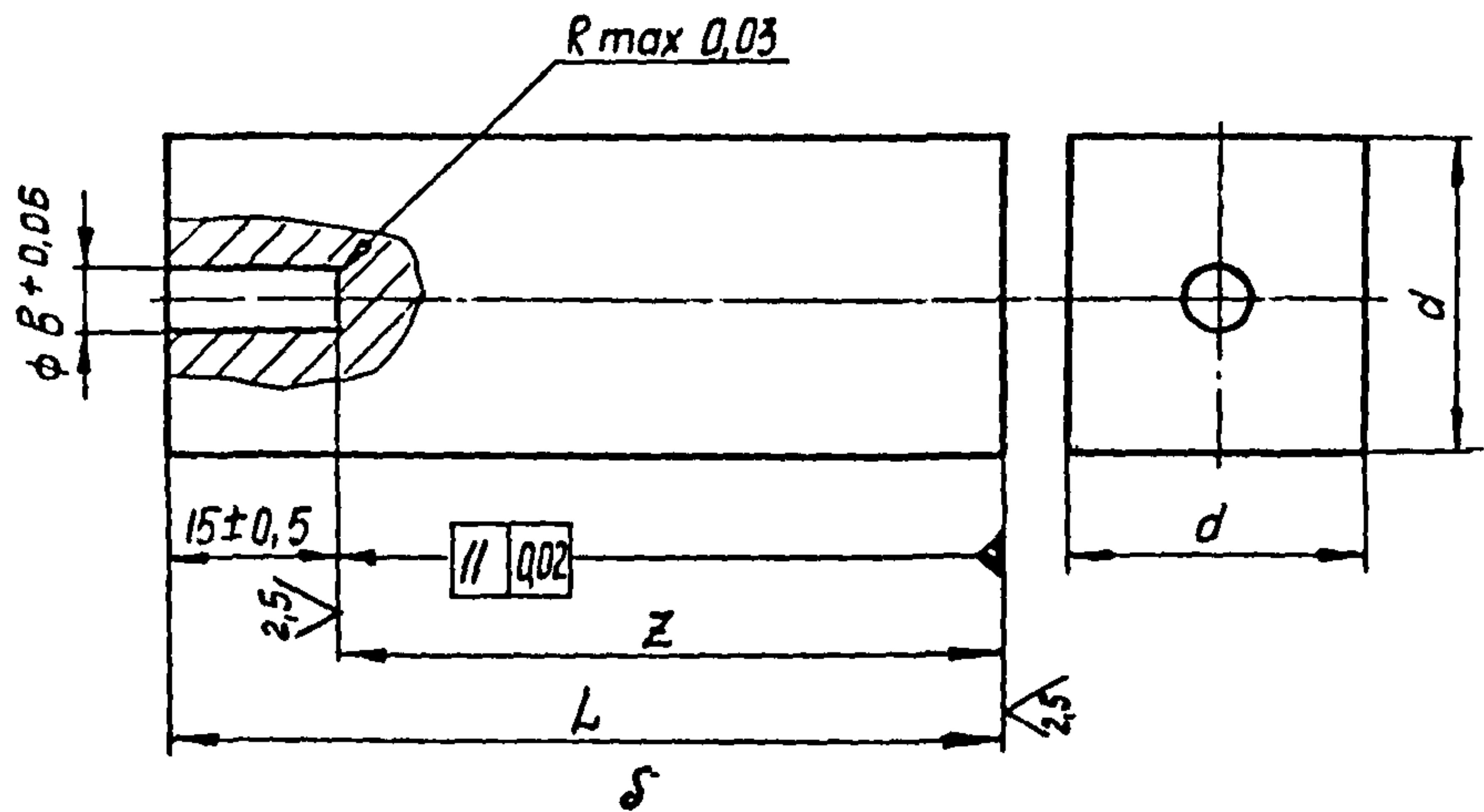
а - для контроля наклонным преобразователем
