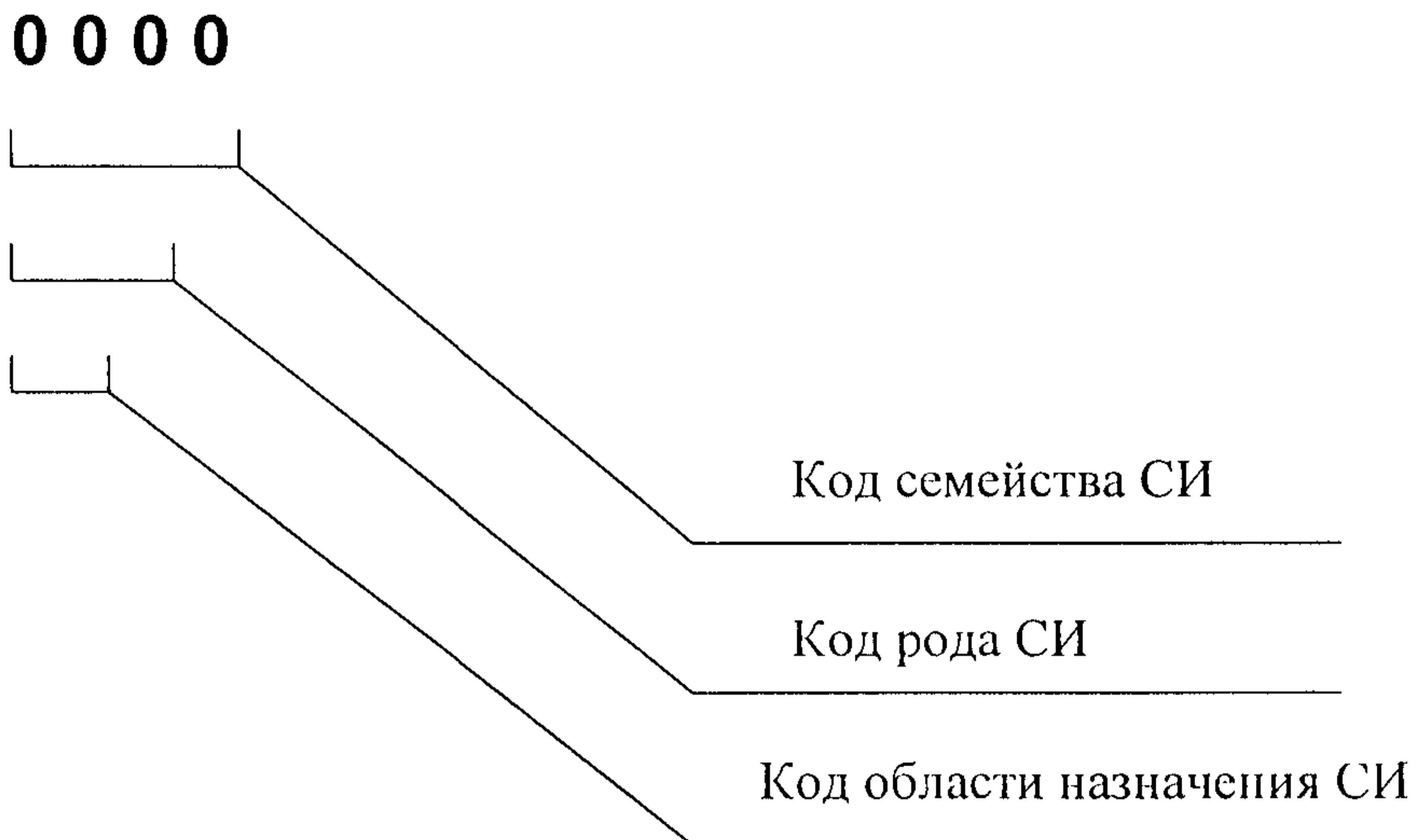
Рис.1 Структура кодов рубрик в систематизации СИ по областям назначения.
