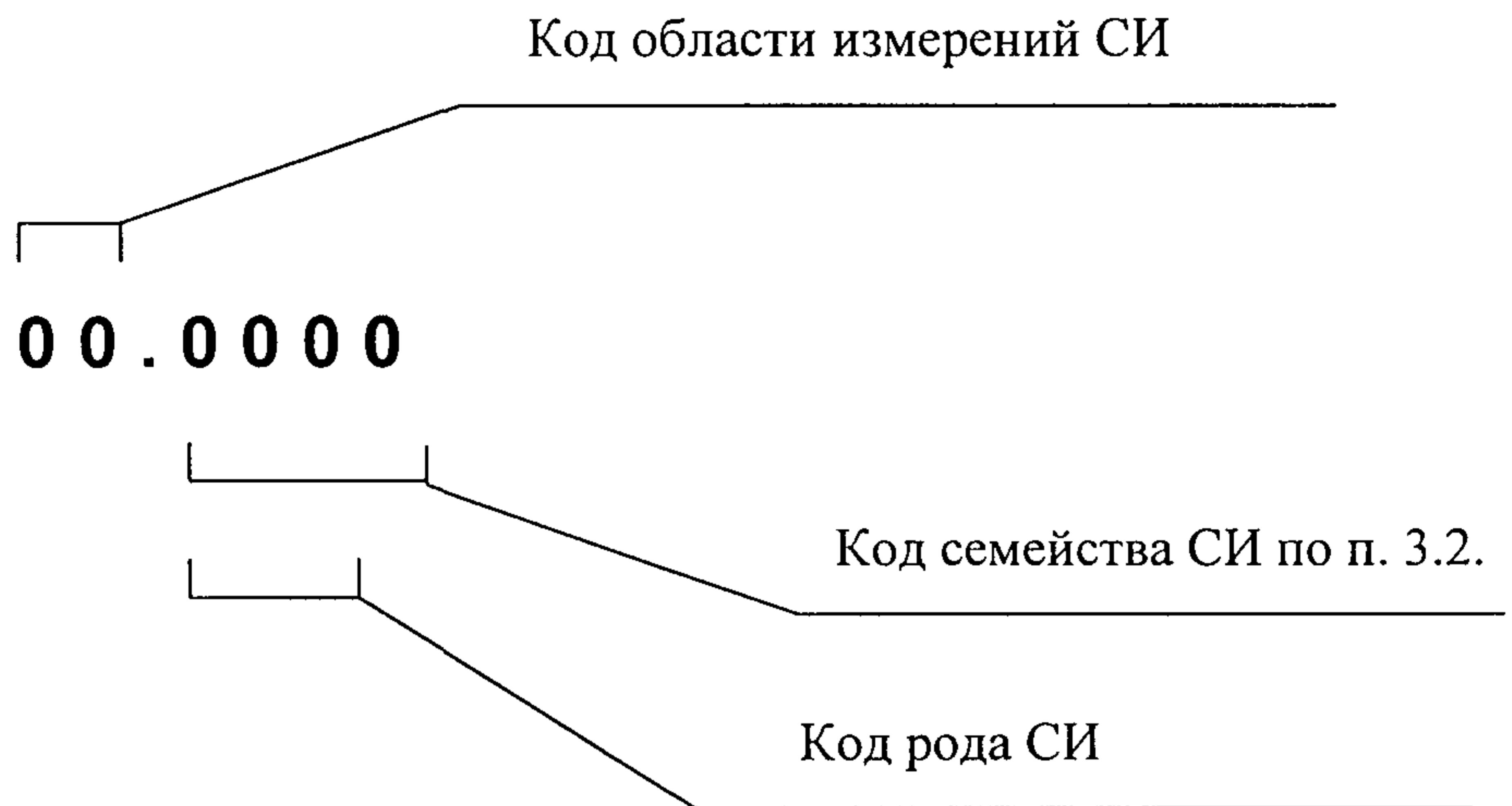
Рис.2 Структура кодов рубрик в систематизации СИ по областям измерений.
