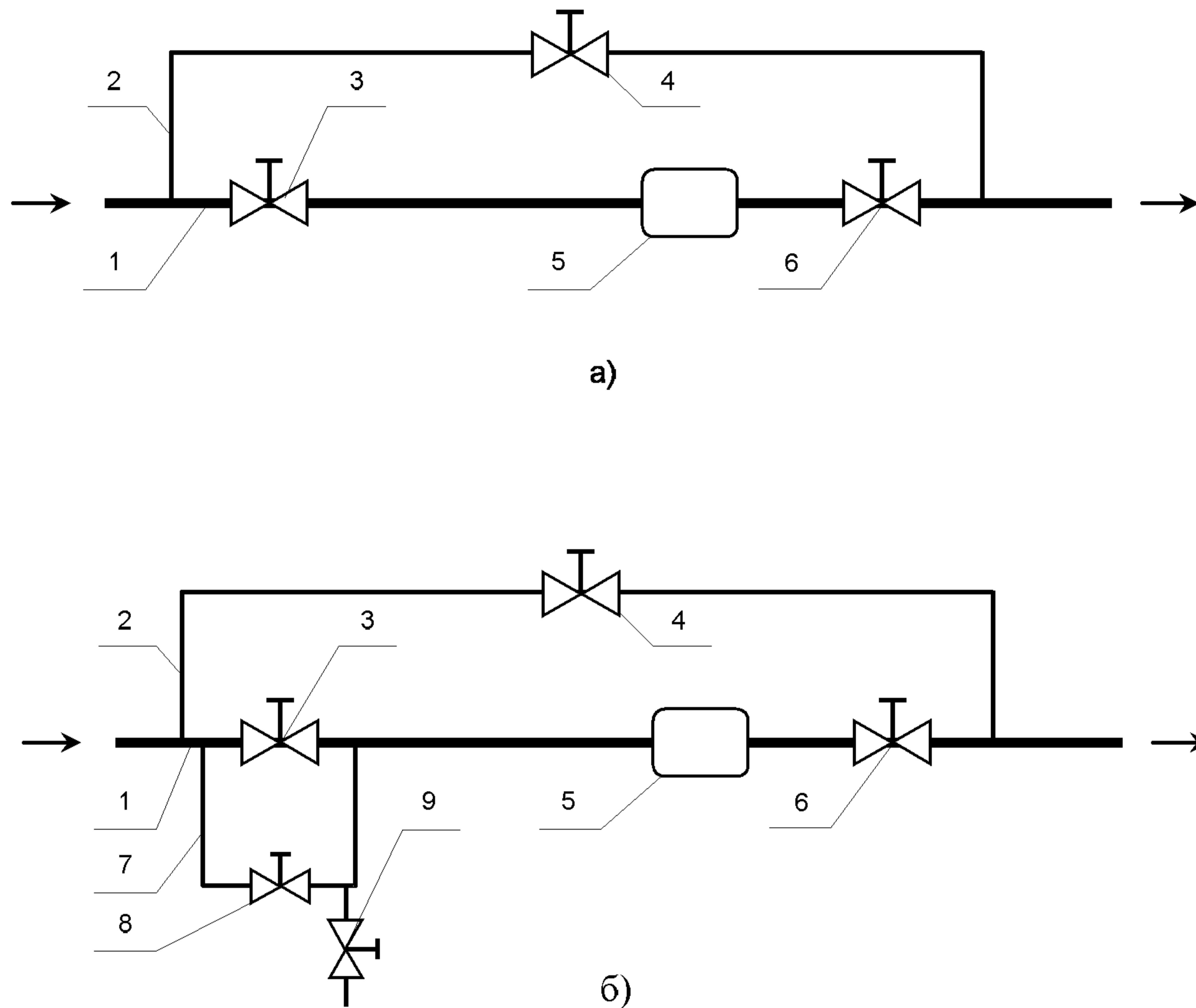
1 - трубопровод; 2 – байпас; 3 ,6 –до и после ПР; 4- запорная арматура байпasa; 5 – ПР; 7 – перепускной канал; 8,9 - запорная арматура для повышения и понижения давления.
