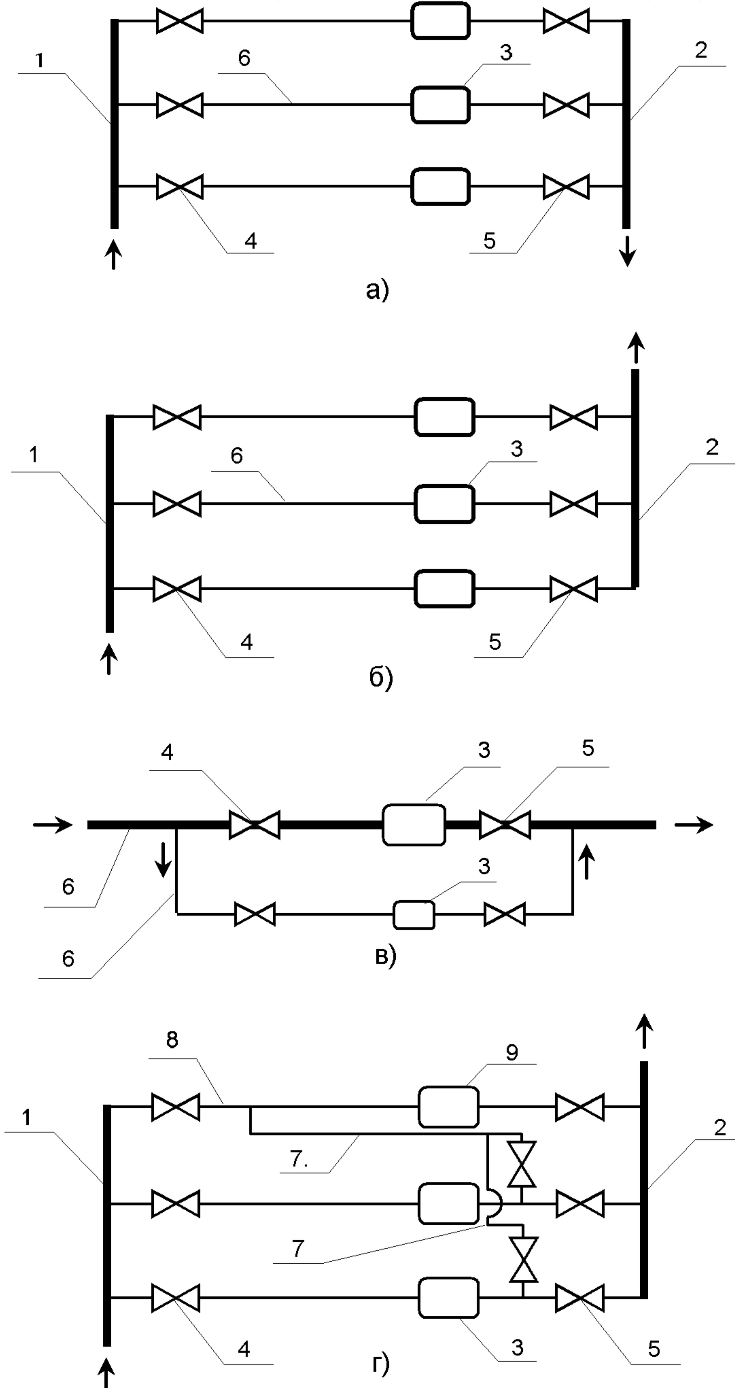
1 – входной коллектор; 2 – выходной коллектор; 3 – ПР; 4,5 – запорная арматура до и после ПР; 6- измерительный трубопровод; 7 – перепускной трубопровод; 8 - трубопровод с контрольным ПР; 9 – контрольный ПР
