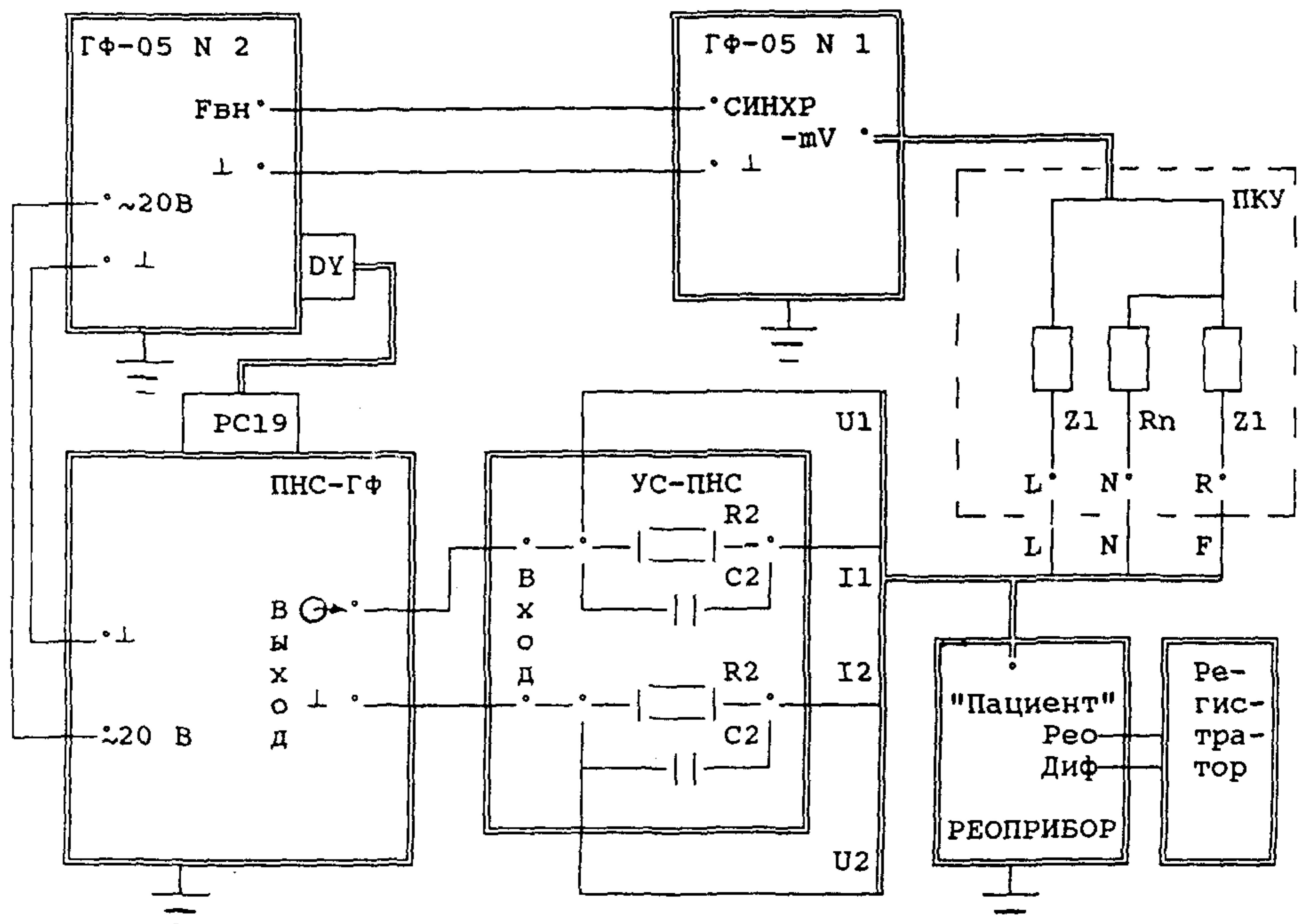
Пояснения к рисунку: ПКУ-поверочное коммутационное устройство ПКУ-ЭКГ ( $Z_1$  – параллельно соединенные  $R_1 = 51 \text{ кОм} +/- 5\%$  и  $C_1 = 47 \text{ нФ} +/- 10\%$ ,  $R_n = 100 \text{ Ом} +/- 5\%$ ).
