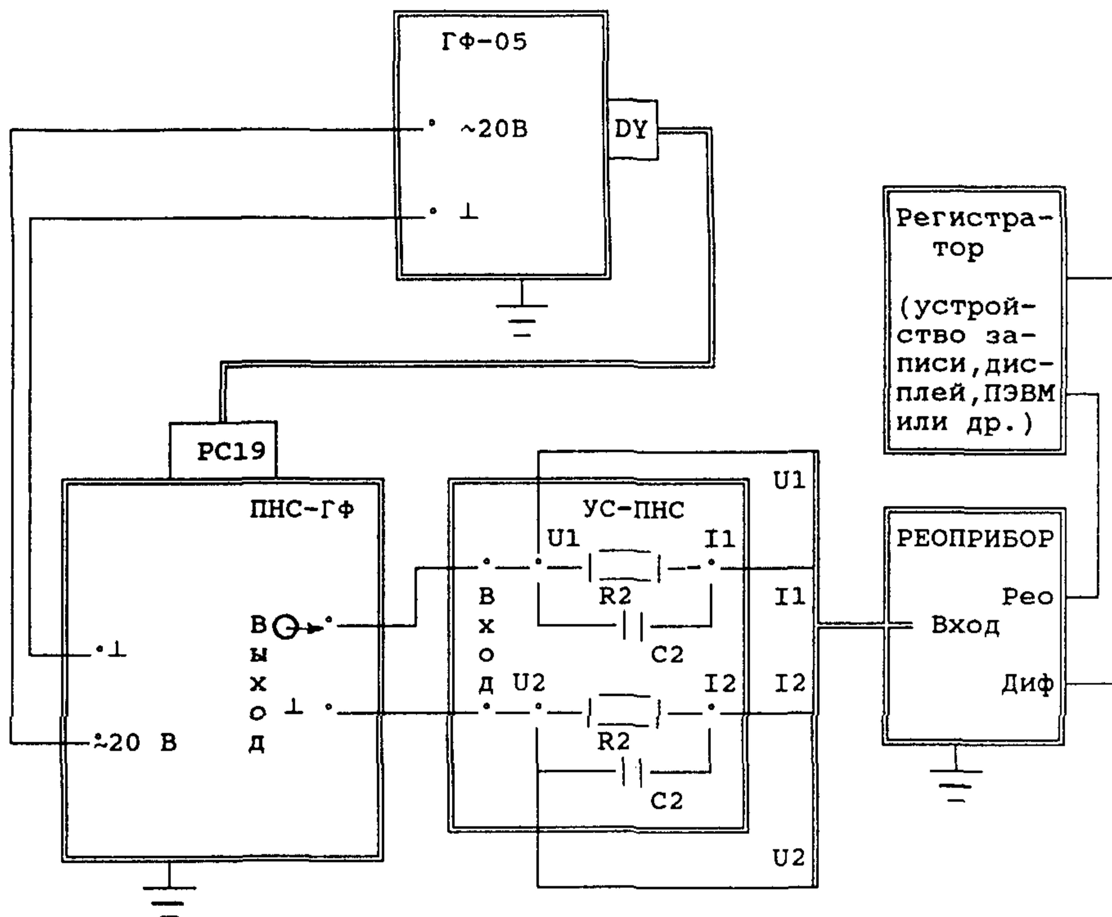
Пояснения к рисунку : УС-ПНС - устройство согласования ПНС-ГФ;  $R_2 = 82 \Omega \pm 10\%$ ;  $C_2 = 1/6,28*f*R_2 \pm 20\%$ , где  $f$  - частота зондирующего тока реоприбора.
