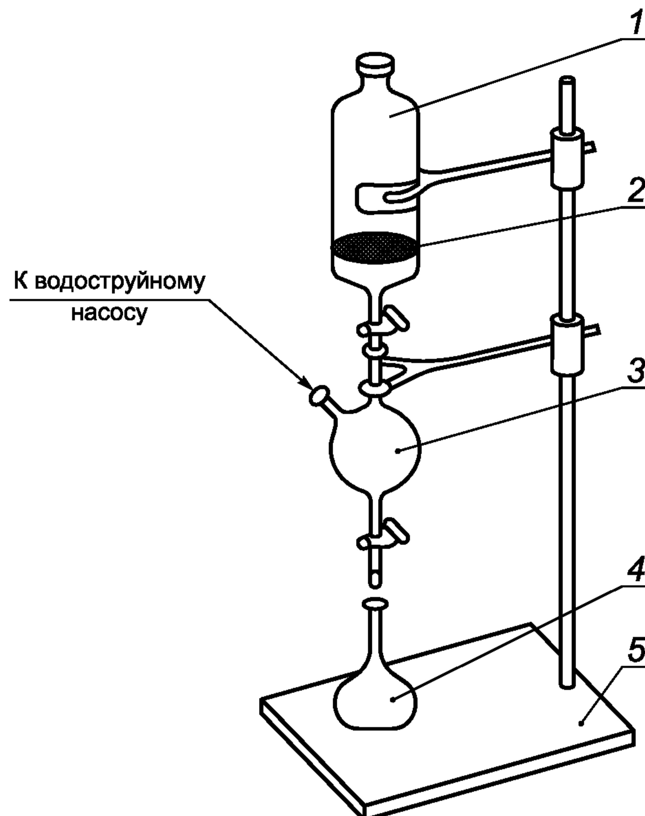
1 — фильтрующая делительная воронка; 2 — стеклянный впаянnyй фильтр; 3 — приемник; 4 — мерная колба вместимостью 50 см<sup>3</sup>; 5 — штатив
