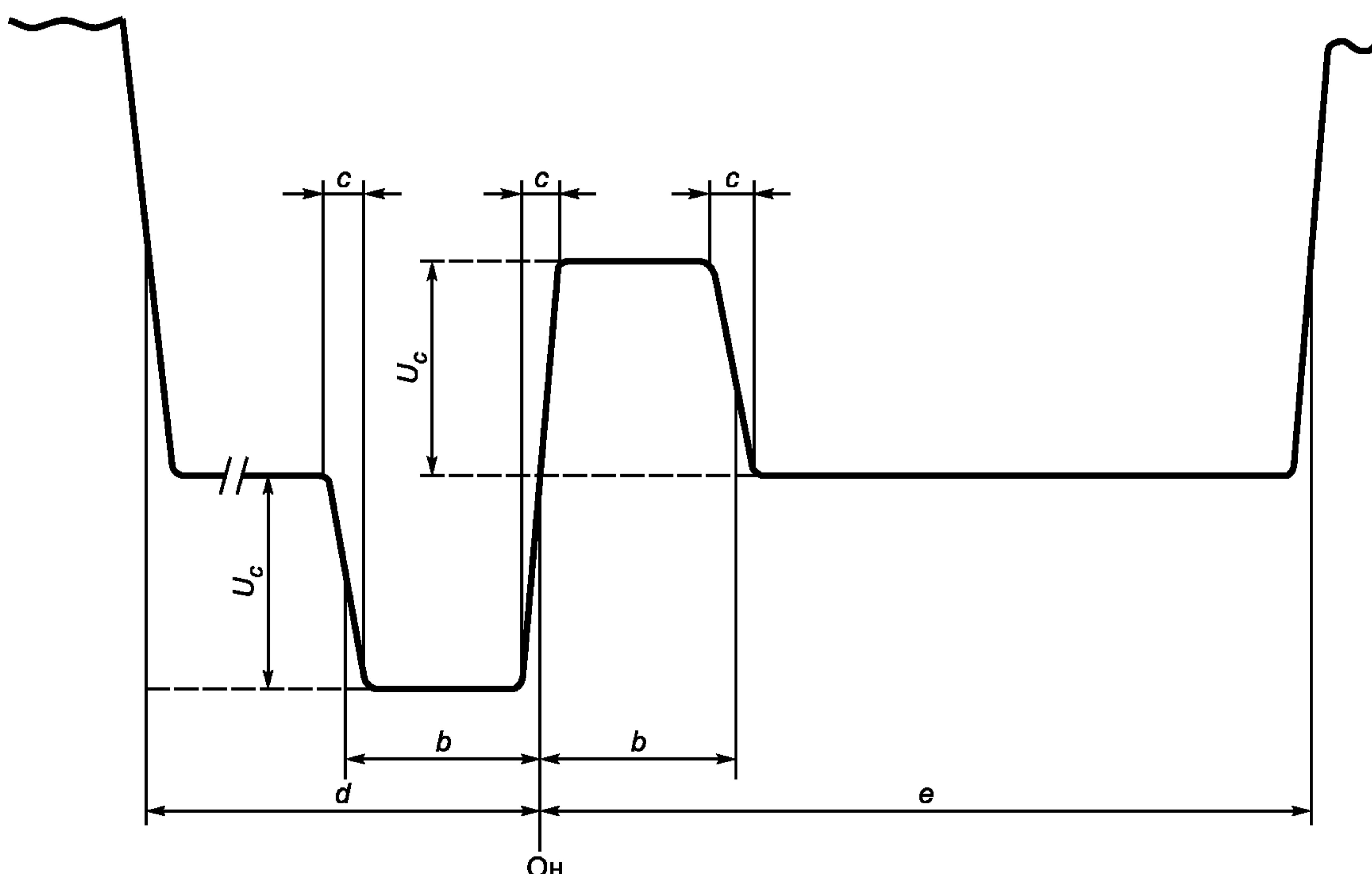
Рисунок 3 — Структура сигнала синхронизации на интервале гашения строки
