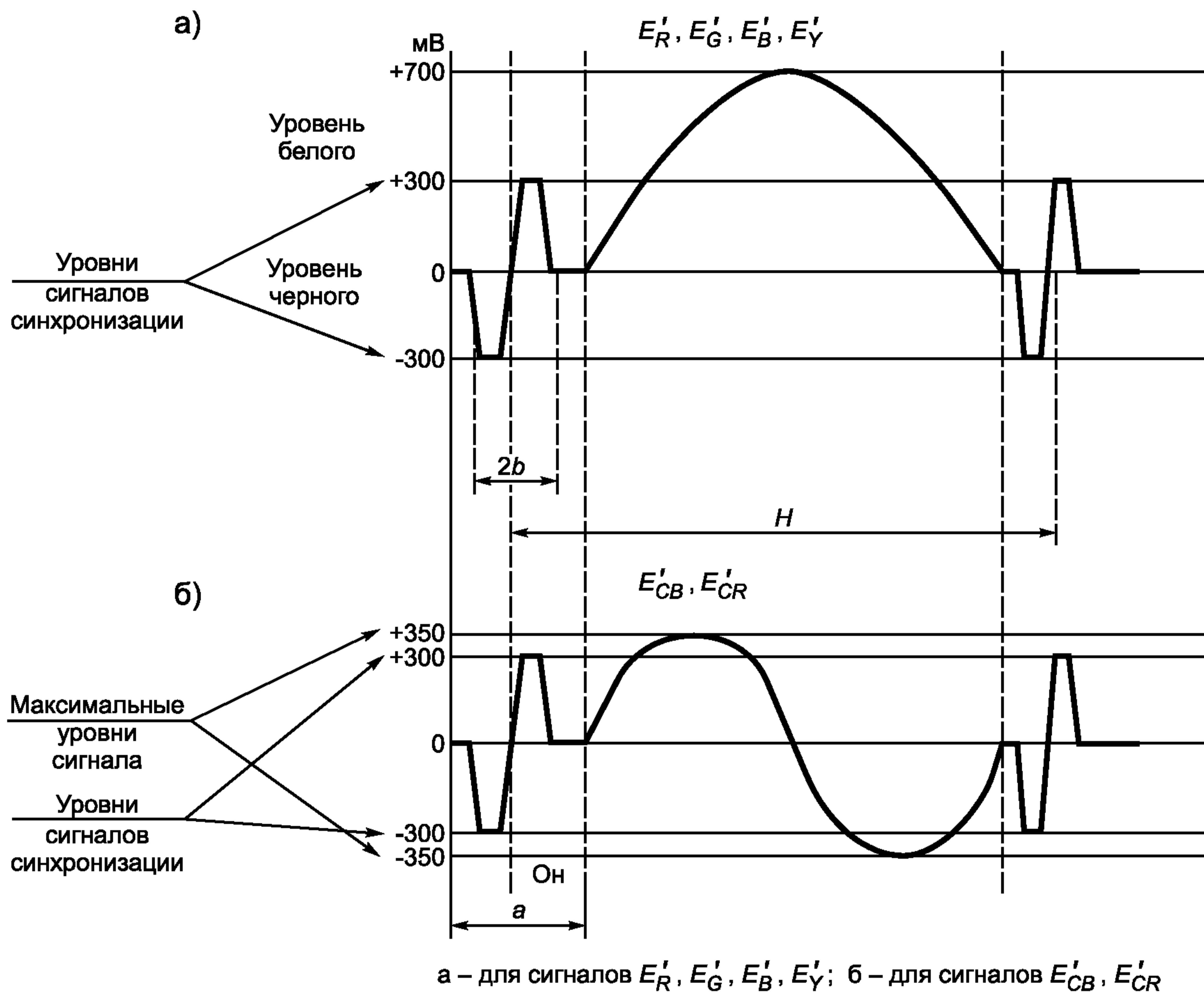
Рисунок 2 — Структура компонентных сигналов на интервале строки
