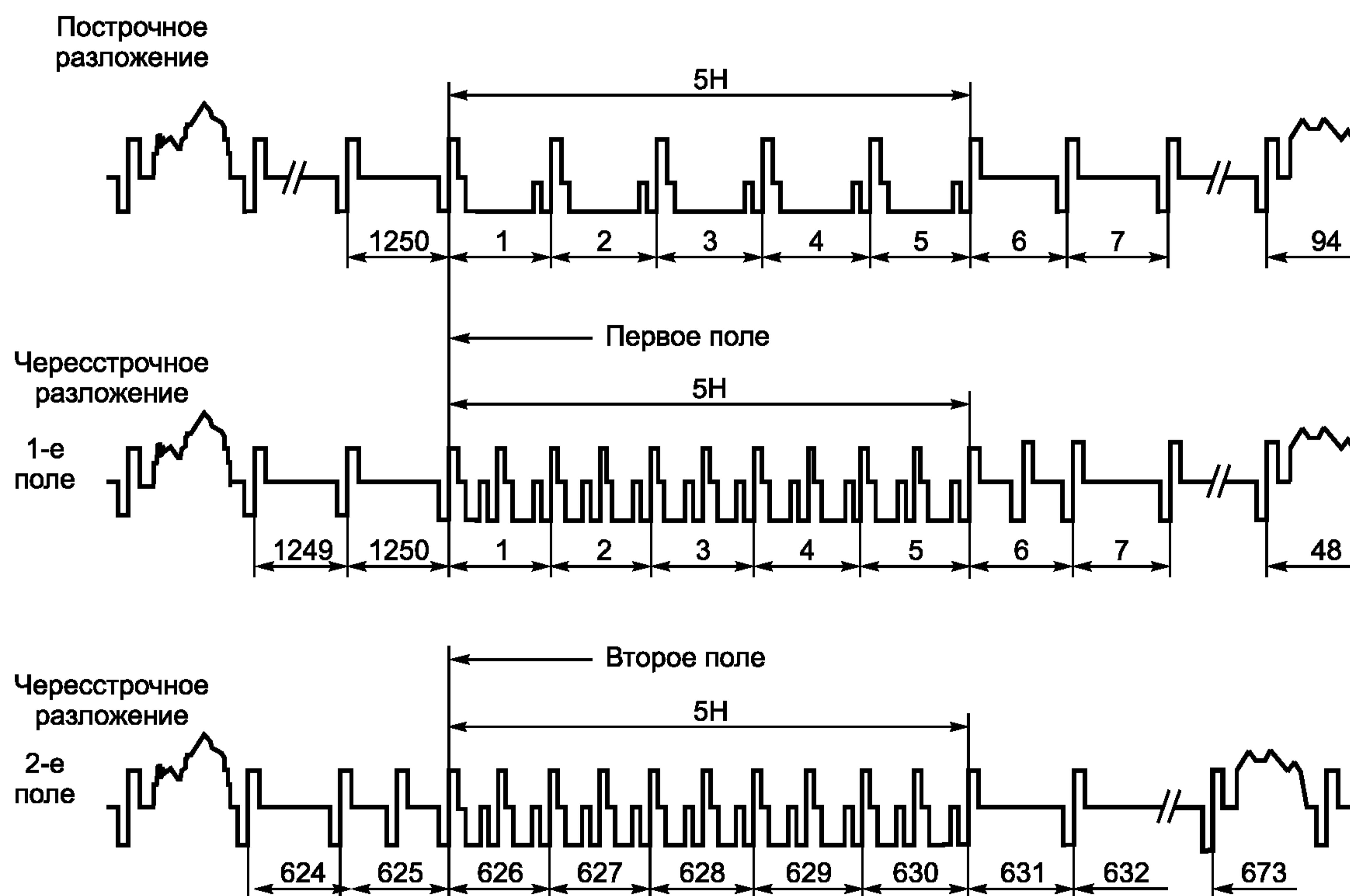
Рисунок 4 — Структура синхросигнала на интервале гашения поля
