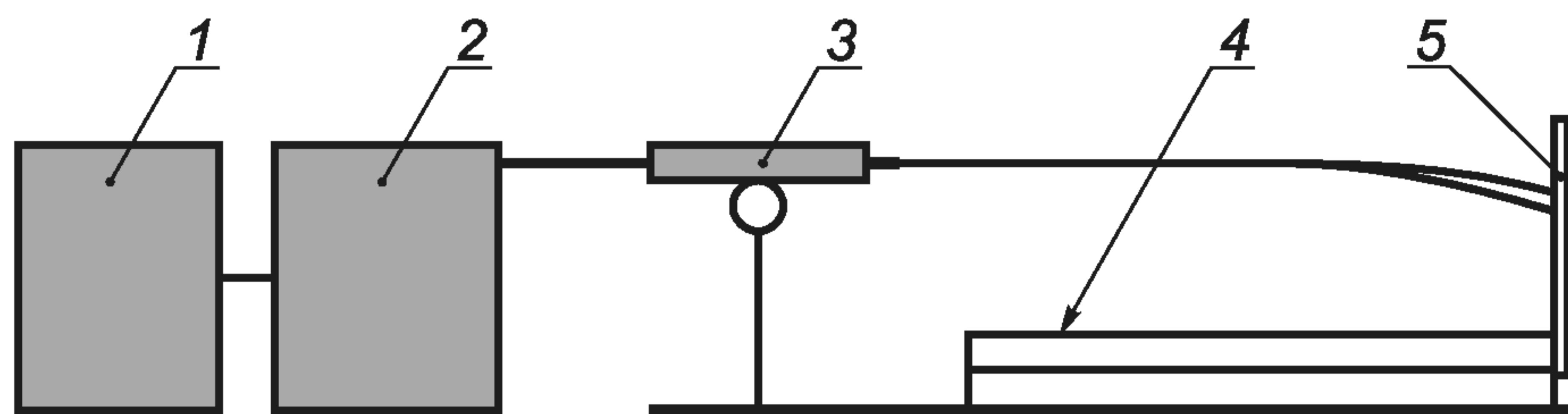
1 — емкость с пенообразователем; 2 — насосная установка; 3 — пенный ствол;
