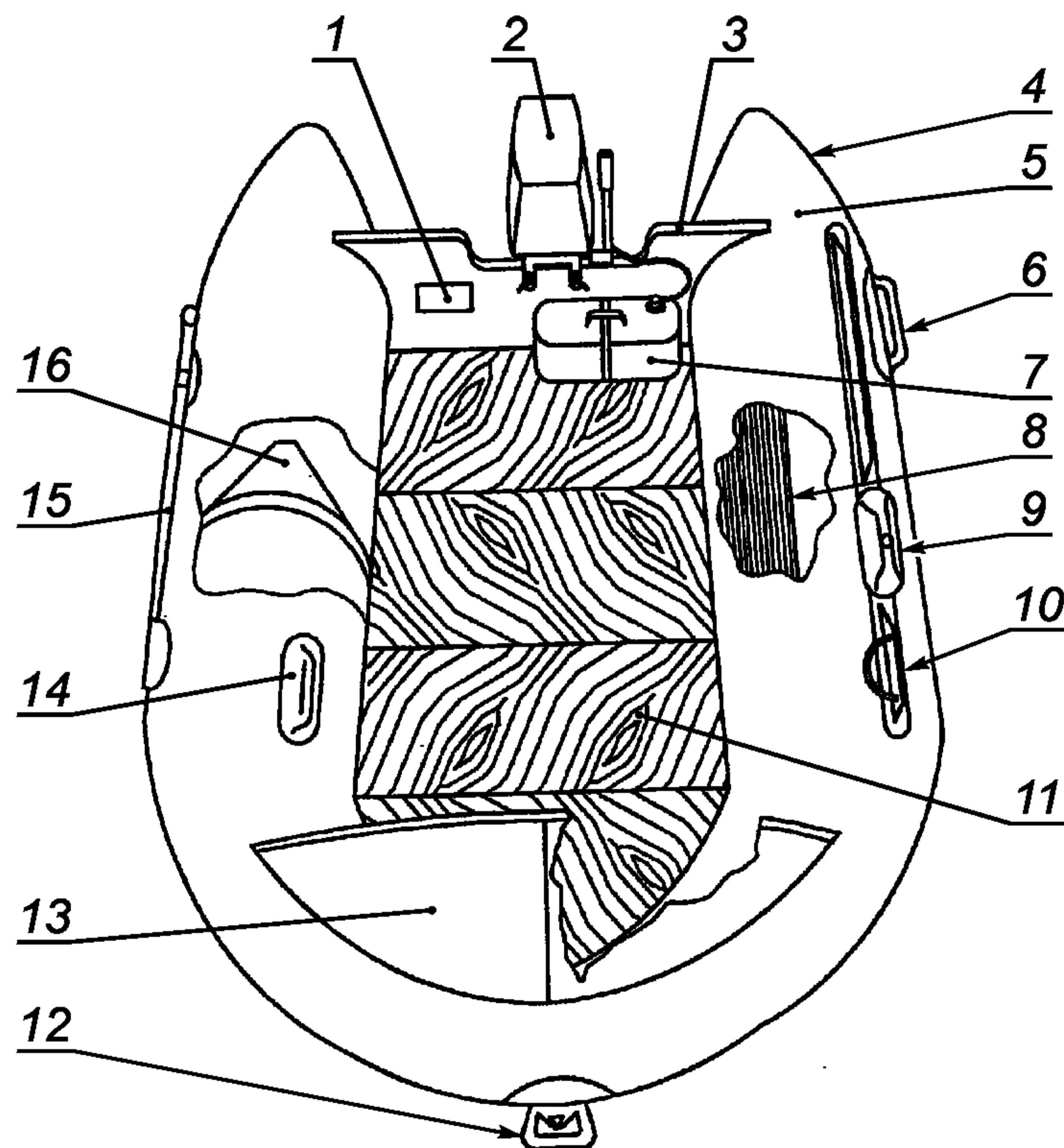
1 — информационная планка; 2 — мотор; 3 — транец; 4 — воздушный клапан наполнения; 5 — надувной корпус, включающий несколько отсеков плавучести; 6 — подъемное/переносное устройство; 7 — топливный бак; 8 — разделительная перегородка. Пример сечения: 9 — уключина; 10 — предохранительный или спасательный леер; 11 — внутреннее пространство судна; 12 — устройство для буксировки; 13 — брызгозащитный щиток; 14 — ручка; 15 — весло; 16 — разделительная перегородка (пример поперечного сечения)
