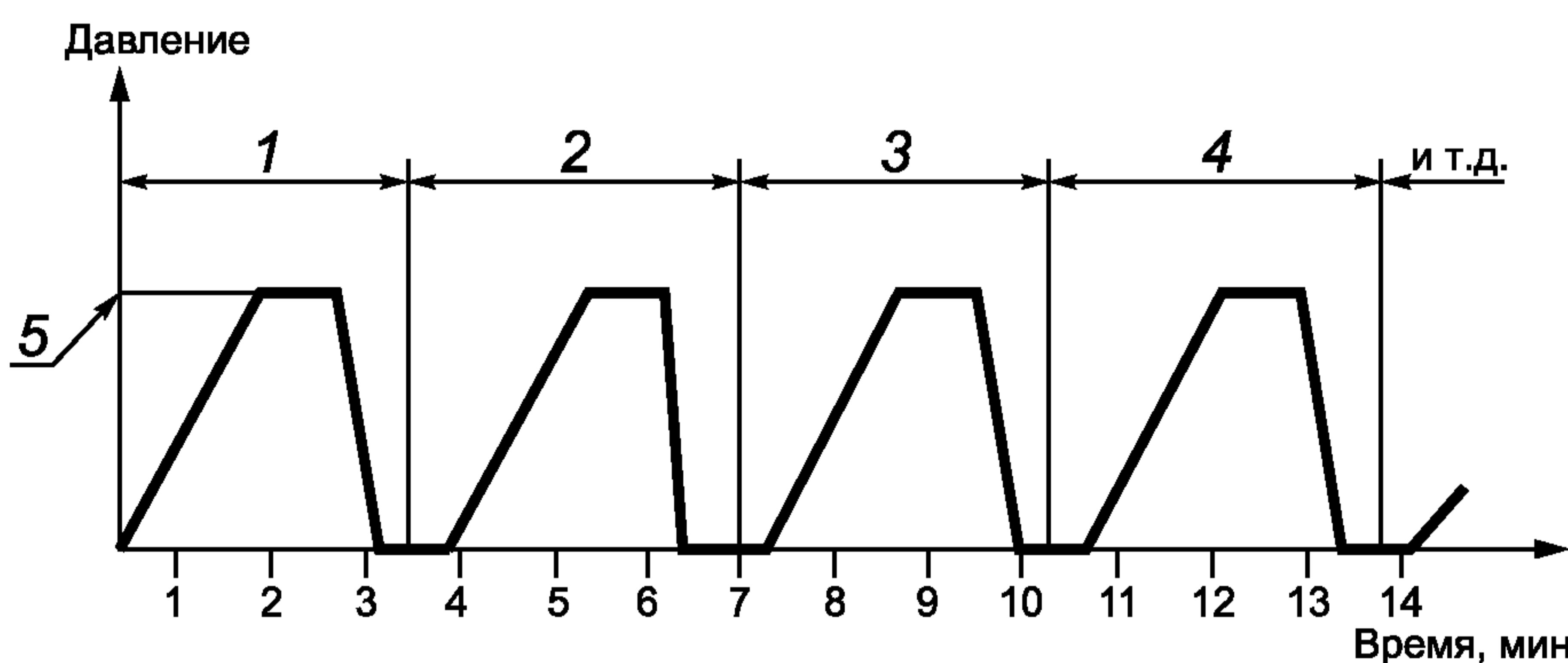
1 — отсек 1; 2 — отсек 2; 3 — отсек 1; 4 — отсек 2; 5 — проектное рабочее давление
