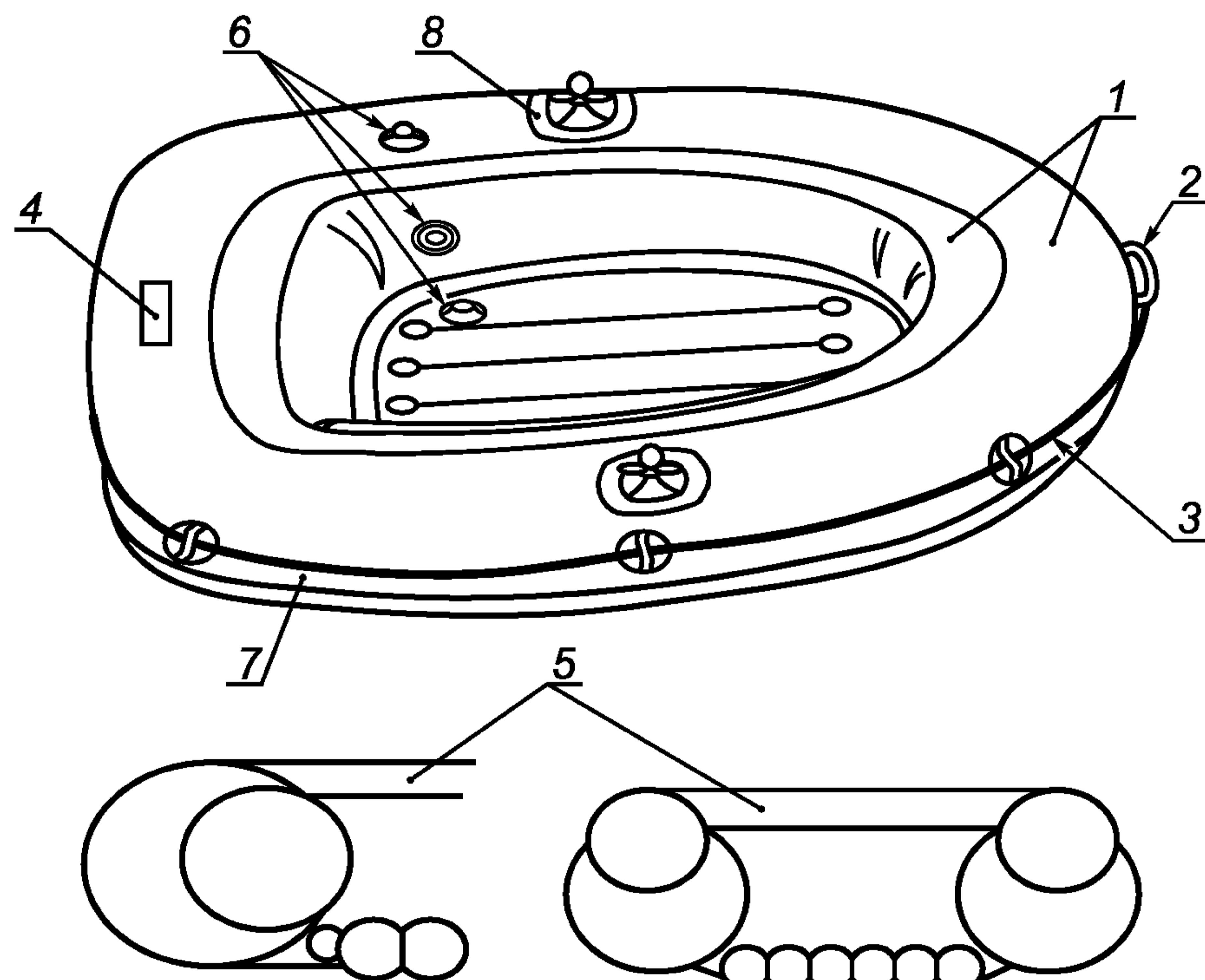
1 — камеры плавучести; 2 — устройство для буксировки; 3 — предохранительный или спасательный леер; 4 — информационная планка; 5 — пример сечения; 6 — воздушный клапан наполнения; 7 — подъемное/переносное устройство; 8 — уключина
