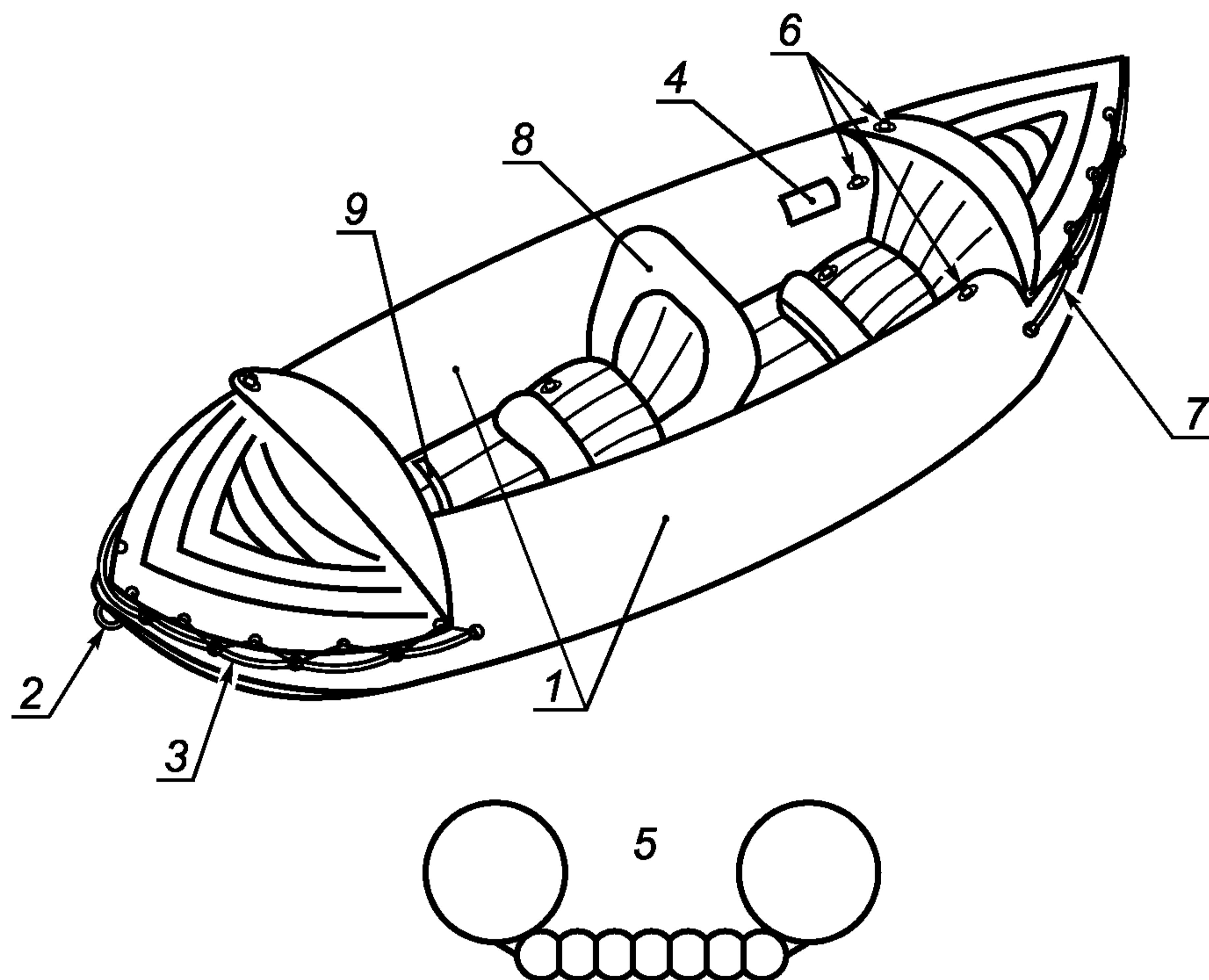
1 — камеры плавучести; 2 — устройство для буксировки; 3 — предохранительные или спасательные леера; 4 — информационная планка; 5 — пример сечения; 6 — воздушный клапан наполнения; 7 — подъемное/переносное устройство; 8 — спинка сидения; 9 — подставка для ног
