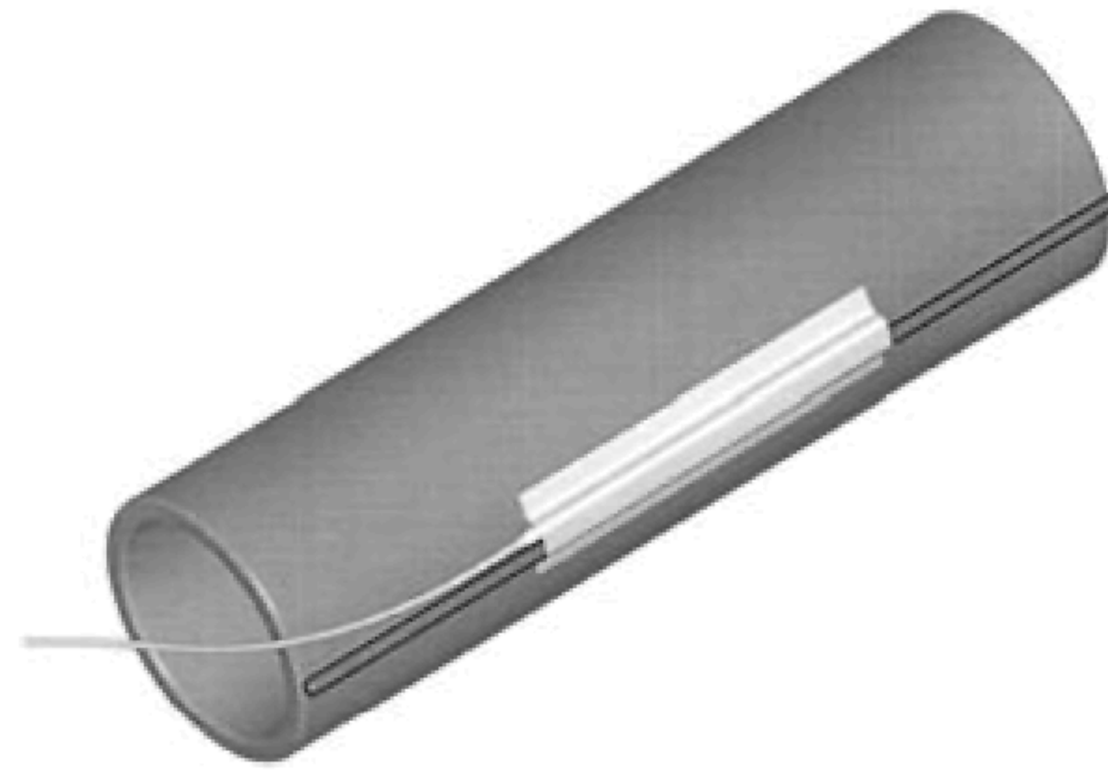
Рисунок 8 — Датчик ограничителя температуры на поверхности электронагревателя
