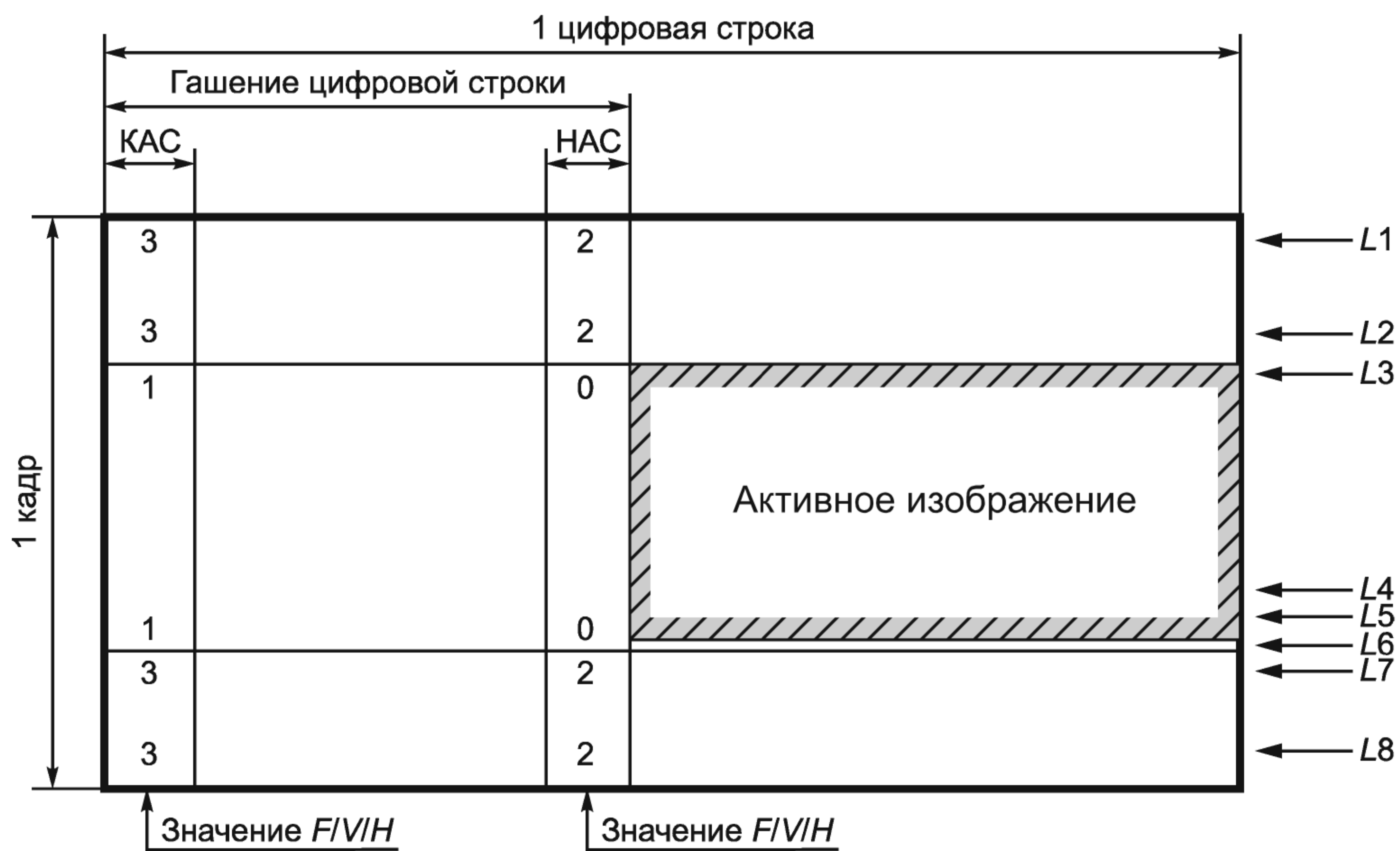
Рисунок 8 — Эталонные коды синхронизации видеосигнала КАС и НАС на интервале времени передачи кадра для систем с построчным разложением
