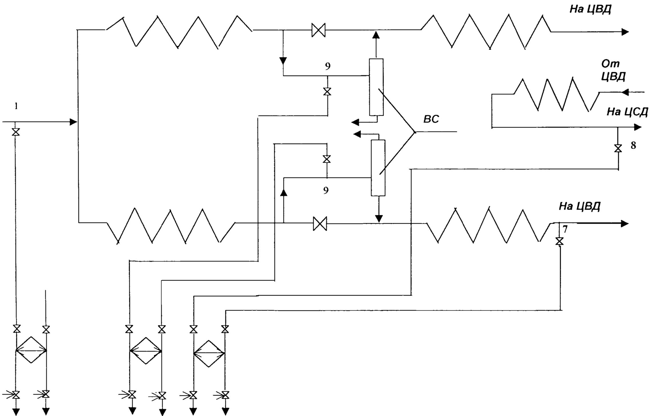
Рисунок 14. Схема отборов проб пара и воды прямого котла
