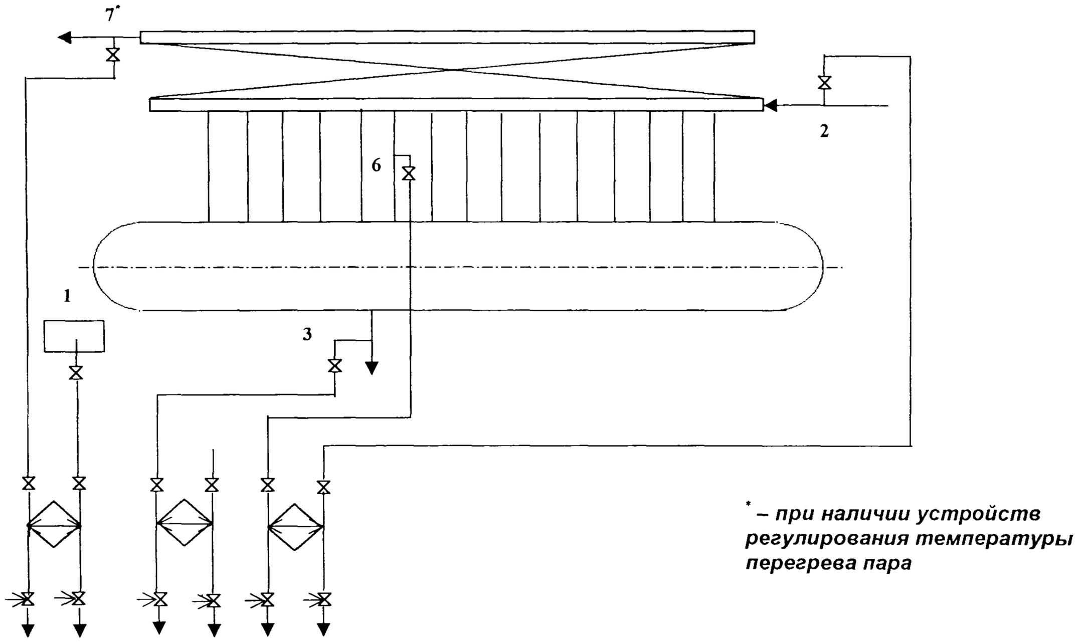
**Рисунок 16. Схема отборов проб пара и воды барабанных котлов среднего и низкого давления с одноступенчатым испарением**
