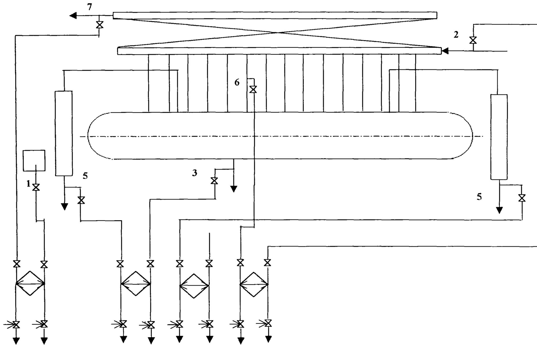
**Рисунок 12. Схема отборов проб пара и воды барабанных котлов с давлением 9,8 МПа (100 кгс/см<sup>2</sup>) и более с двухступенчатым испарением (вторая ступень испарения- выносные циклоны)**
