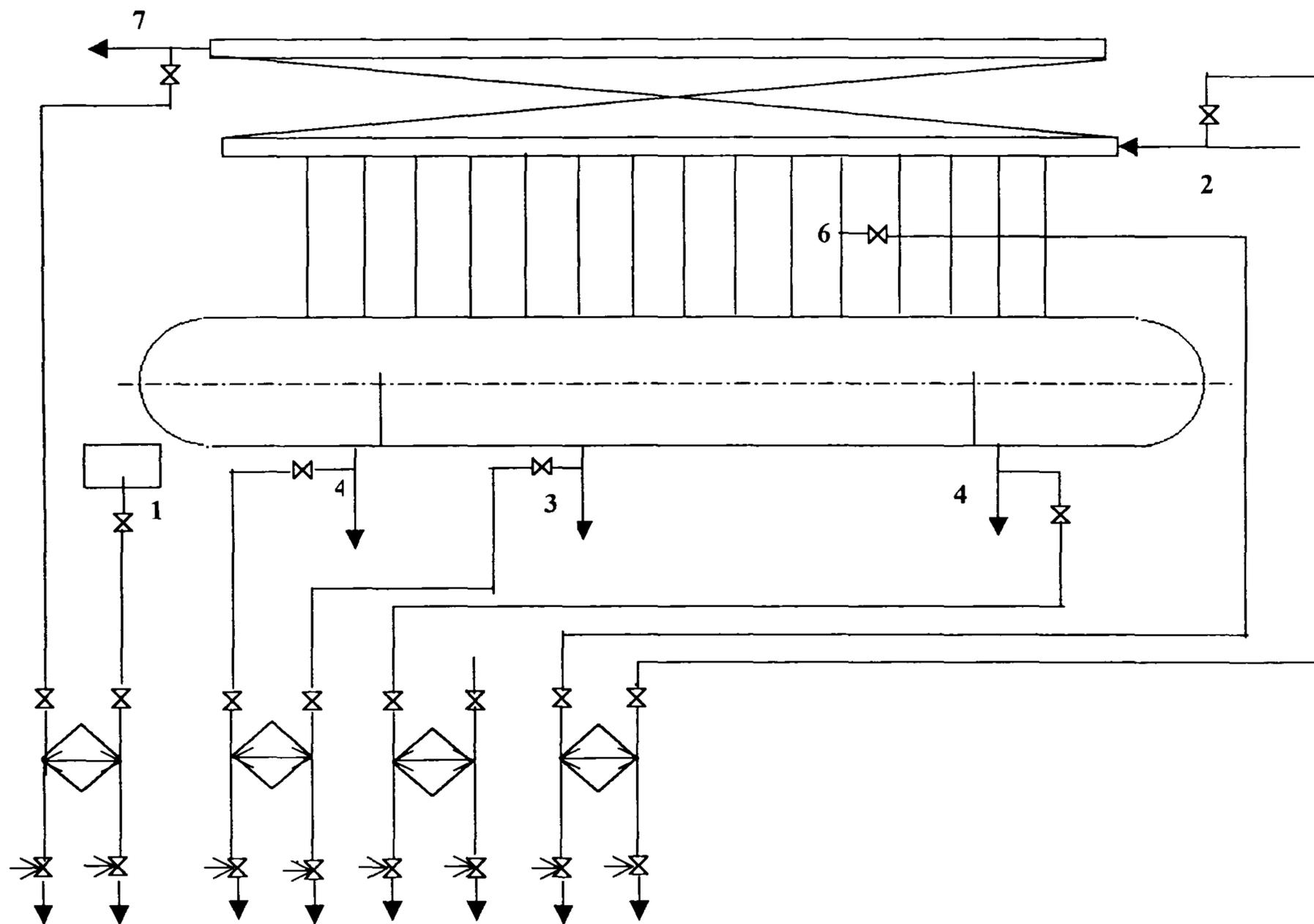
**Рисунок 11. Схема отборов проб пара и воды барабанных котлов с давлением 9,8 МПа (100 кгс/см<sup>2</sup>) и более с двухступенчатым испарением (вторая ступень испарения- внутрибарабанная)**
