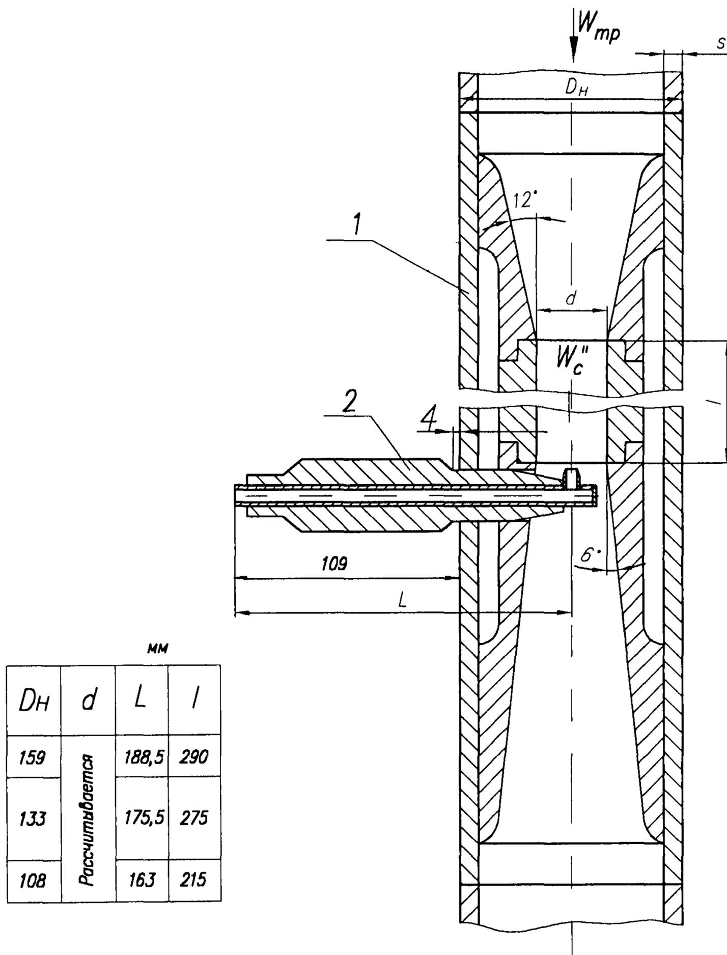
Рисунок 6. Зонд со смесителем-трубой Вентури
