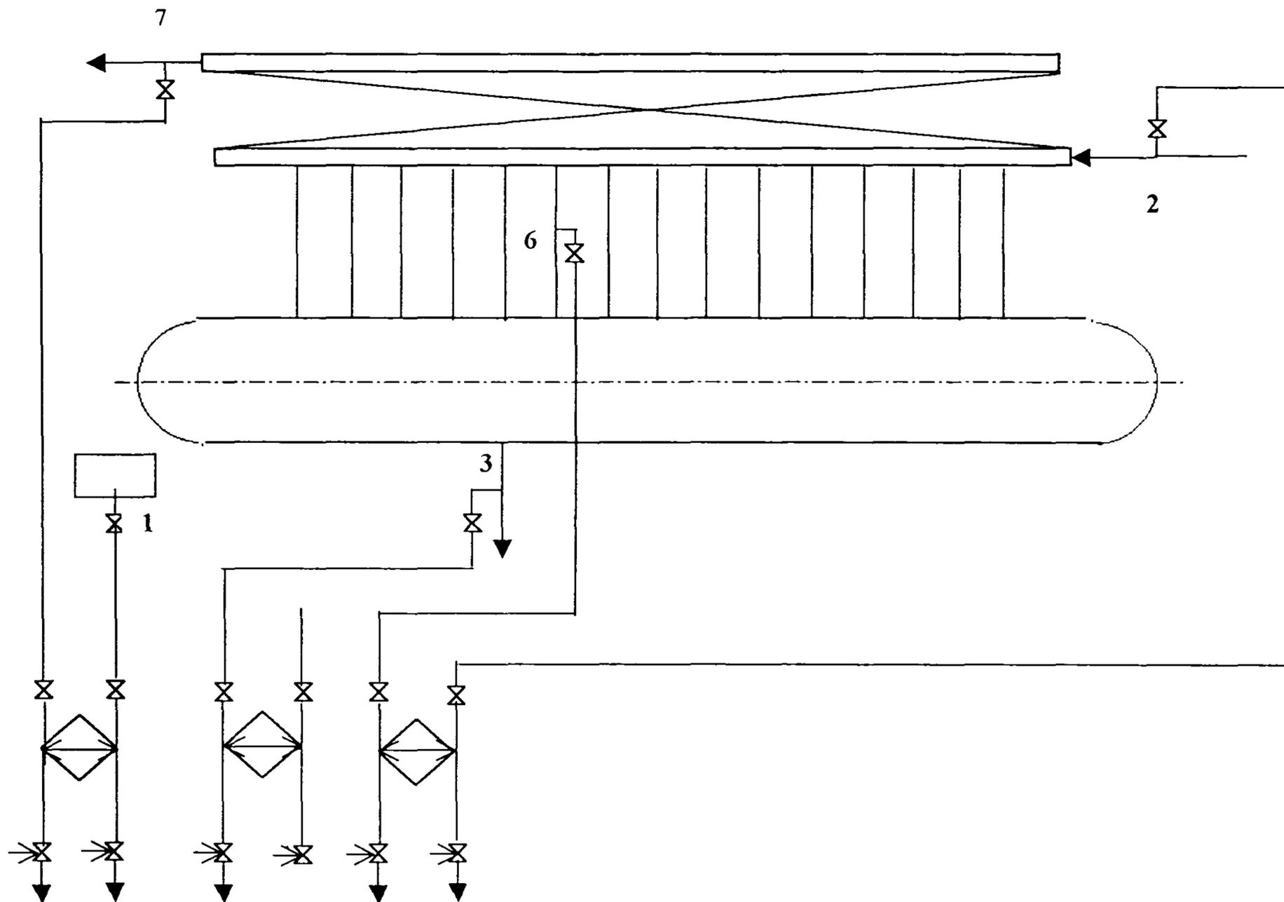
Рисунок 10. Схема отборов проб пара и воды барабанных котлов с давлением 9,8 МПа (100 кгс/см<sup>2</sup>) и более с одноступенчатым испарением
