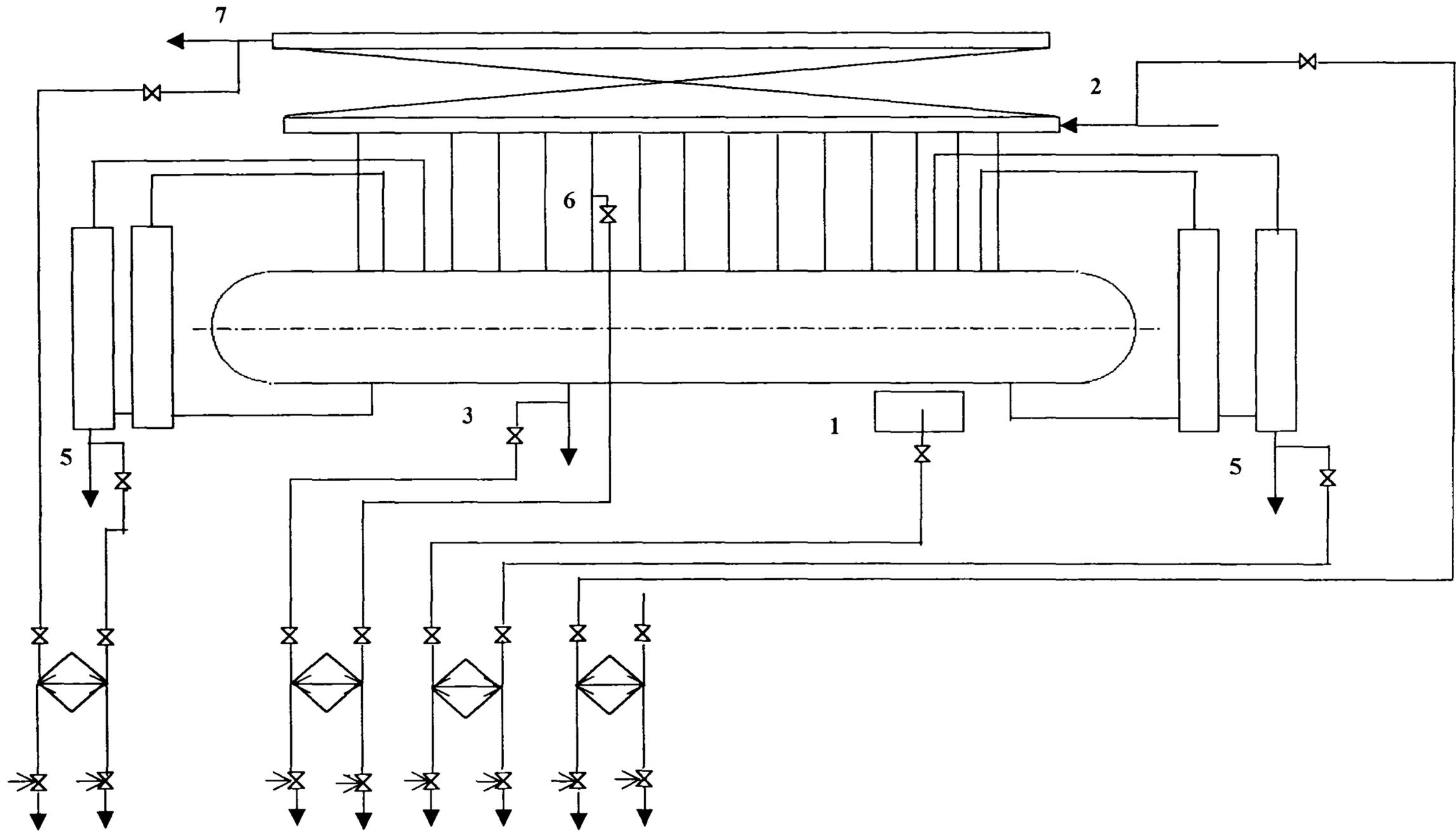
**Рисунок 13. Схема отборов проб пара и воды барабанных котлов с давлением 9,8 МПа (100 кгс/см<sup>2</sup>) и более с двухступенчатым испарением (вторая ступень испарения- 2 выносных циклона, соединенных последовательно и подключенных на одну панель экрана)**
