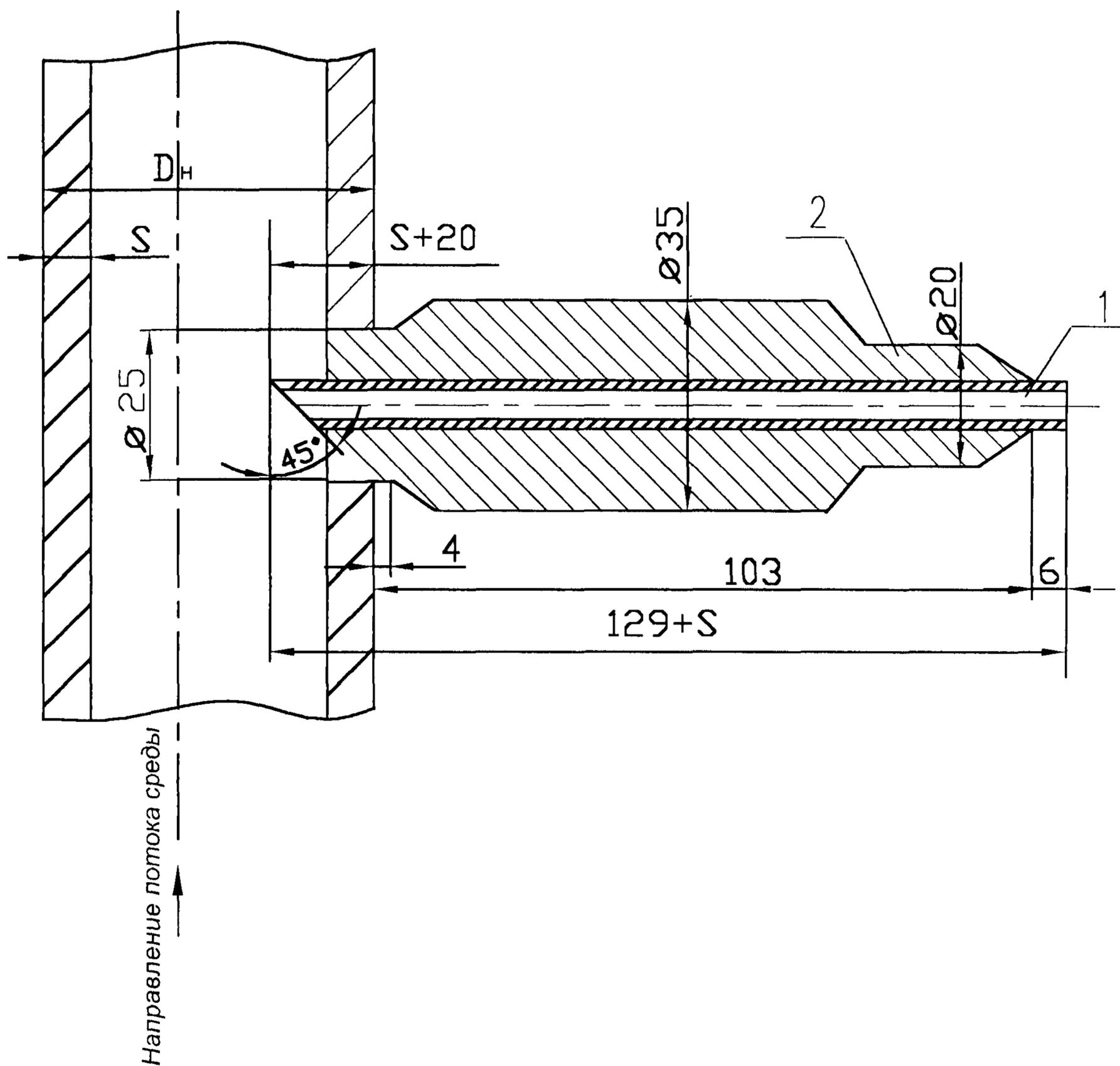
Рисунок 1. Зонд трубчатый
