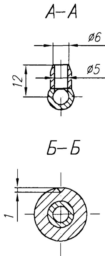
**Рисунок 5. Зонд однососковый**
