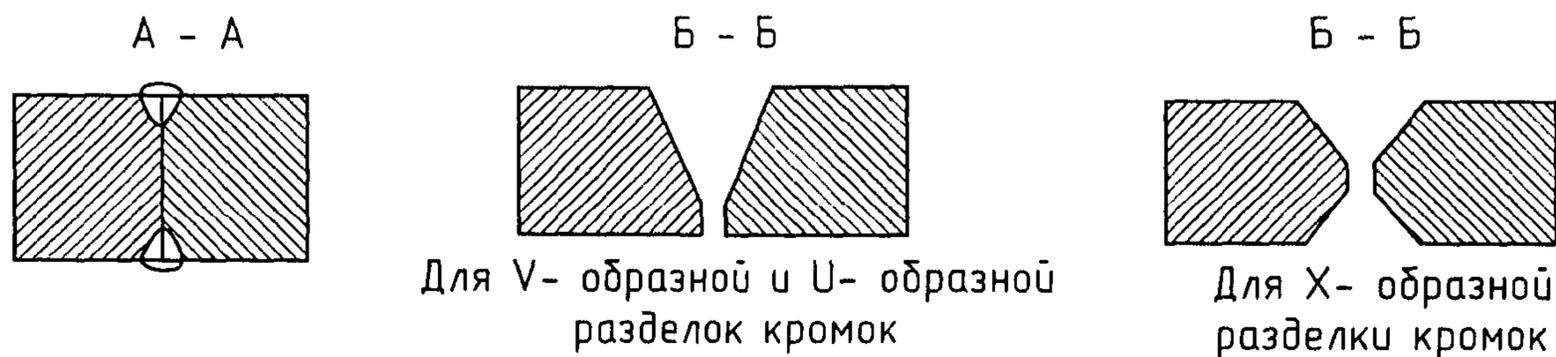
Для строганных по периметру обечаек на привариваемых к обечайке планках (образце-свидетеле) снять фаску газовым резаком
