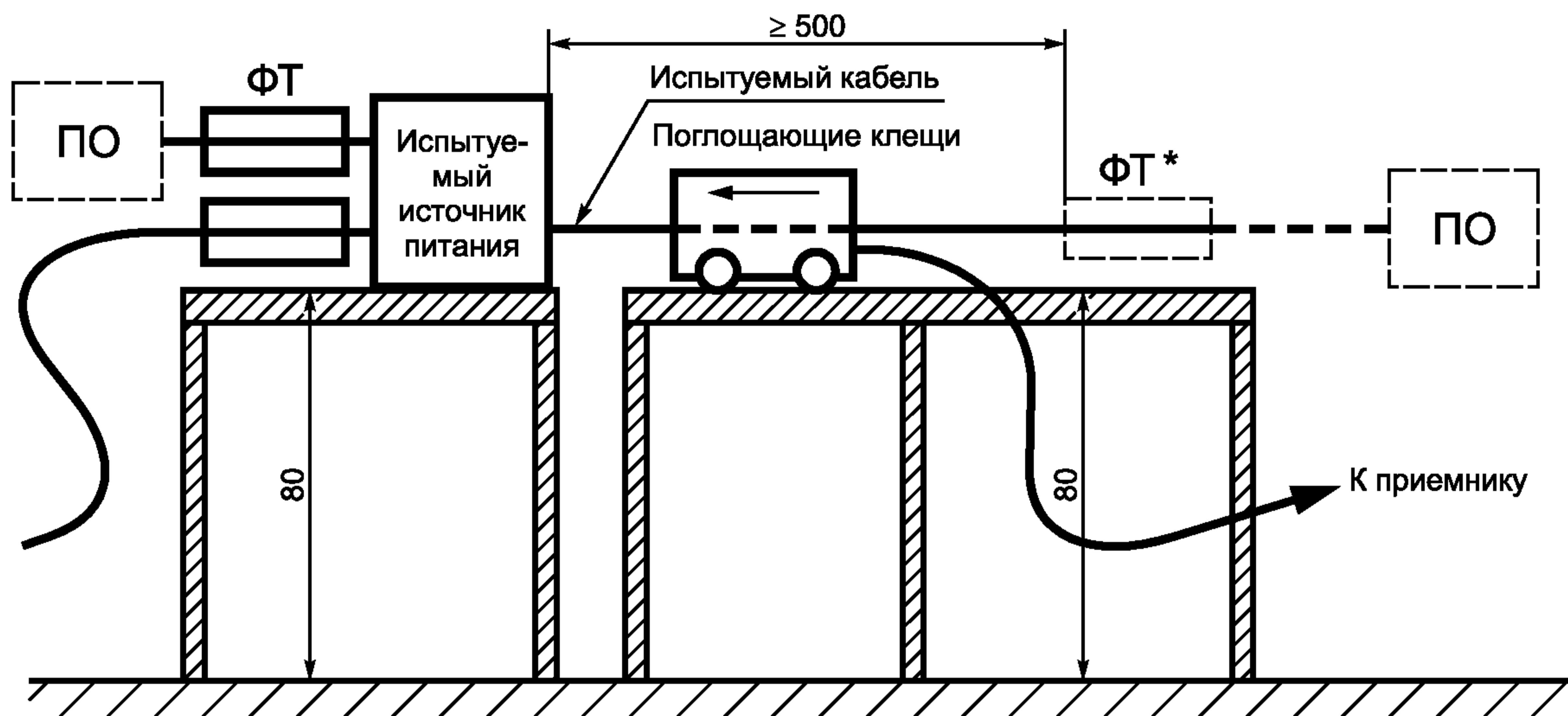
ПО — подключаемое оборудование; ФТ — ферритовая трубка, аналогичная применяемой в поглощающих клемцах; ФТ\* — дополнительная ферритовая трубка, аналогичная применяемой в поглощающих клемцах, для дополнительной развязки
