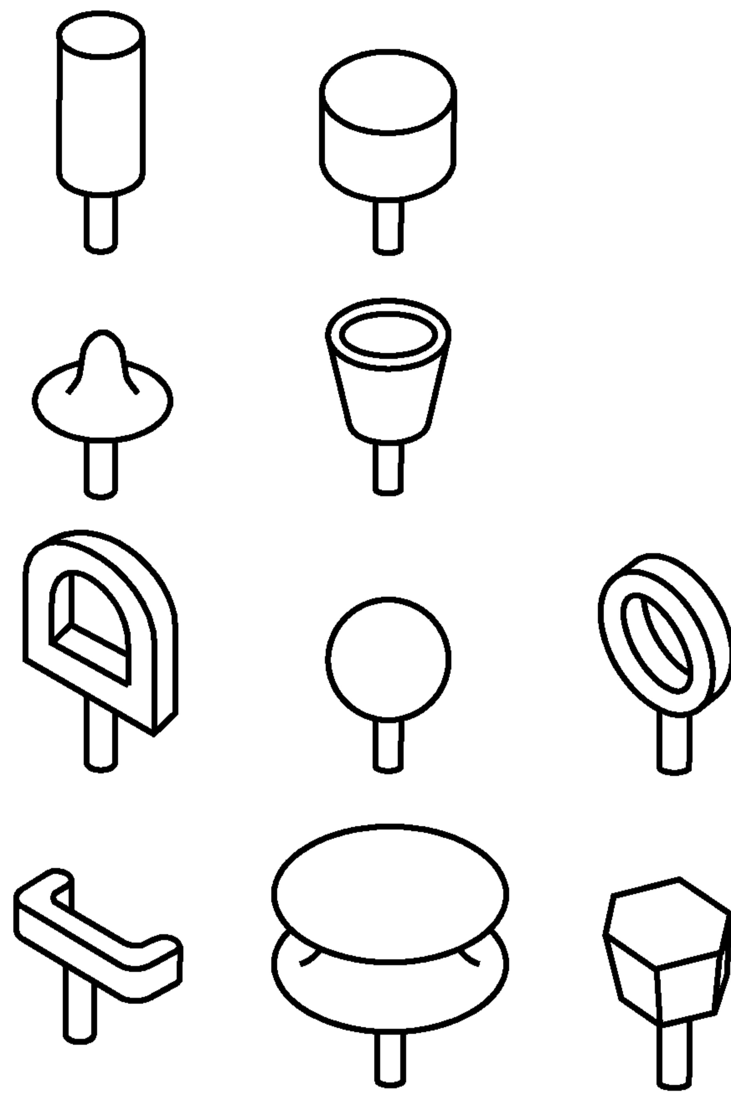
Рисунок 8 — Примеры осязательно различимых форм
