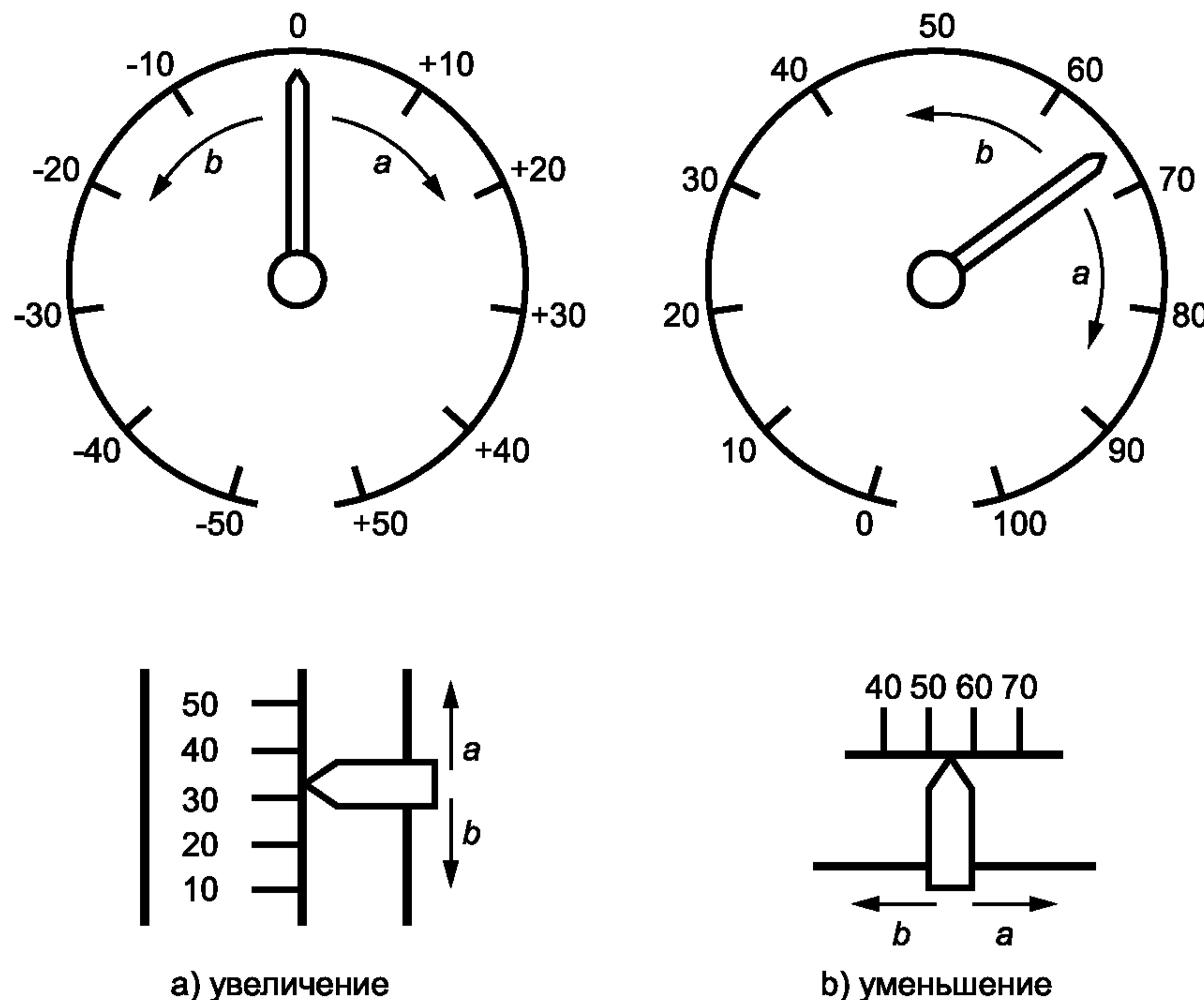
Рисунок 4 — Возможные направления перемещения указателя
