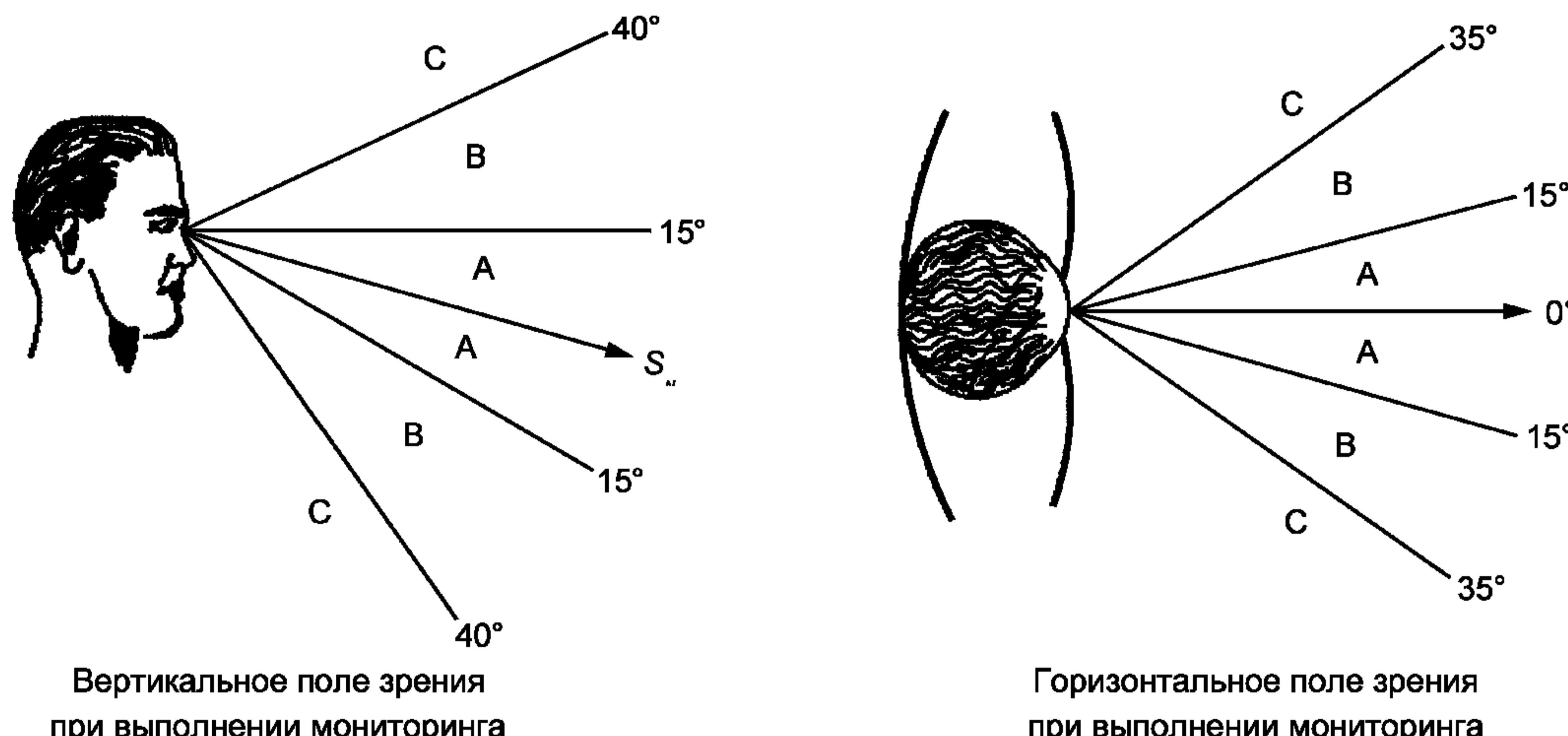
Рисунок 2 — Зоны эффективности распознавания сигнала в задаче мониторинга
